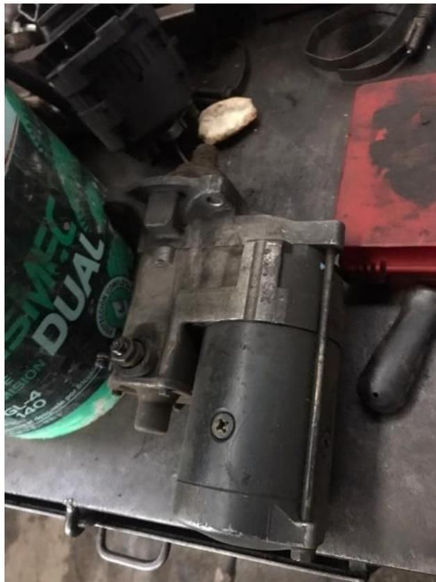
Figura 73. Reparación de arrancador AMS – 07
