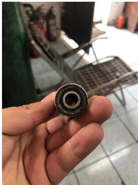
Figura 76. *Mal prensado de manguera AMS – 08*
