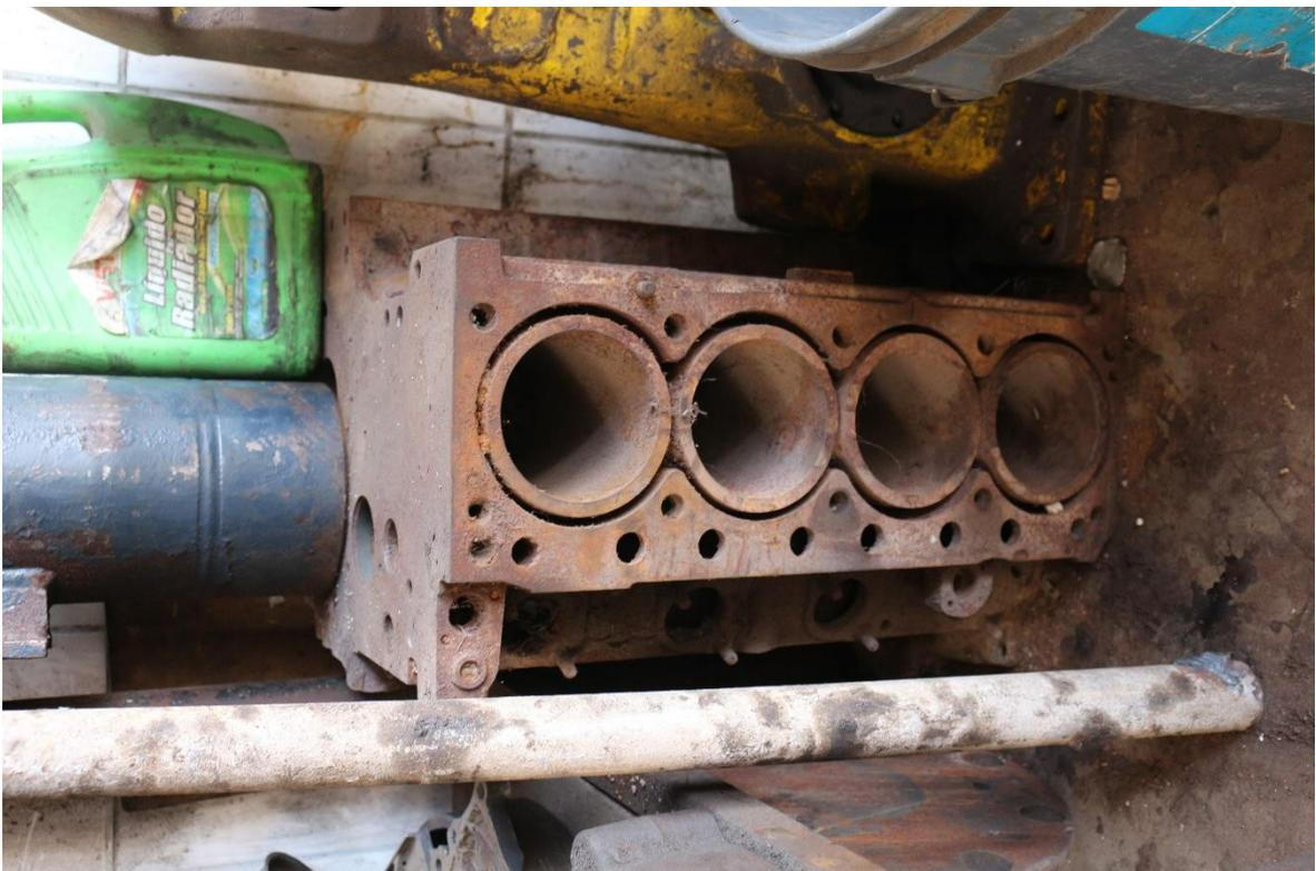
Figura 69. Consecuencia de la falta de mantenimiento.
