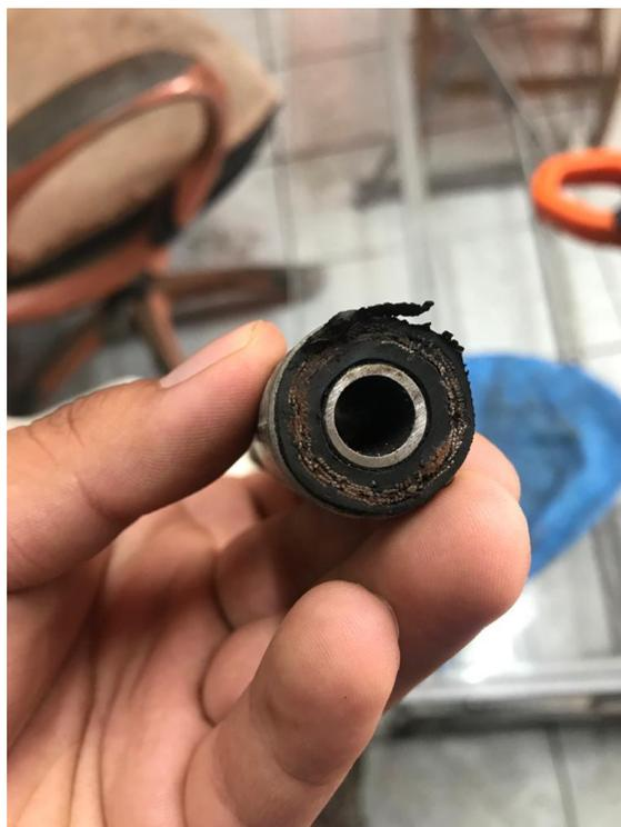
Figura 75. *Mal prensado de manguera AMS – 09*
