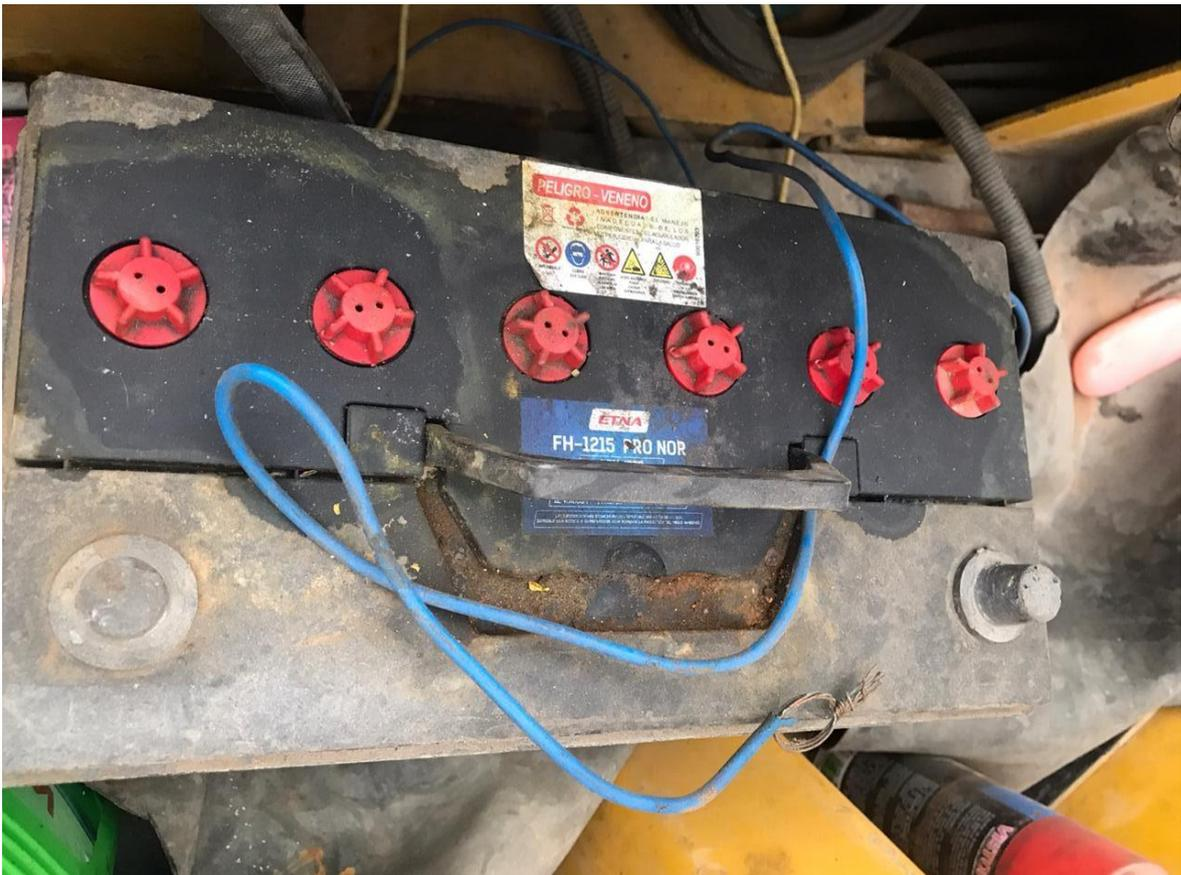
Figura 52. Baterías en mal estado.
