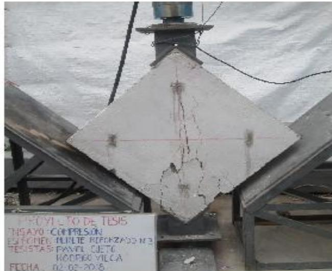
FIGURA 4.67.- Falla del murete de albañilería reforzado
