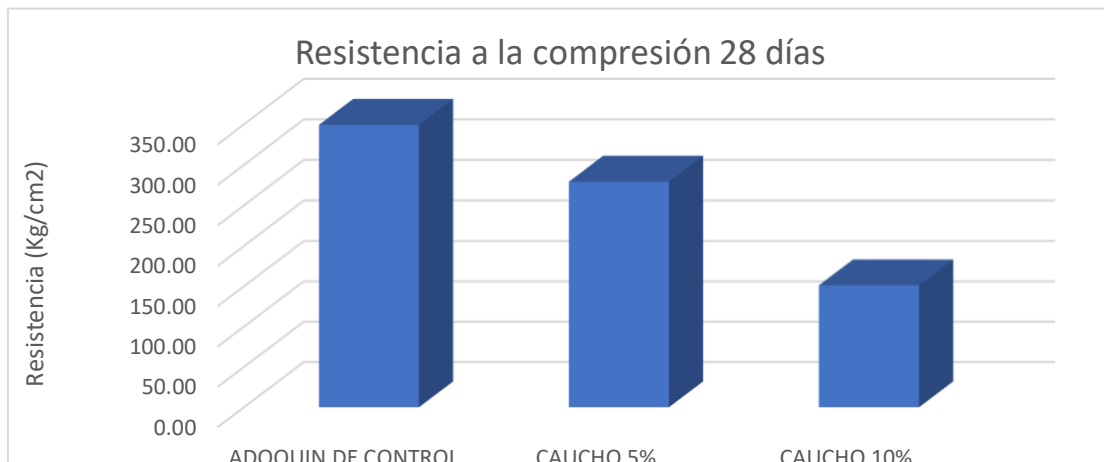
Gráfico 9. Resistencia a la compresión
