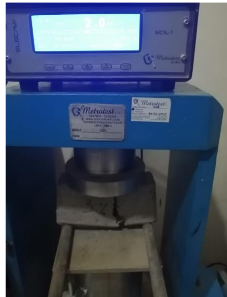
Imagen 12. Muestra sometida a ensayo a flexión
