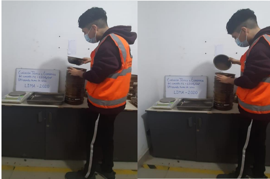
Figura 05. Realizando ensayo de granulometría.
