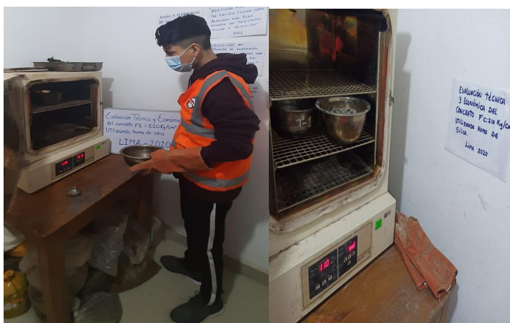
Figura 06: Realizando el ensayo de absorción.
