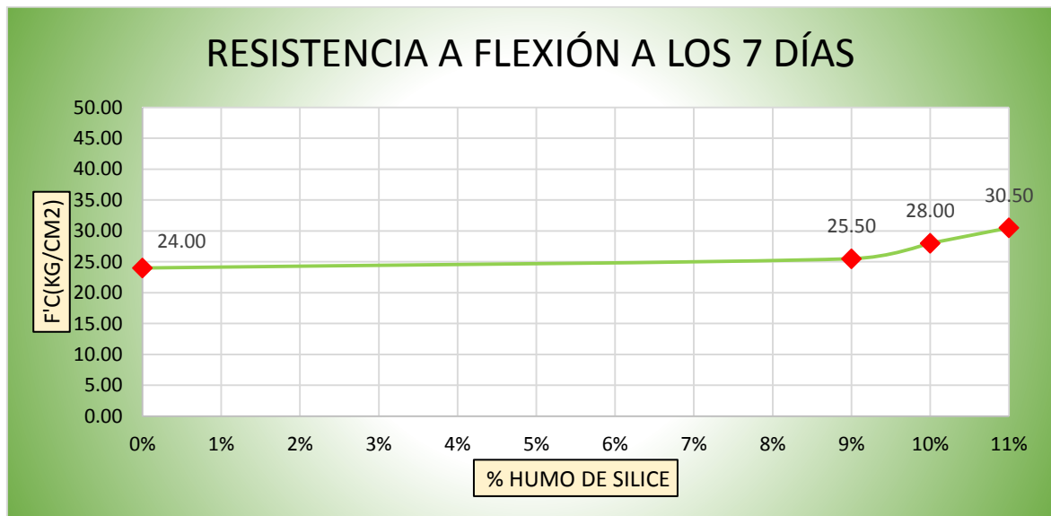
Figura 26. Curva de comparación de las resistencias a flexión a los 7 días.
