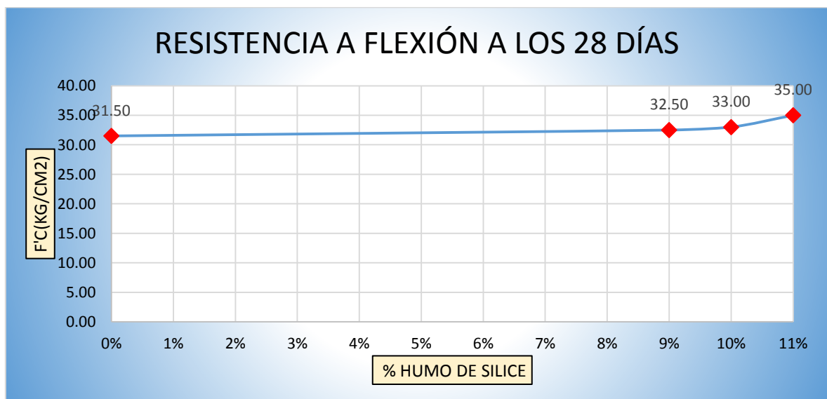
Figura 30 Curva de comparación de las resistencias a flexión a los 28 días.
