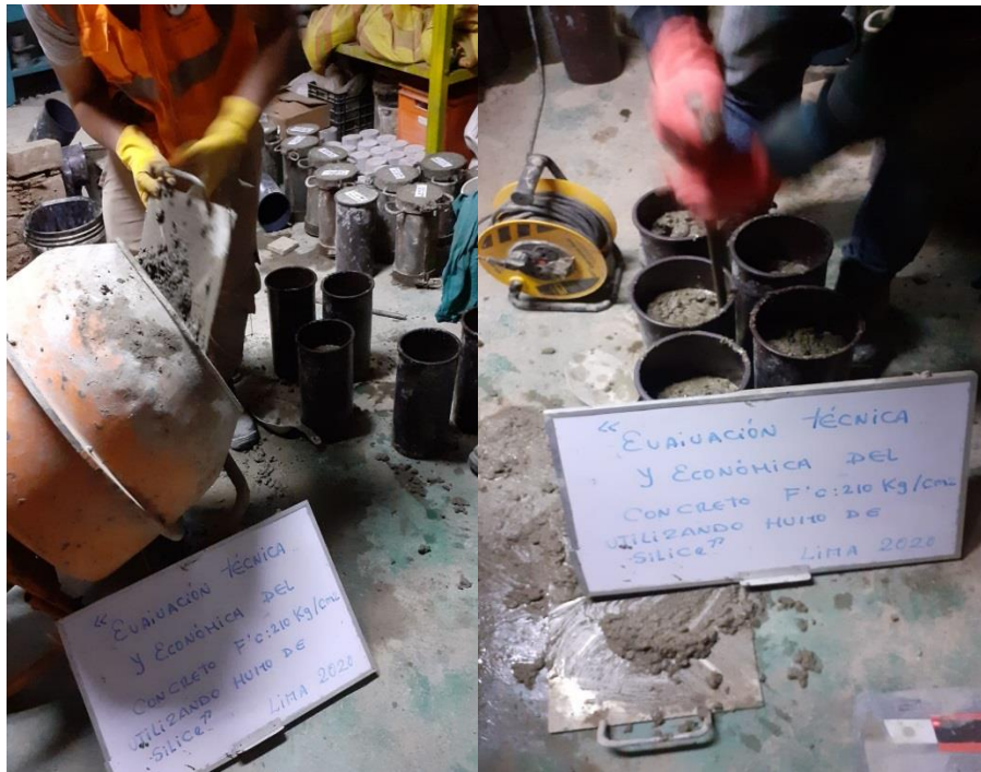
Figura 10. Elaboración de probetas.
