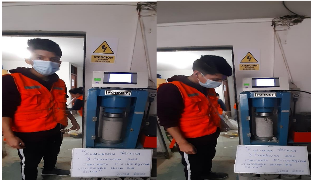
Figura 14. Ensayo a compresión de probetas.
