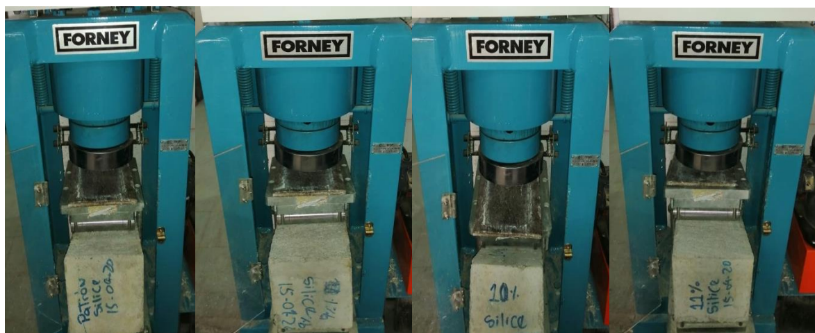
Figura 16. Ensayo a flexión de vigas de cada porcentaje.
