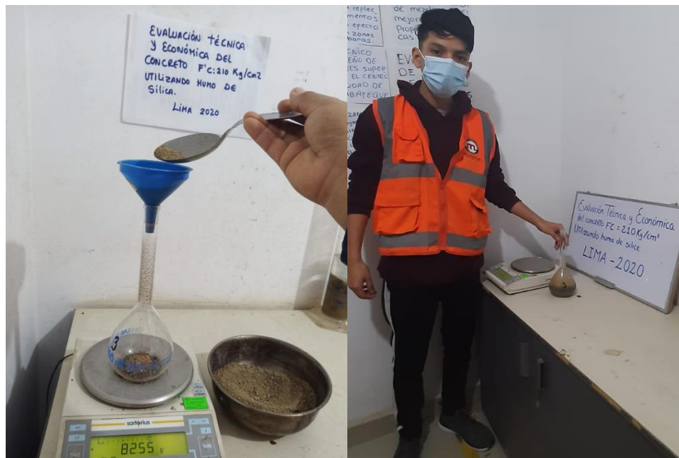
Figura 07. Realizando el ensayo de absorción y peso específico.
