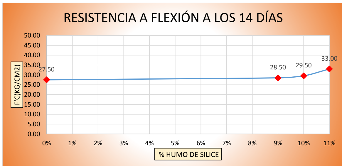
Figura 28 Curva de comparación de las resistencias a flexión a los 14 días.
