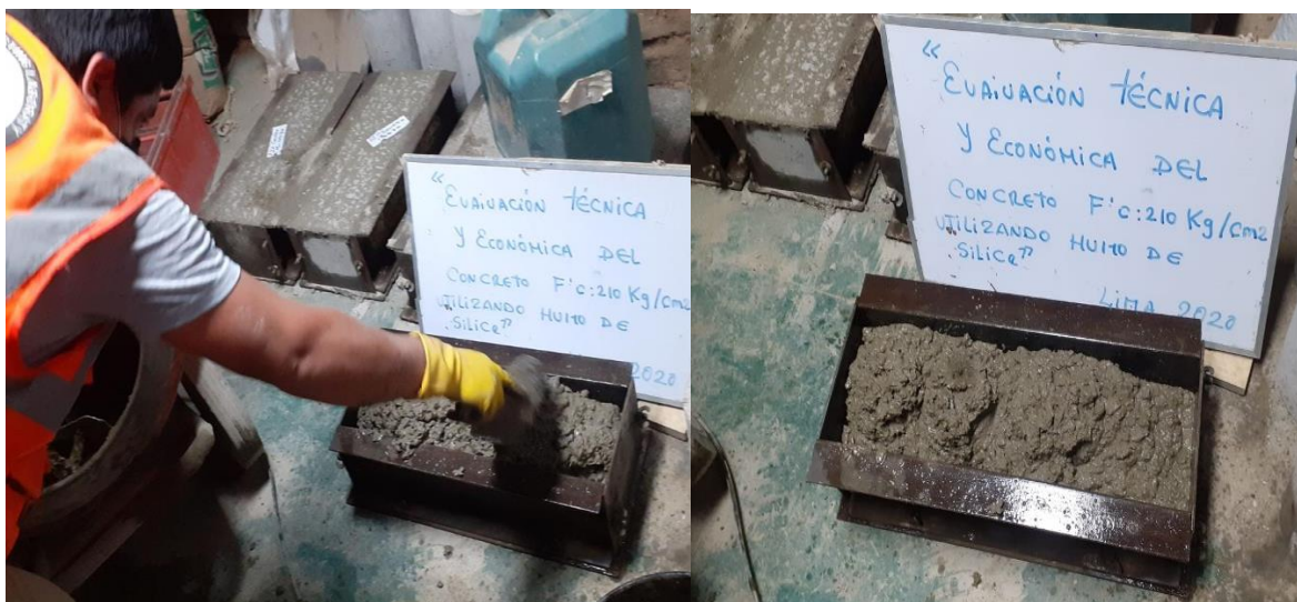
Figura 11. Elaboración de vigas.
