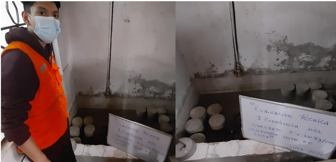
Figura 13. Curado de probetas.
