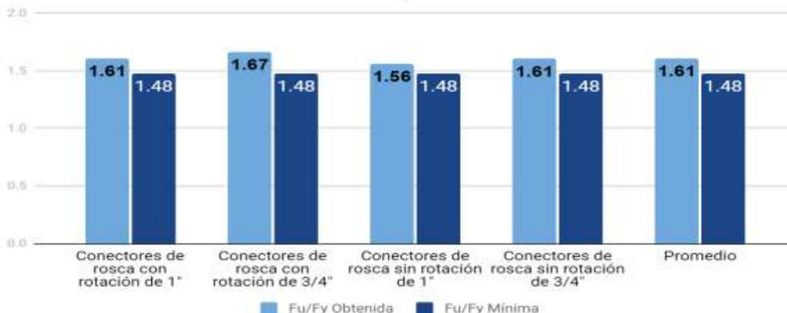
**Gráfico 17:** Resumen del desarrollo de las probetas empalmadas con conectores mecánicos Tipo 2 sometidas a esfuerzos de tracción en la máquina de ensayo uniaxial TOKYOKOKI SEIZOSHO.
