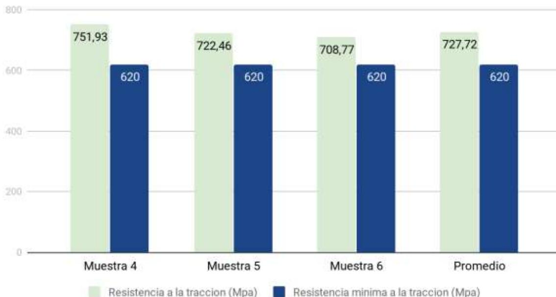
**Gráfico 6:** Resistencia a la tracción con conectores de rosca con rotación con aceros de 3/4''.
