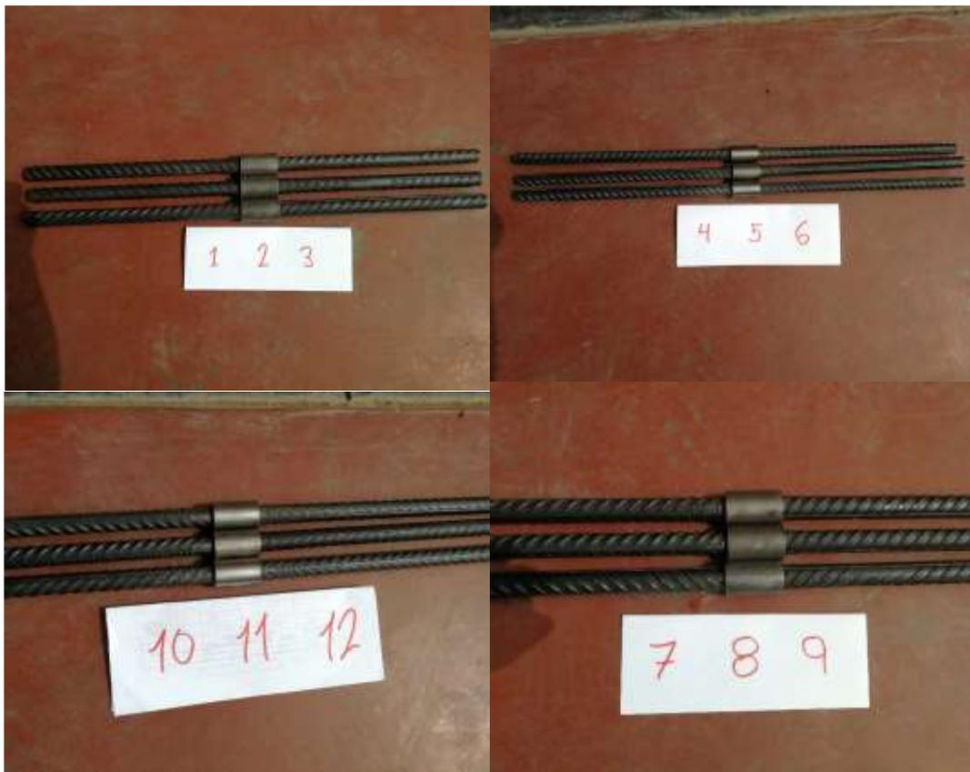
**Figura 19:** Enroscado y ensamblado de conectores con los aceros de grado 60 de  $\frac{3}{4}$  '' y 1''.
