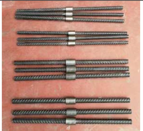
*Probetas correctamente ensambladas y listas para ensayar.*
