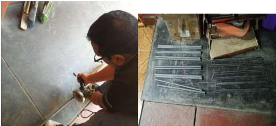
**Figura 18:** *Elaboración de las probetas con corte de 40 cm cada muestra.*
