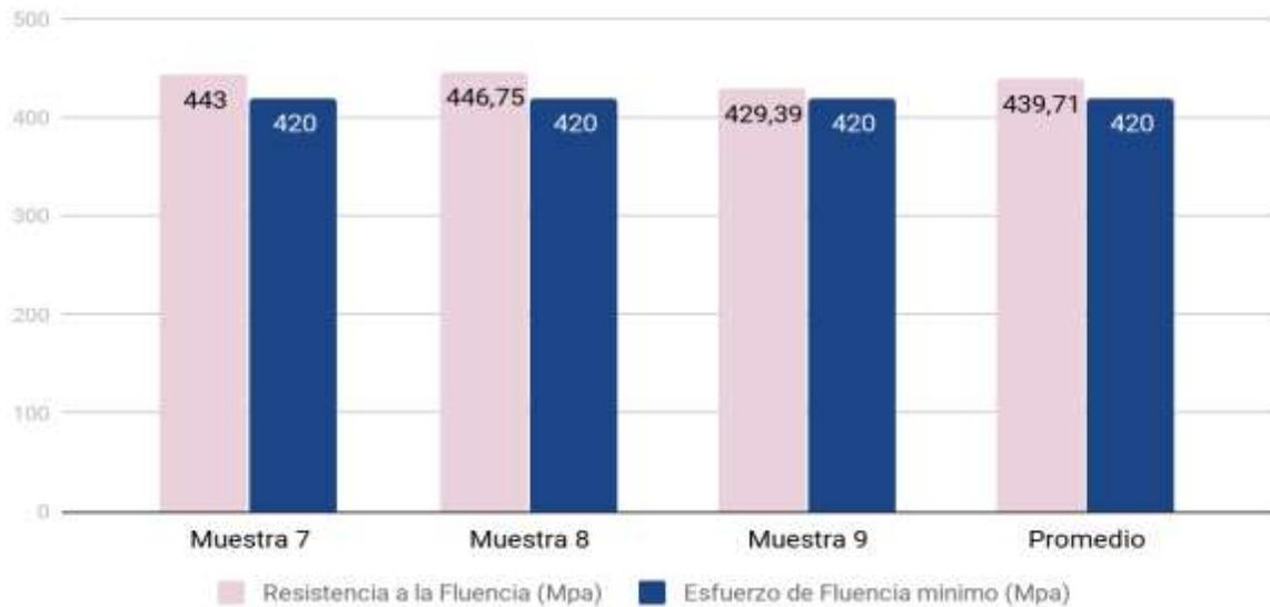
**Gráfico 3:** Resistencia a la fluencia con conectores de rosca sin rotación con aceros de 1''.
