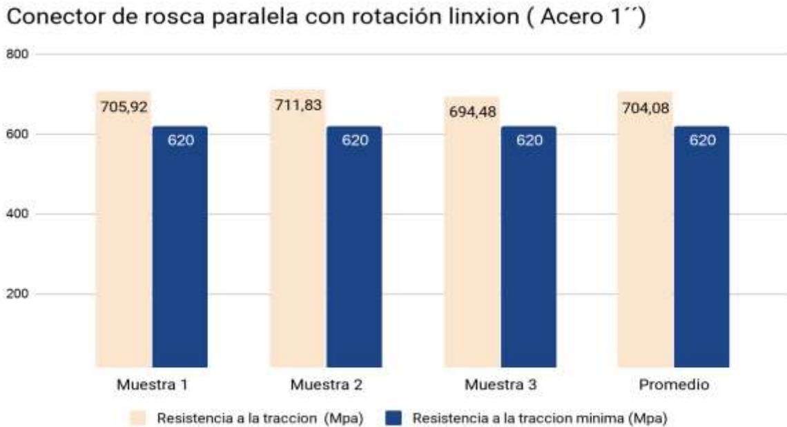
**Gráfico 5:** Resistencia a la tracción con conectores de rosca con rotación con aceros de 1''.
