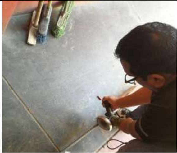
*Cortado de acero con amoladora para elaboración de probetas.*
