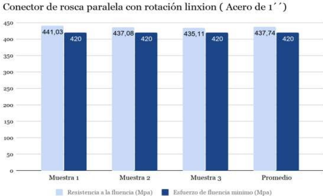
**Gráfico 1:** Resistencia a la fluencia con conectores de rosca con rotación con aceros de 1''.
