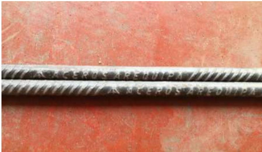
**Figura 17:** Adquisición de aceros grado 60 ASTM A615.
