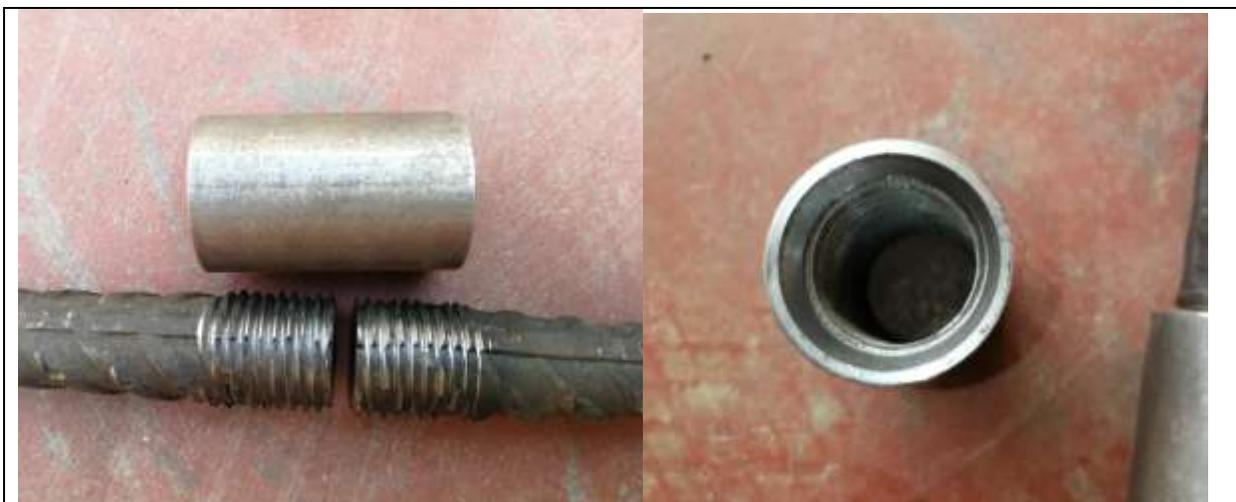
*Comprobación del estado del roscado en varillas con conectores mecánicos con rotación.*
