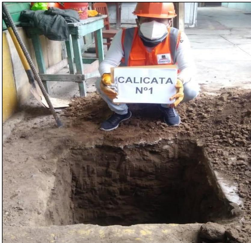
Se alcanzó la profundidad de 2.5 m, donde se encontró un estrato de Arena Limosa, con contenido de humedad bajo, no se encontró presencia del nivel freático.
