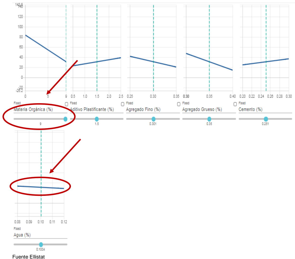
Figura 34. Disminución de la resistencia por interacción de agua y materia orgánica
