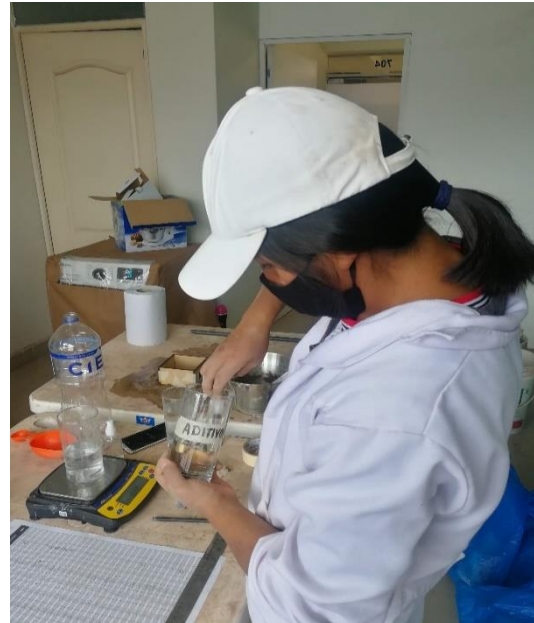
Figura 16. Se dosifica el aditivo plastificante
