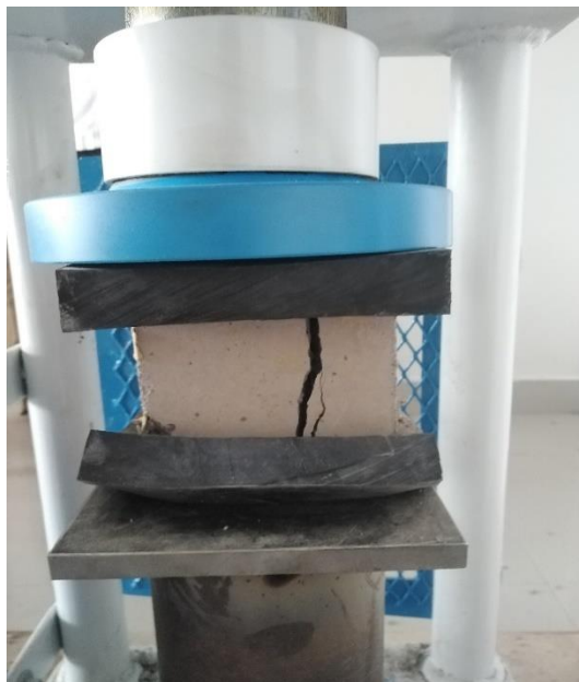
Figura 26. Falla del espécimen después del ensayo simple a la compresión.
