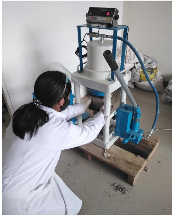
Figura 23. Seguidamente se realizó el ensayo simple a la compresión
