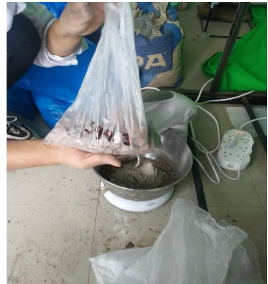
Figura 14. Se vierte agregado grueso
