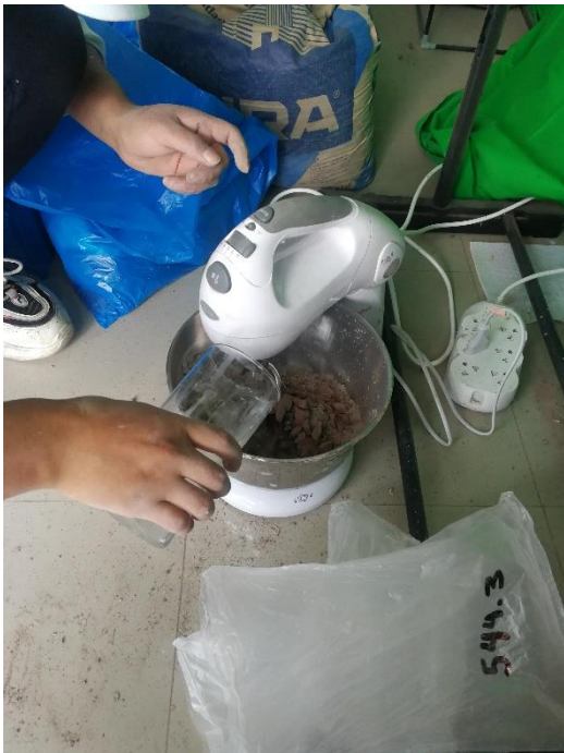
Figura 17. Se agrega el agua junto al aditivo
