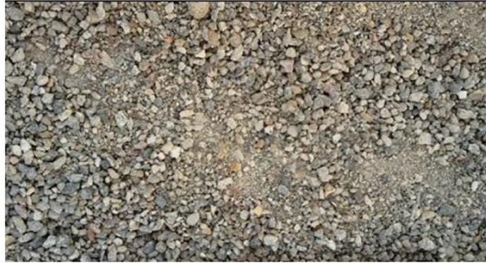
Figura 4. Agregado Grueso Reciclado
