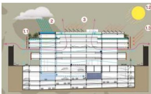
La radiación solar ha sido resuelta mediante un entramado de cerámica translúcida donde permite la entrada de luz directa de iluminación natural.
