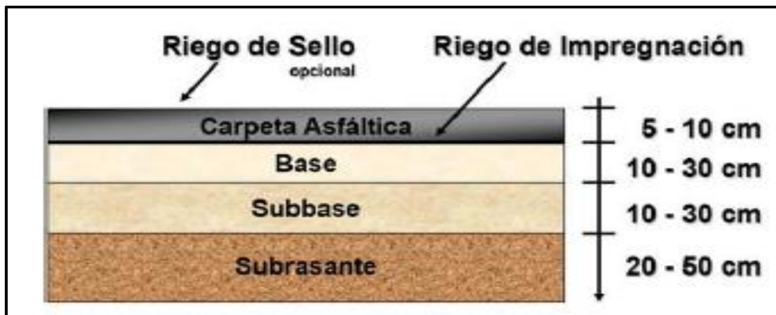
Figura 22: Estructura del pavimento flexible
