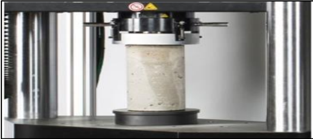
Figura 39: Ensayo de la compresión del concreto
