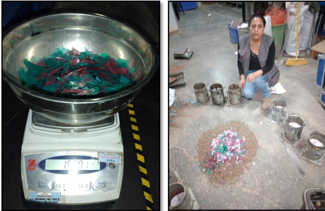
Figura 52: Ensayo CBR al suelo natural con adición de bolsas LDPE
