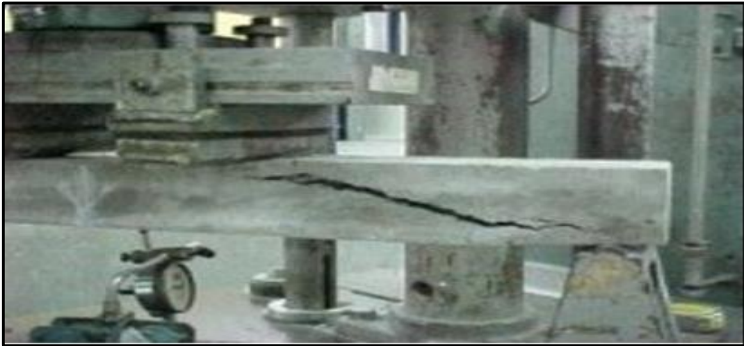
Figura 40: Ensayo a flexión ASTM C890
