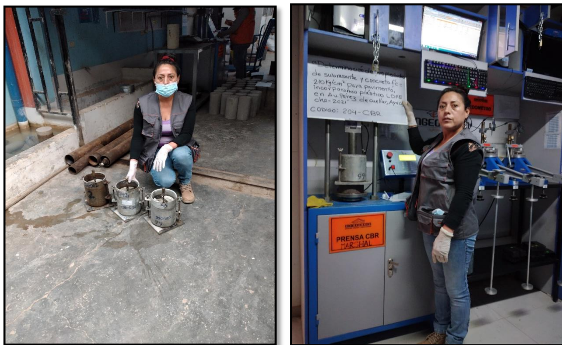
Figura 49: Ensayo CBR al suelo natural
