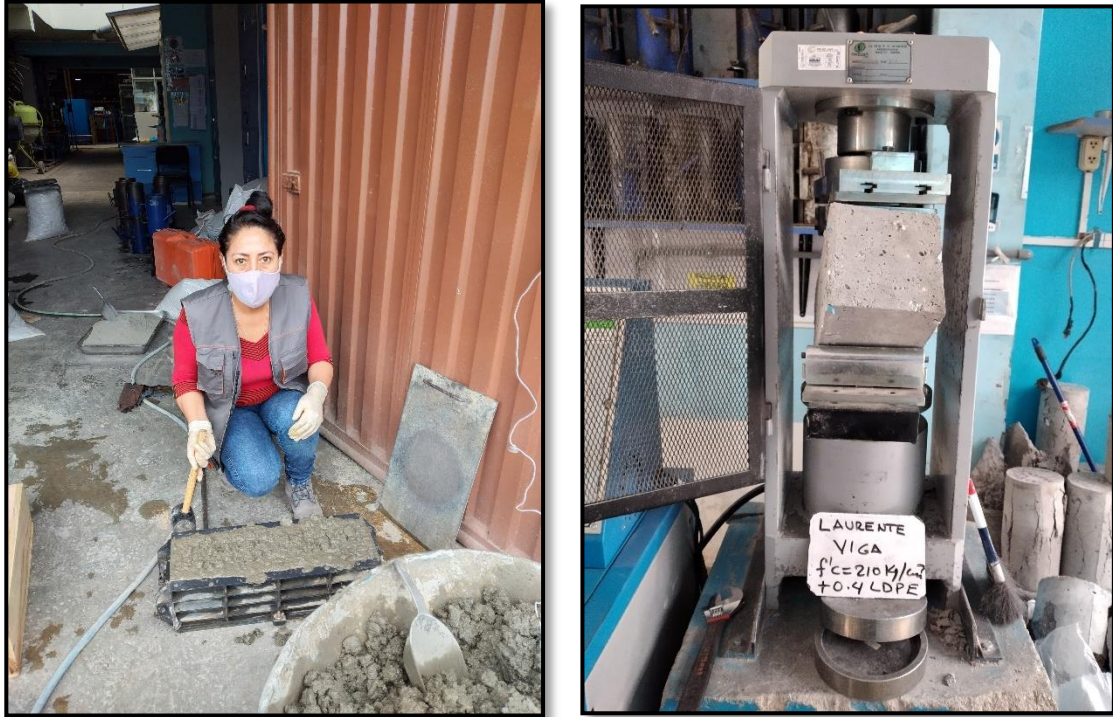
Figura 68: Rotura de testigos de concreto a los 28 días
