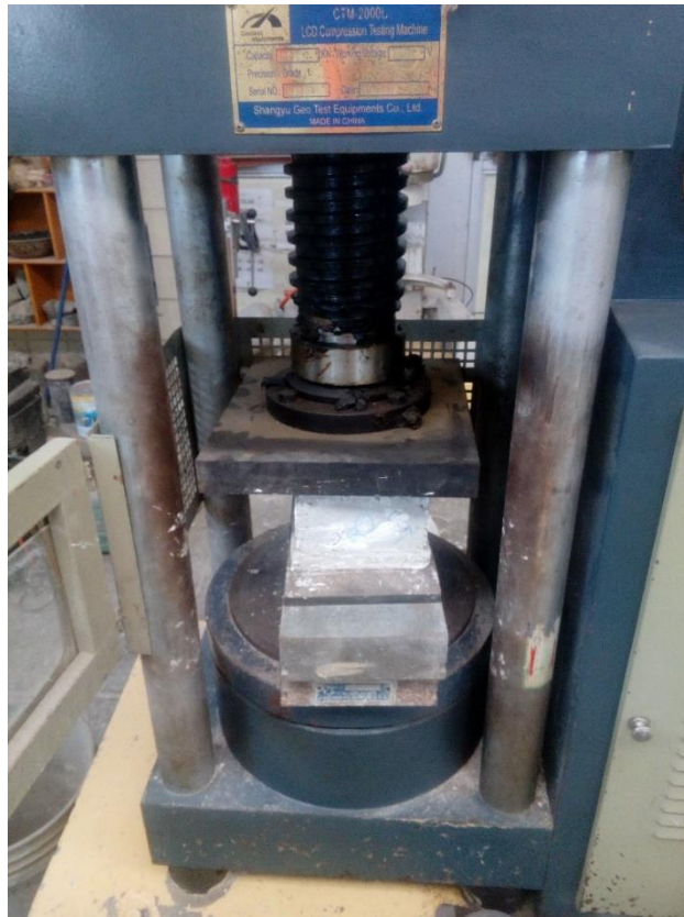
Ensayo a la compresión de los ladrillos elaborados.
