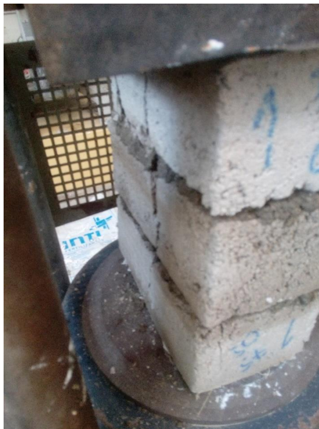
Ensayo a compresión de las pilas de ladrillos.
