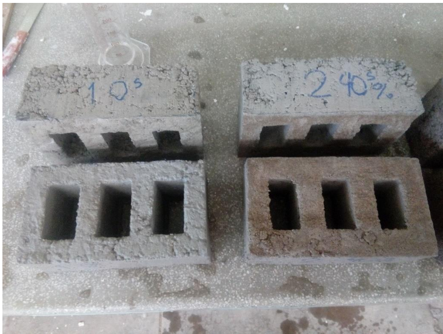
Ladrillos elaborados a base de mortero y codificados para su análisis físico.
