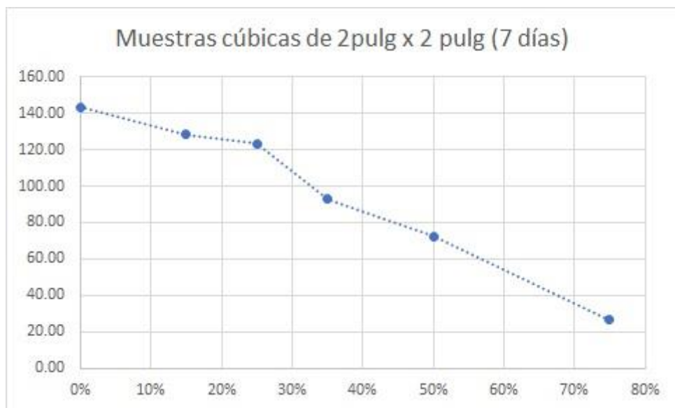
Figura 8. Comparación de los ensayos de la resistencia a la compresión 7 días.
