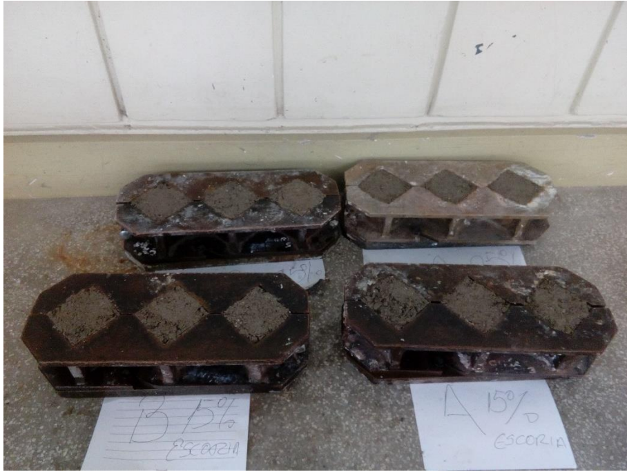
Probetas cubicas de 2 pulgadas de arista
