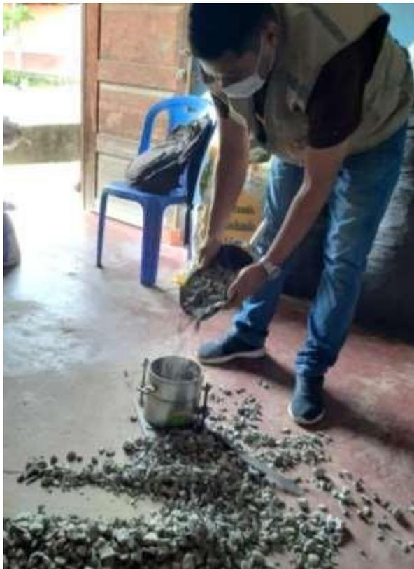
**Figura 11:** Peso unitario suelto del agregado grueso
