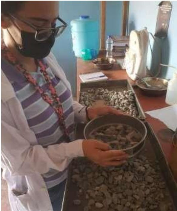
**Figura 7:** Granulometría del agregado grueso
