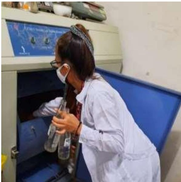
**Figura 15:** Triturado de las botellas de vidrio sódico-cálcico en la máquina de abrasión de los ángeles
