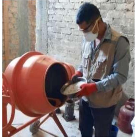
**Figura 22:** Añadiendo el vidrio sódico-cálcico triturado a la mezcla de concreto
