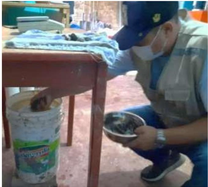
**Figura 10:** Ensayo de peso específico y absorción del agregado grueso
