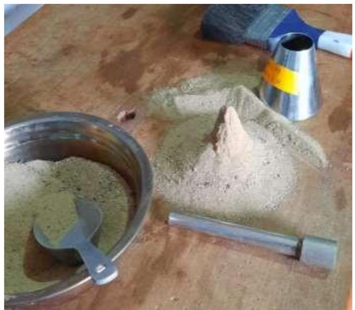
**Figura 4:** Comprobando que el agregado fino alcanzó su humedad óptima
