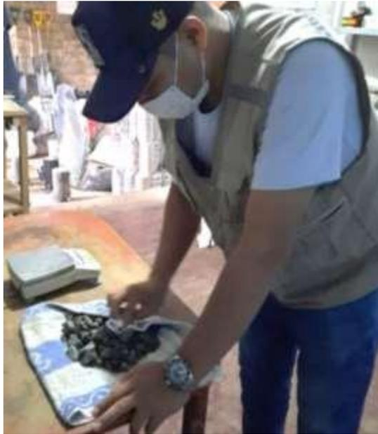
**Figura 9:** Secado superficial del agregado grueso
