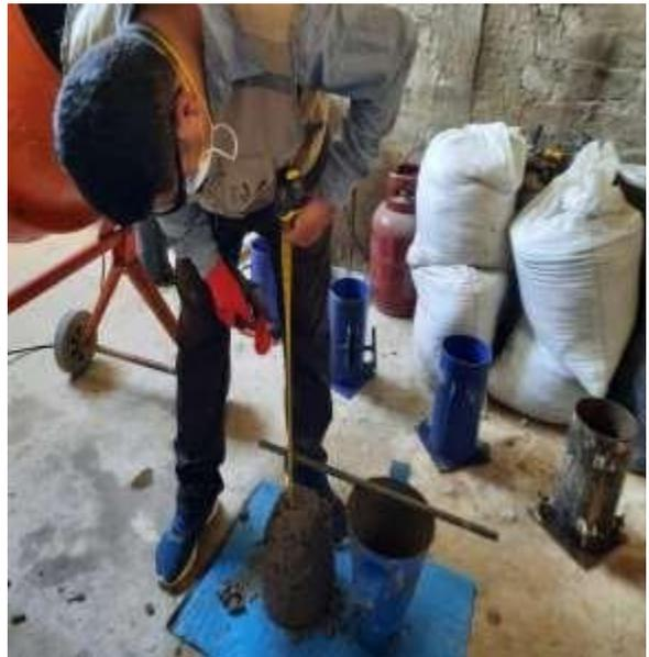
**Figura 24:** Verificando el asentamiento Slump
