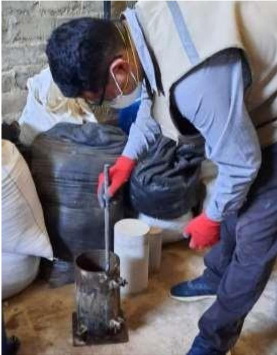
**Figura 25:** Chuseado con la varilla de acero en el moldeado de probetas de concreto
