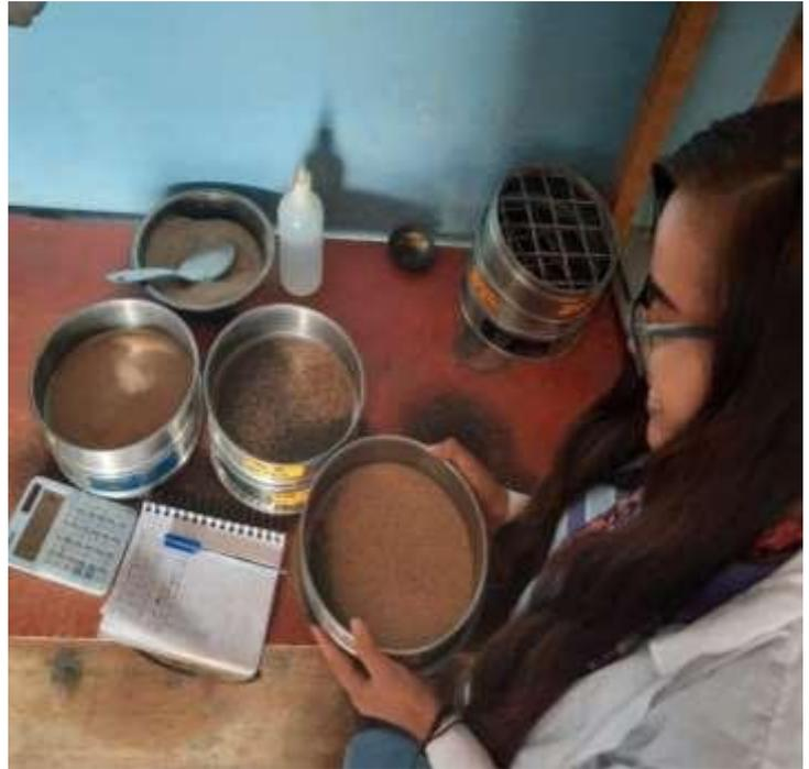
**Figura 2:** Granulometría del agregado fino.
