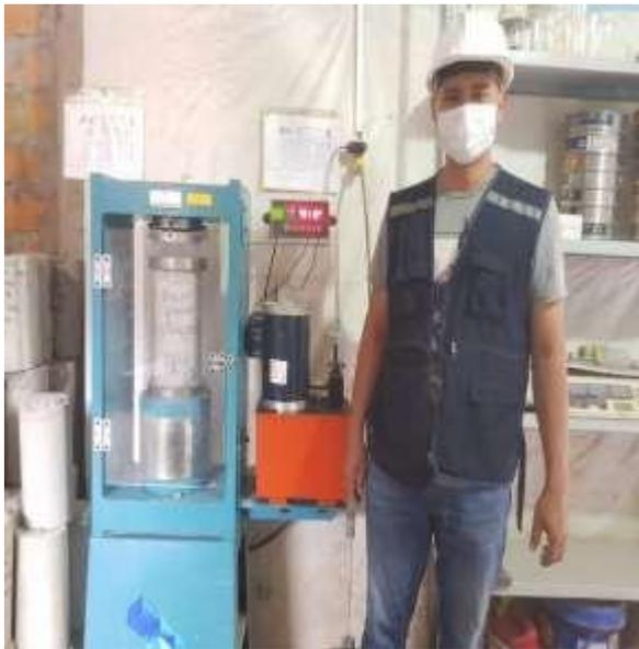
**Figura 27:** Ruptura de probetas a compresión
