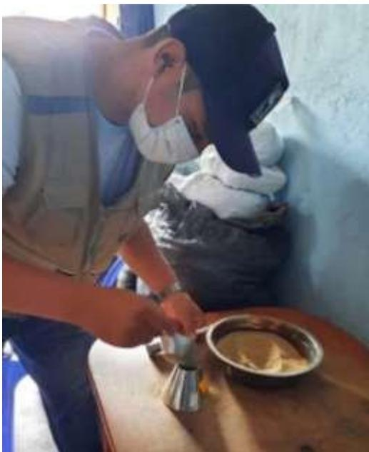
**Figura 3:** Prueba con el cono de arena y el pistón
