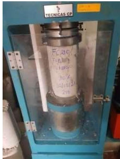
**Figura 28:** Ruptura de probetas a compresión a los 28 días
