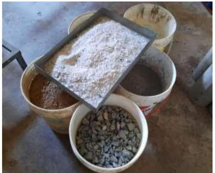
**Figura 20:** Preparando los componentes del concreto para realizar las mezclas.
