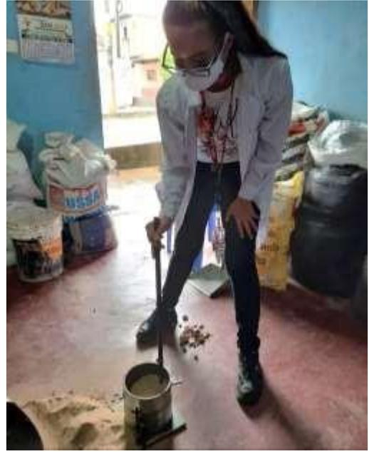
**Figura 6:** Ensayo de peso unitario varillado del agregado fino
