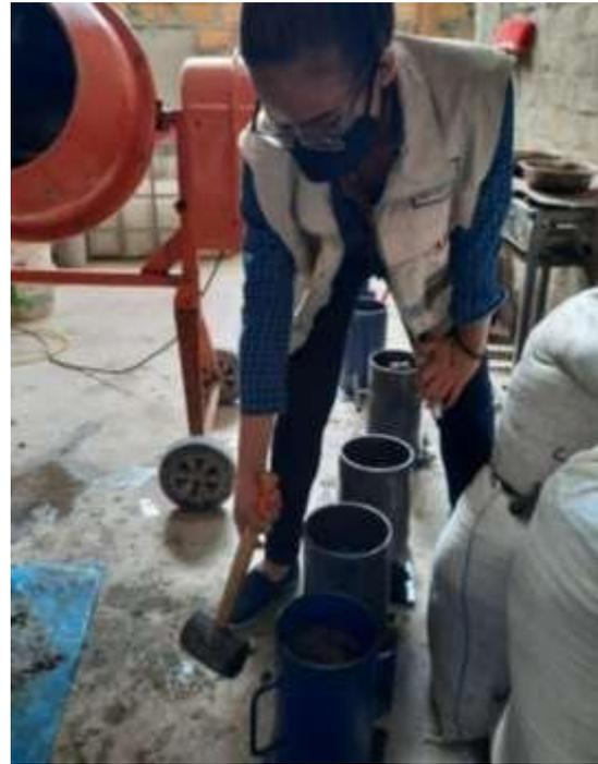
**Figura 26:** Golpeando con el martillo de goma los moldes de concreto durante el proceso de moldeado de probetas
