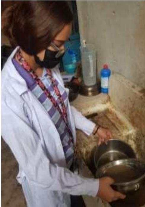
**Figura 1:** Lavado del agregado fino pasando por el tamiz N°200 para eliminar los limos y arcillas
