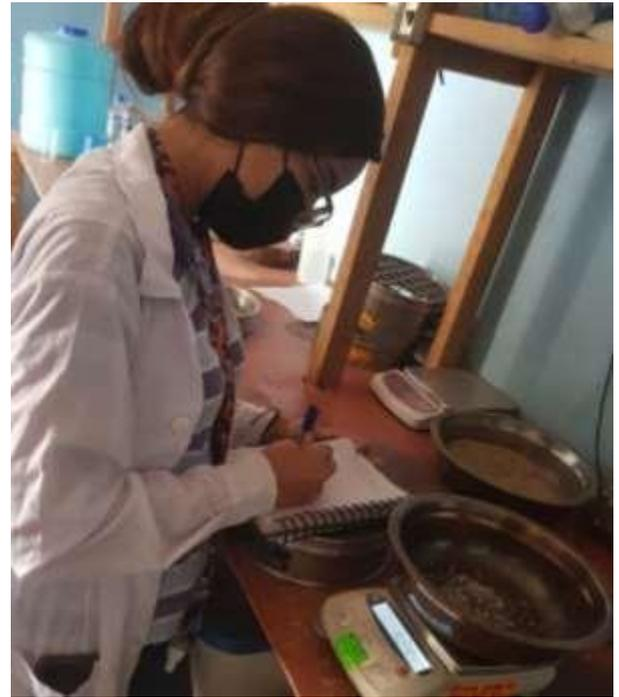
**Figura 8:** Pesando lo que se retenía en cada tamiz de la granulometría del agregado grueso
