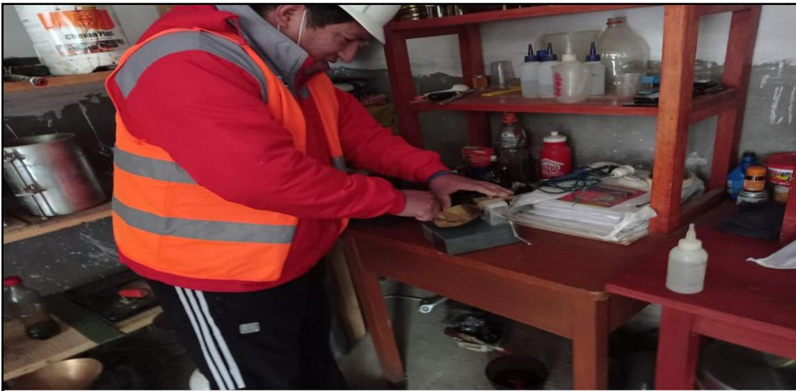
Fig. 53. Realizando ensayos para determinación de límite líquido
