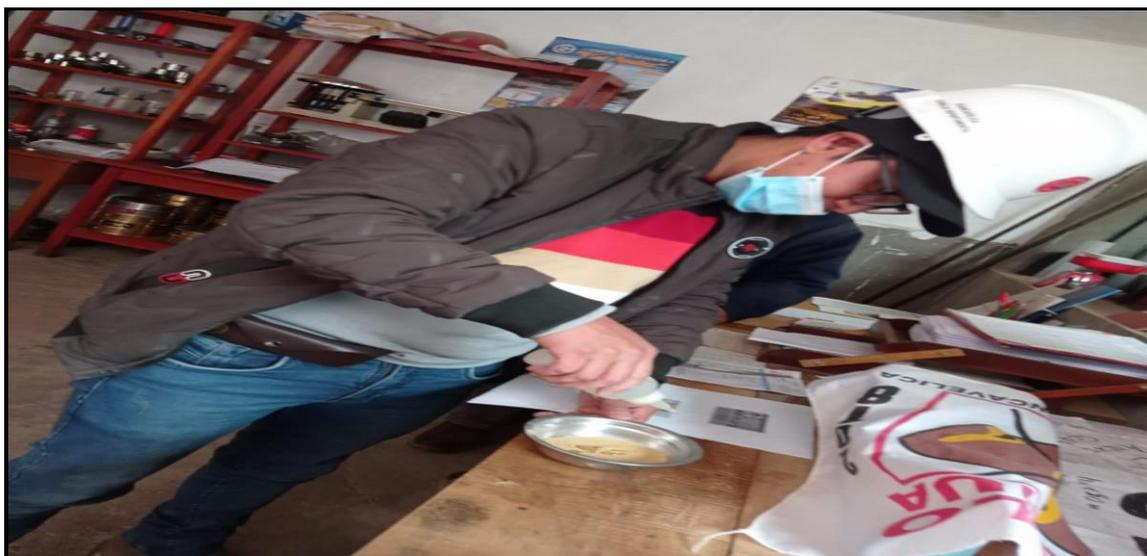
Fig. 54. Ensayos de límites de ATTERBERG Límite Líquido
