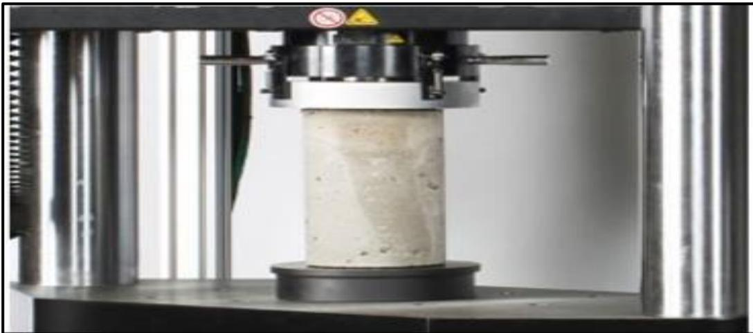
Fig. 39. Ensayo de la compresión del concreto
