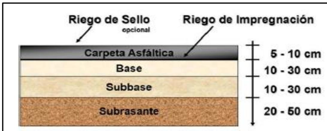
Fig. 22. Estructura del pavimento flexible
