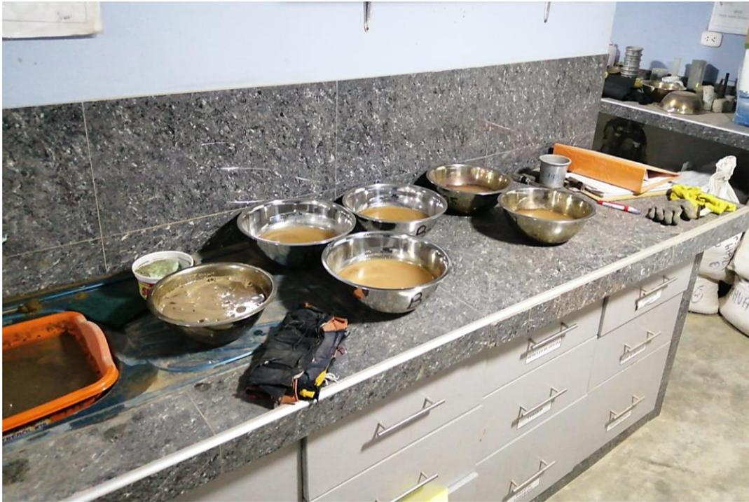
Foto N.º 10 - 11: Secado de agregado fino.
