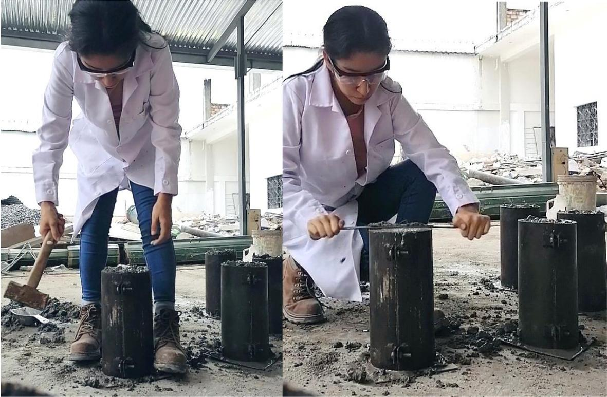
Foto N.º 20: Curado de testigos de concreto convencional y con la respectiva adición de plástico triturado.
