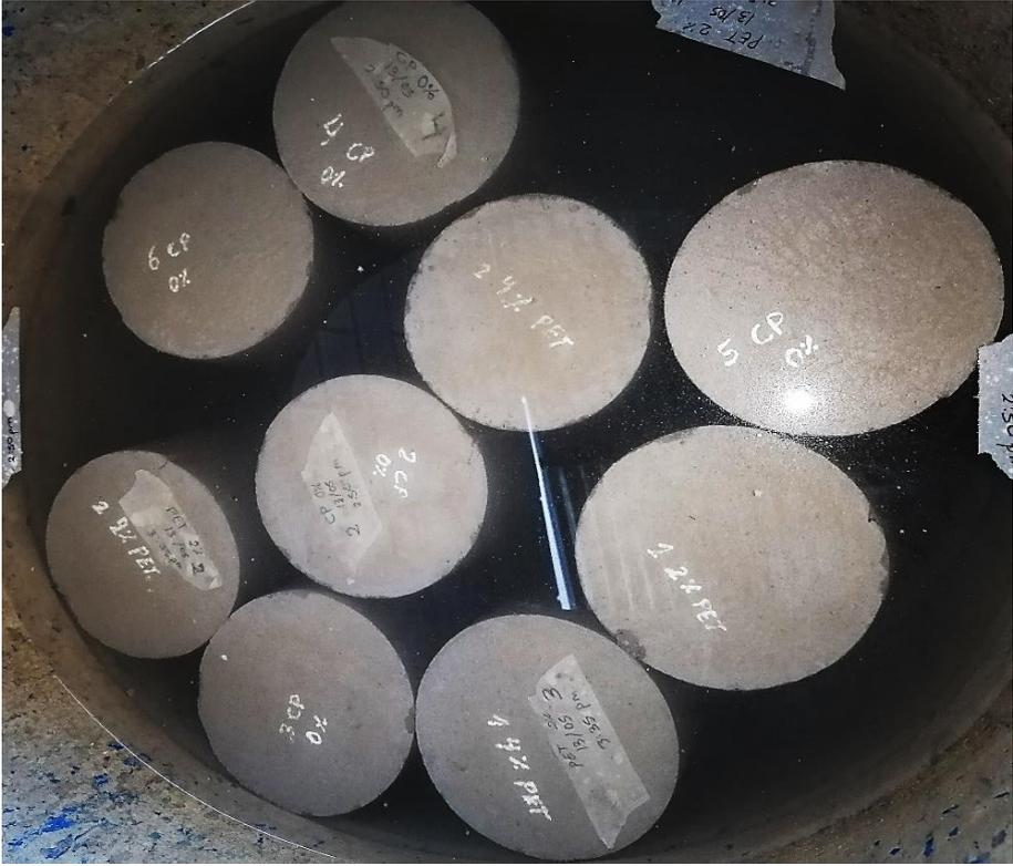
Foto N.º 21: Recolección de datos de testigos en proceso de curado.
