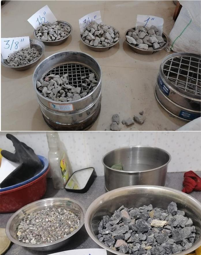
Foto N.º 09: Lavado de muestra de agregados.
