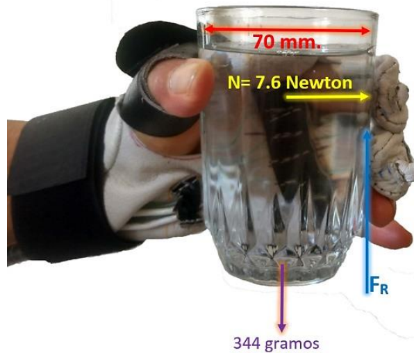
Figura 39: Diagrama de cuerpo libre aplicado a un objeto de vidrio con 70 milímetros de diámetro y una masa de 344 gr. (Fuente propia).
