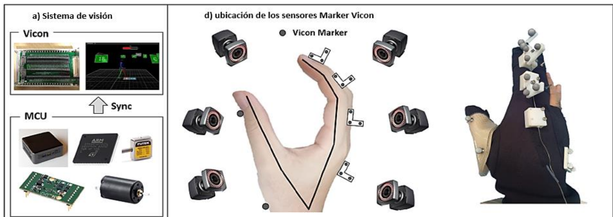
Figura 43: vista de las ubicaciones de los sensores a) sistema de visión Vicon, transmite señales al sistema ADC, b) muestra el lugar donde están ubicados los 14 sensores Marker Vicon (BYUNGCHUL et al., 2020).
