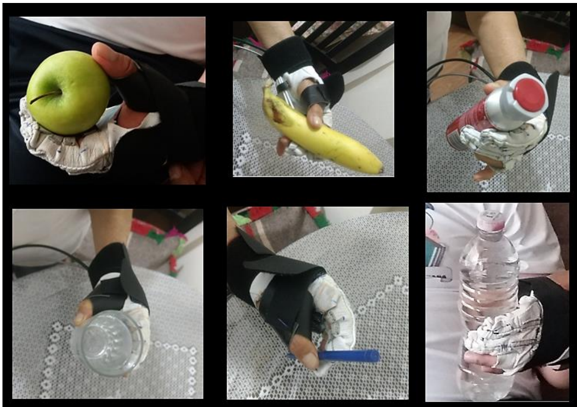
Figura 40: Sujeción exitosa de varios objetos con la ayuda del Exoguante (Fuente propia).
