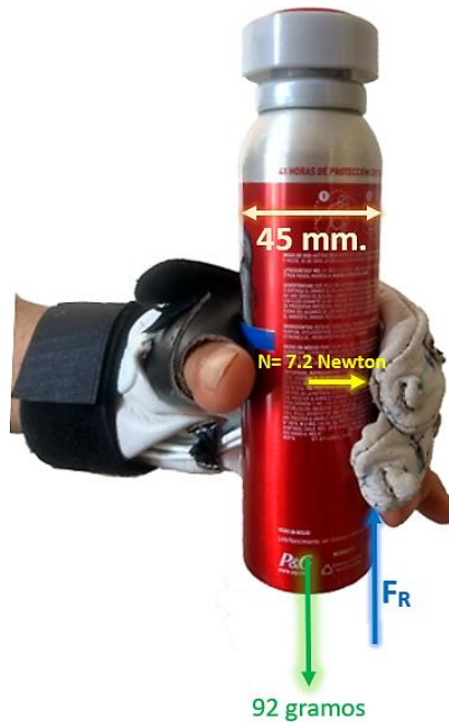
Figura 38: Diagrama de cuerpo libre aplicado a un objeto cilíndrico de aluminio con 45 milímetros de diámetro y una masa de 92 gr. (Fuente propia).
