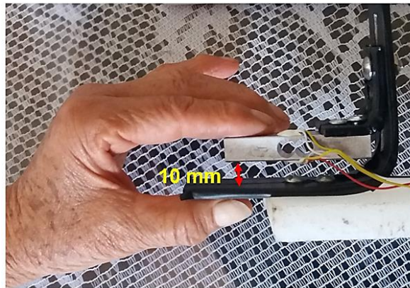
Figura 27: Medición de fuerza promedio en los dedos índice y medio a 10 milímetros sin utilizar el guante (Fuente propia).
