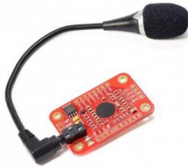
Figura 21 Modulo de voz V3 (Fuente ELECHOUSE 2014)
