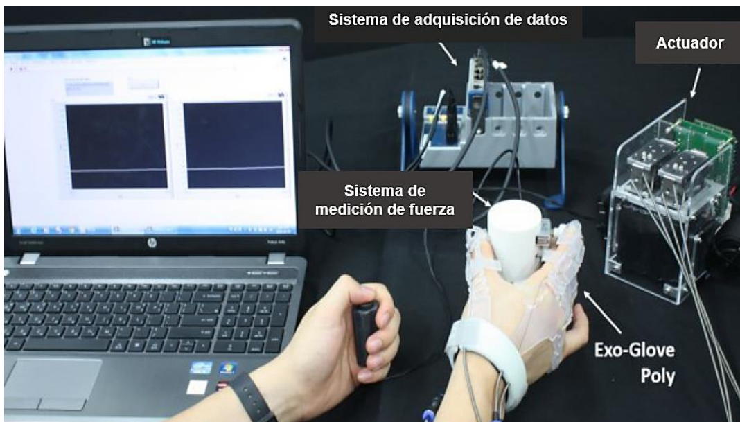
Figura 47: sistema de control y funcionamiento del Exo-Glove Poly (KANG et al., 2016).
