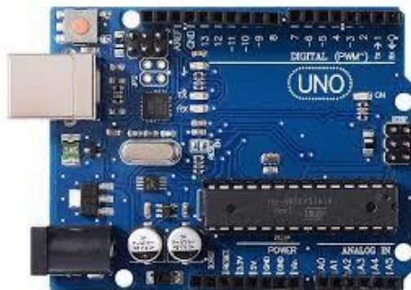
Figura 22: tarjeta electrónica Arduino Uno (Fuente ARDUINO.CC 2020).
