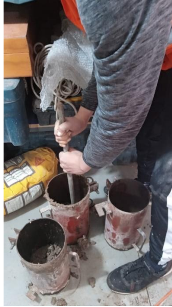
Figura 22. Fabricación de briquetas – varillado.
