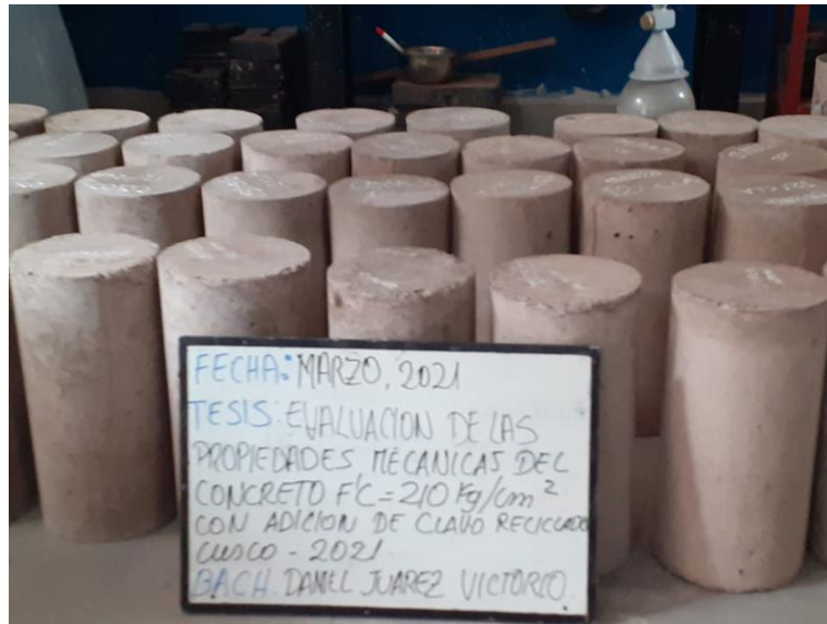
Figura 27. Briquetas de compresión y módulo de Young
