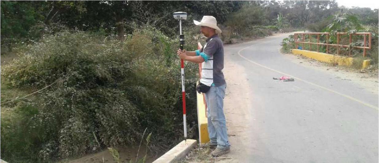
Foto N°:11 Lectura de BM-00 en Canal de riego L2 Higuieron
