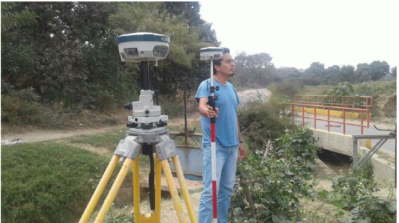
Foto N°:02 Equipo GNSS (GPS diferencial) estacionado como Base y brigada topográfica realizando el levantamiento topográfico en captación de canal de riego L2 Higerón
