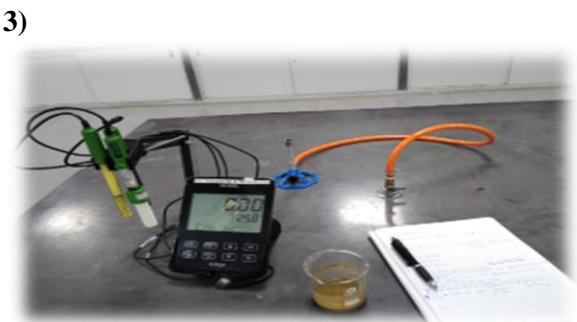
Instalación de equipo peachímetro.
