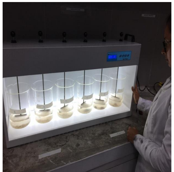
Figura 22: Prueba de jarras con las respectivas dosis de linaza.
