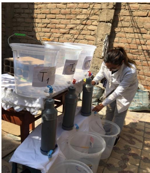
Figura 17: Construcción del biofiltro.
