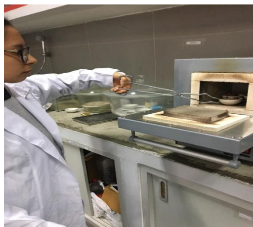
Figura 8: Cascara de piña seca en capsulas llevado a la mufla.
