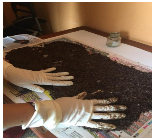
Figura 14: Residuos de linaza seca, añadida con Hexano por 24 horas.
