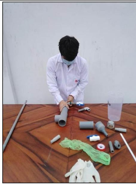
Fotografía 15: Ensamblado del cuerpo y base de empaque del biofiltro.
