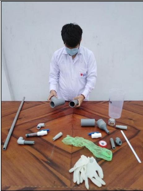
Fotografía 14: Ensamblado de cabeza de empaque del biofiltro.
