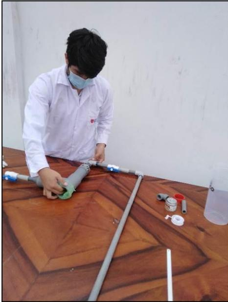
Fotografía 18: Introducción de maya de PVC para material filtrante.
