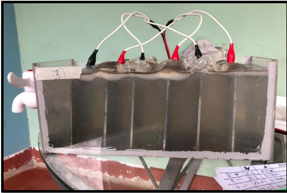
Figura N°24 prueba 3 configuración hierro-aluminio (ánodo - cátodo)
