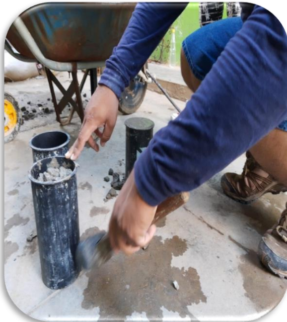
Fotografía 3: Observamos la continuación de elaboración de probetas
