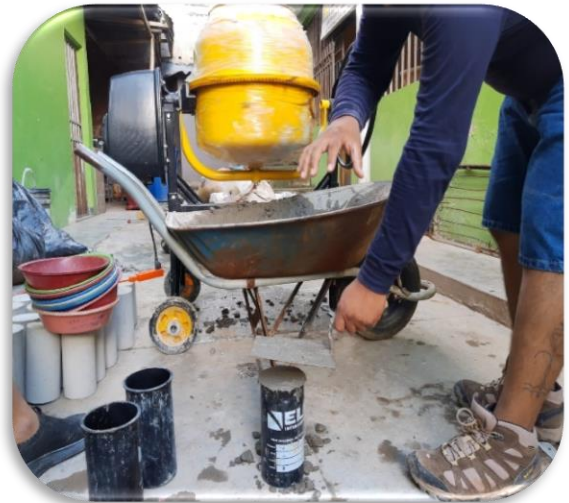
Fotografía 6: Después del chuseo se nivela el concreto.
