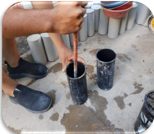
Fotografía 5: Se observa el chuseo del concreto en cada una de las 3 capas.
