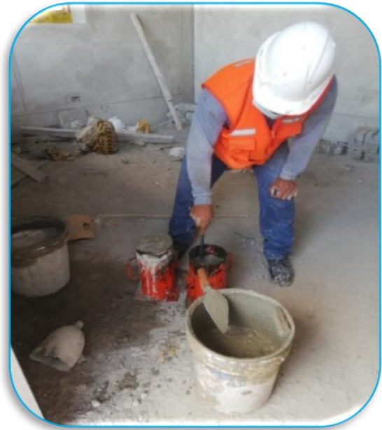
Fotografía 1: Se aprecia el curado y elaboración de probeta de concreto f'c 210 kg/cm 2 .
