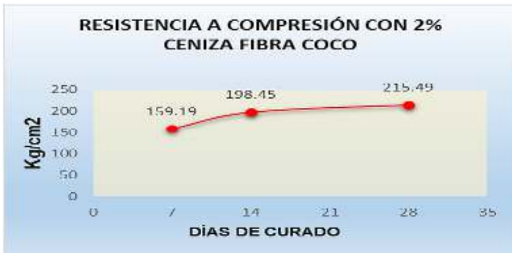
Figura 4: Gráfico de la resistencia a compresión del concreto más la adición del 2% de ceniza de fibra de coco.
