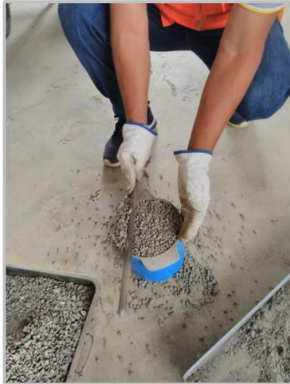
Figura 16. Colocación del agregado grueso al recipiente para el cálculo del P.U. suelto y compactado
