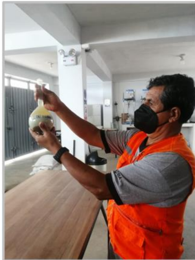
Figura 8. Opresión el agregado fino a la fiola
