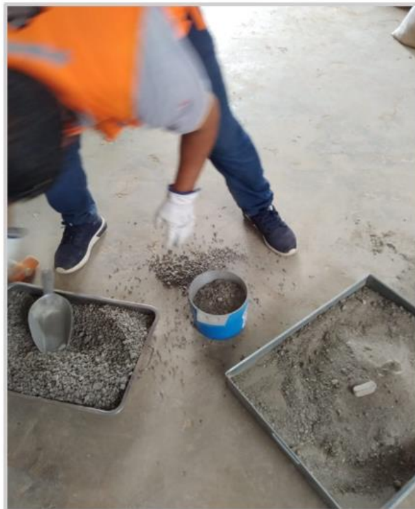
Figura 10. Llenado del recipiente con el agregado
