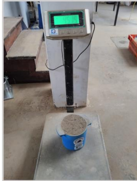
Figura 9. Enrasado y pesado del recipiente con la muestra para el cálculo del peso unitario suelto
