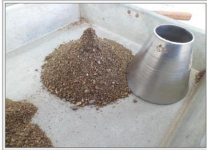
Figura 7. Agregado fino después del apisonado
