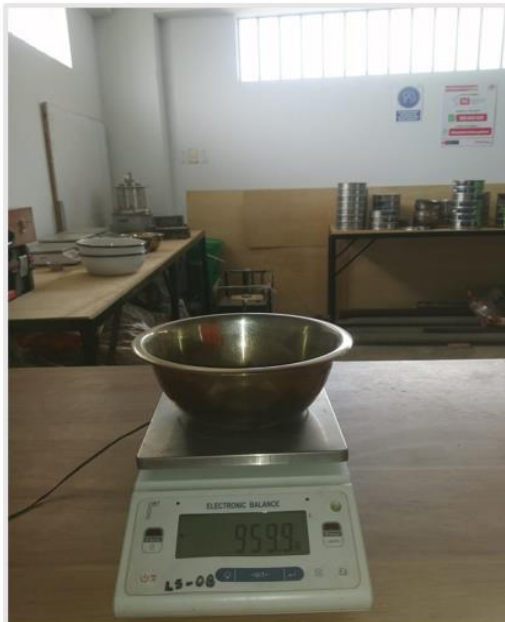
Figura 15. Pesado del agregado grueso
