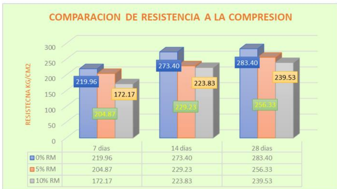
Gráfico 5. Comparación de la Resistencia a Compresión obtenidos para diferentes Porcentajes de Relave Minero.
