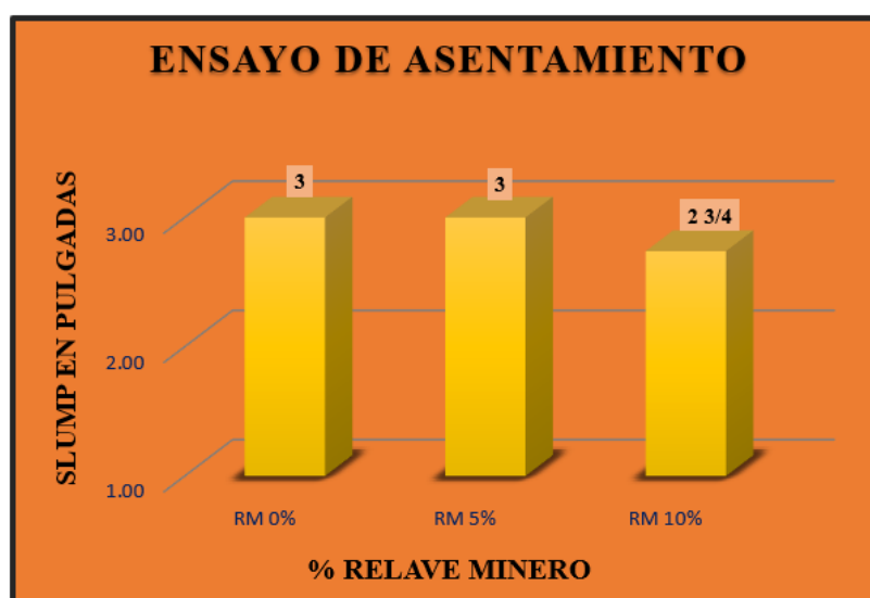
Gráfico 4. Alteración de asentamiento de porcentajes de relave
