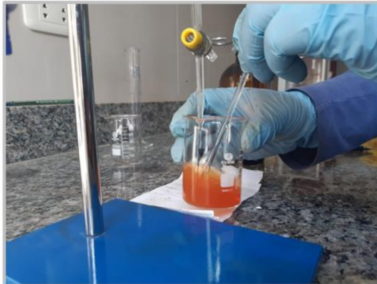
Figura 18. Determinación ( \gamma ) del relave.
