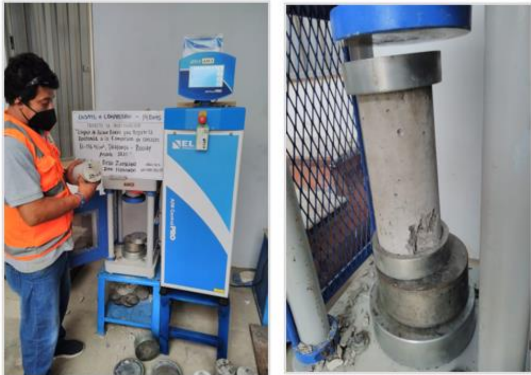
Figura 26. Rotura de briquetas de 4"x8" respectivamente.
