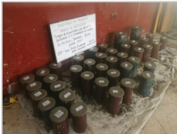
Figura 21. Moldes vaciados con concreto, para su posterior desencofrado luego de 24 horas de vaciado.
