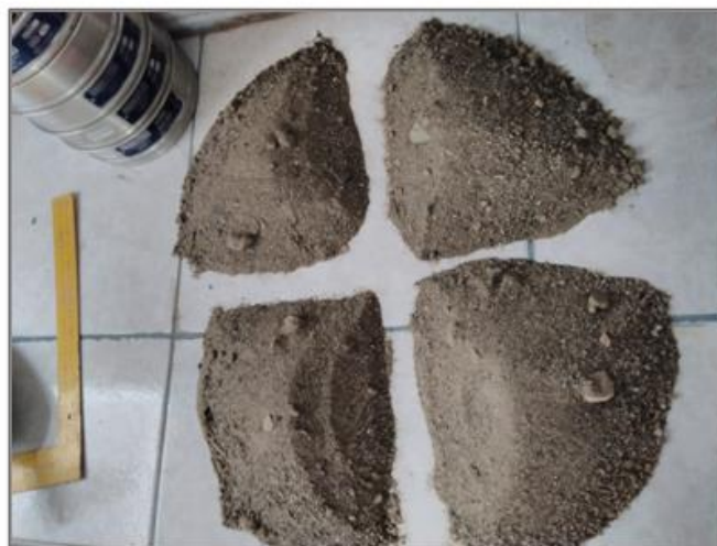
Figura 5. Se observa el cuarteo del agregado fino
