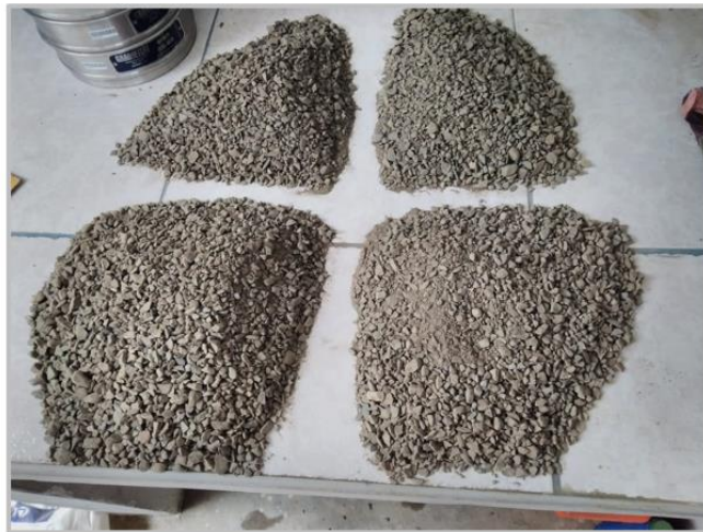
Figura 14. Cuarteo del agregado grueso
