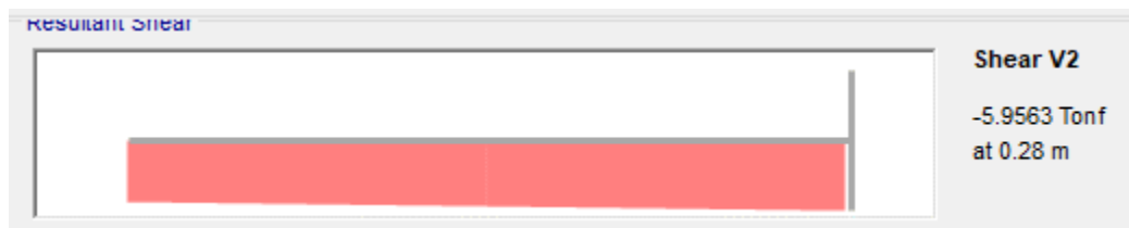
Figura 326 Diagrama de fuerza cortante máxima actuante de muro del primer sótano
