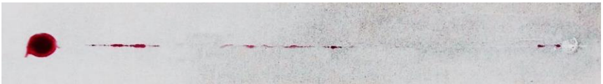
Figura 21. Soldadura con indicación de LP – 1750rpm a 2.3mm/seg.
