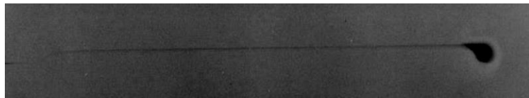
Figura 17. Túnel continuo definido – 1750rpm a 4mm/seg.
