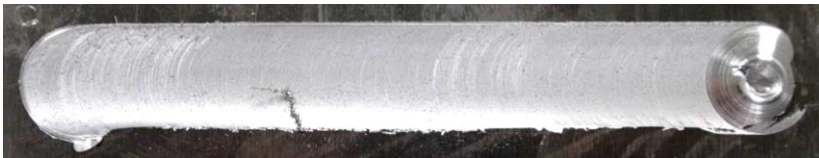
Figura 15. Soldadura sin rebaba – 1750rpm a 4mm/seg.
