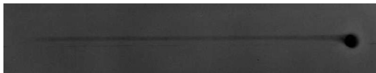
Figura 18. Túnel continuo difuso – 1750rpm a 2.3mm/seg.
