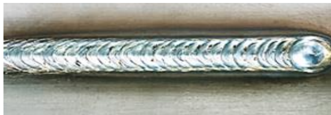
Figura 24. Soldadura mig con adecuado cordón – 2.3mm/seg.
