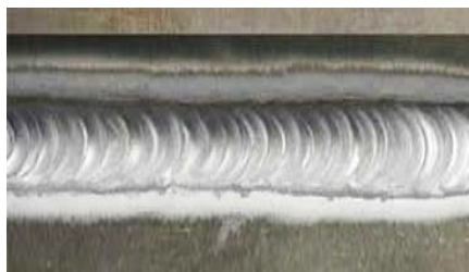
Figura 12. Probetas para el proceso gmaw – mig.
