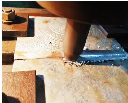
Figura 11. Probetas para el proceso fsw.
