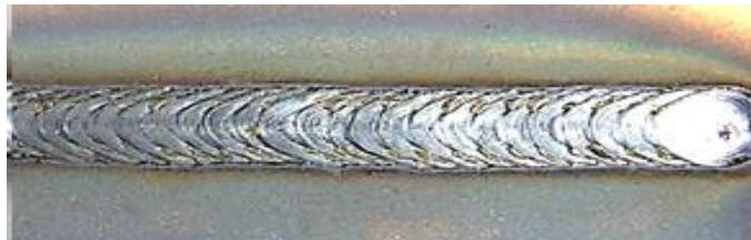
Figura 25. Soldadura mig con insuficiencia de cordón – 4mm/seg.
