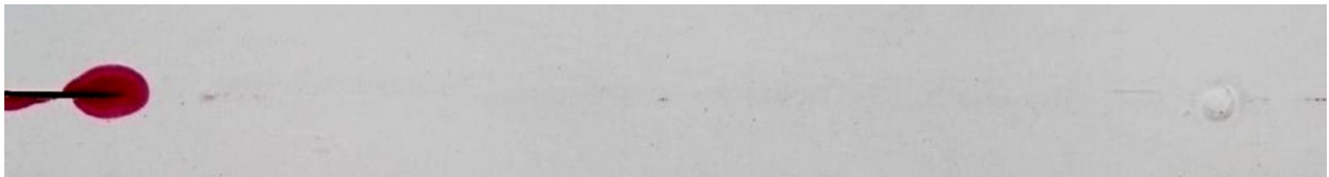
Figura 22. Soldadura sin indicación de LP – 1750rpm a 1mm/seg.
