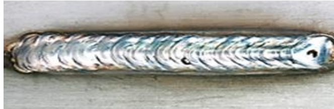
Figura 23. Soldadura mig con excesivo cordón – 1mm/seg.
