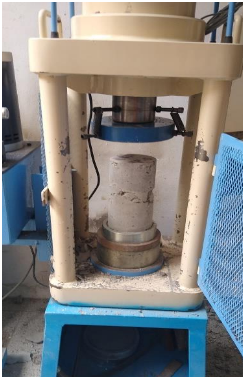
Foto 27: Ensayo de Resistencia a la compresión con incorporación de viruta.
