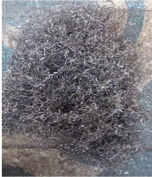
Figura 9: Viruta de acero Bonificado obtenido empresa metalmecánica
