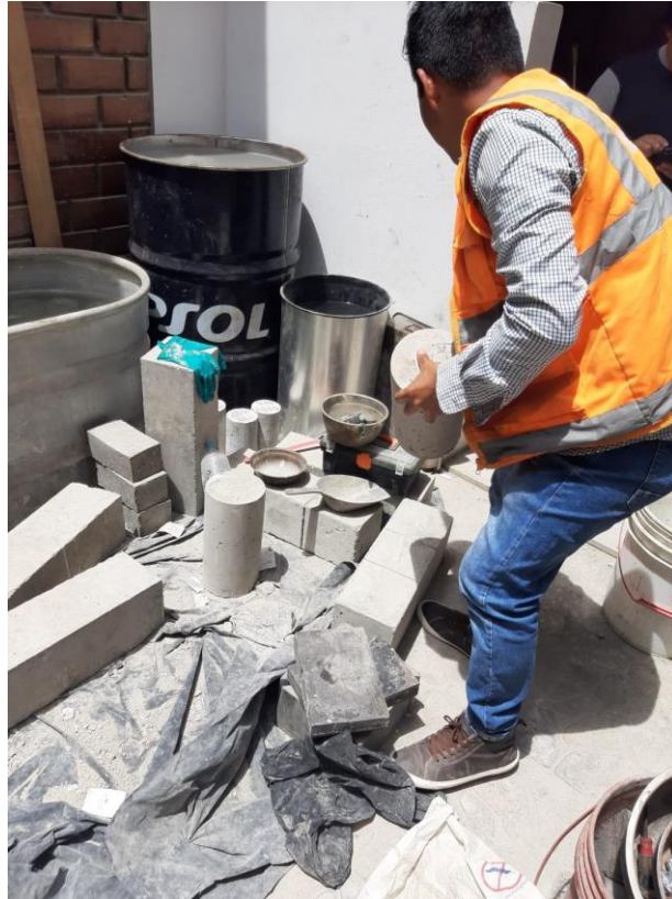
Foto 24: Testigos para los ensayos mecánicos de concreto.
