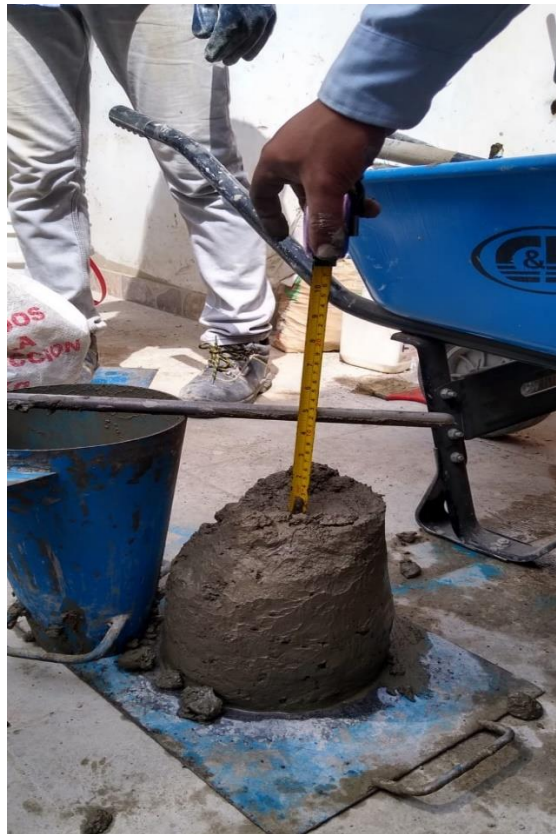
Foto 20: determinar su asentamiento del concreto.
