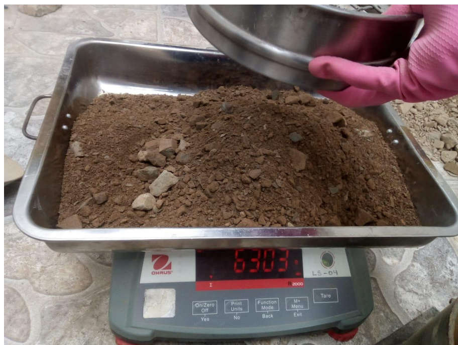
Foto 12: Obtención del peso seco de tierra para el Proctor Modificado
