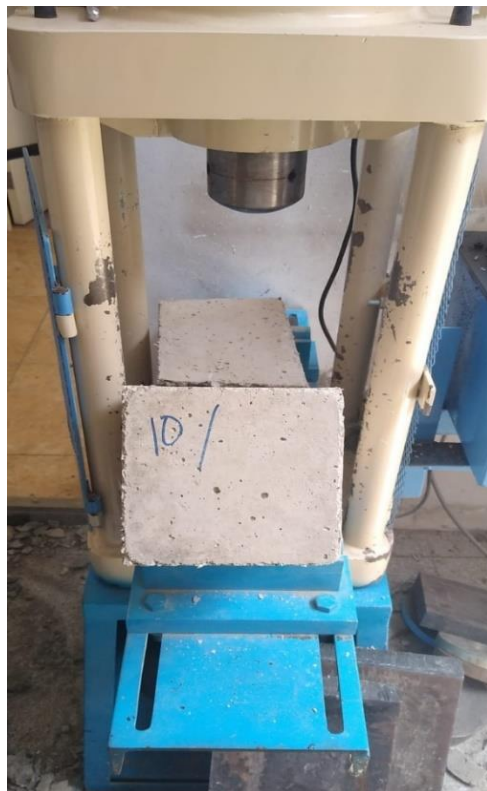
Foto 27: Ensayo de Resistencia a la flexión con incorporación de viruta.
