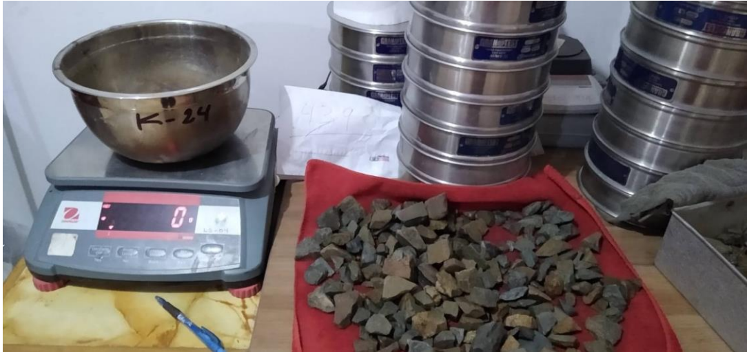
Foto 17: Lavar piedra chancada. Lavado por decantación
