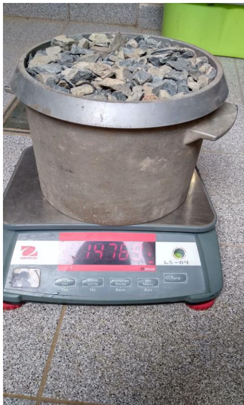
Foto 16: Peso de Agregado, para el diseño de mezcla
