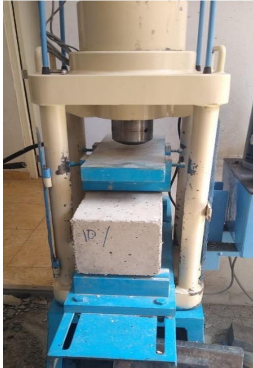
Foto 28: Ensayo de Resistencia a la flexión con incorporación de viruta.
