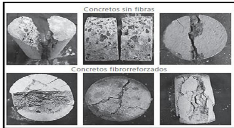
Figura 1: Modo de fallas de probetas cilíndricas sin fibras y fibrorreforzadas sometidas a tracción indirecta
