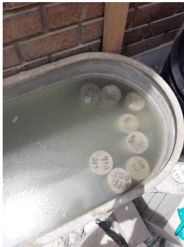
Foto 23: Proceso de curado de los testigos para ensayos mecánicos de concreto.
