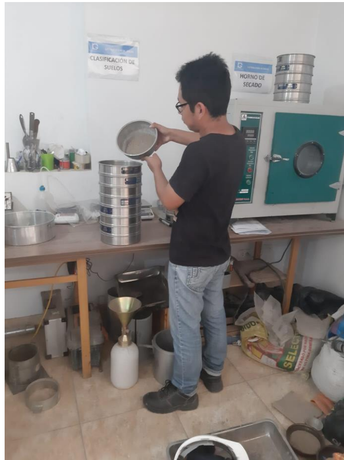
Foto 11: Trabajo para análisis de ensayos granulométrico
