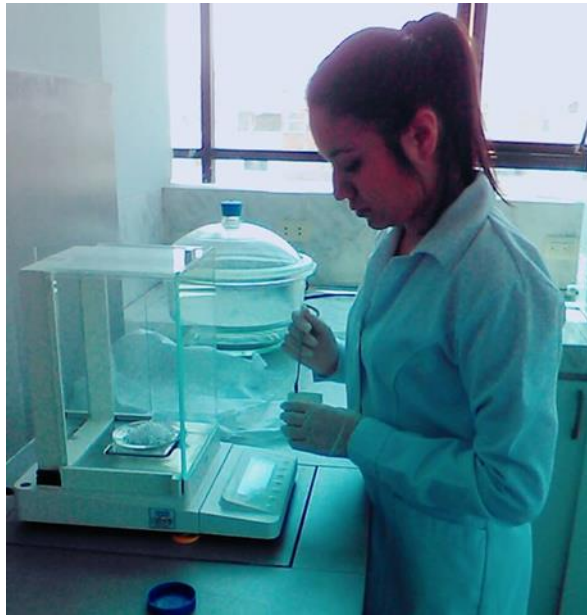
Imagen N° 2: Pesaje del hidróxido de sodio Fuente: Propia
