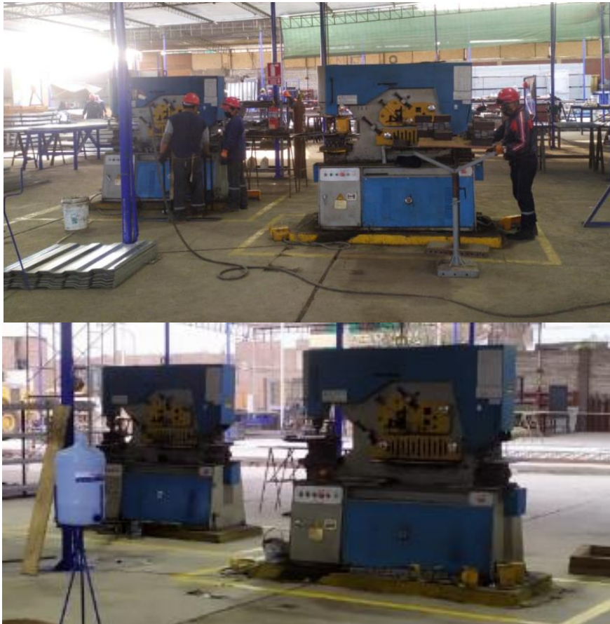
Figura 15. Señalización de las maquinarias con pintura de tráfico
