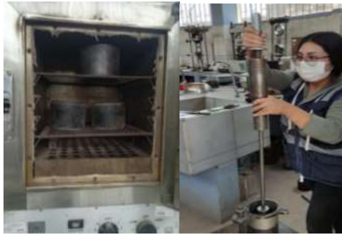
Figura 22 Compactación manual de mezcla para briquetas.
