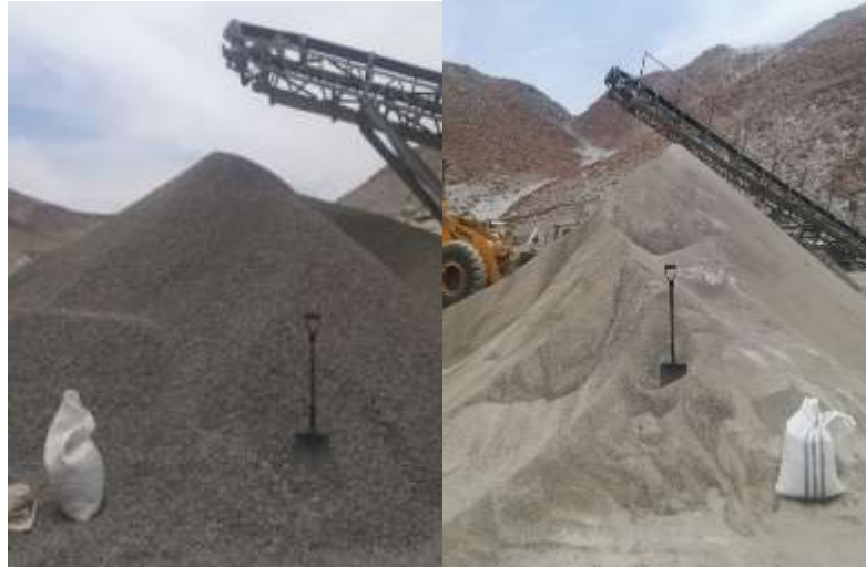
Figura 9. Producción de agregado de TM 1/2" y arena chancada (Planta Chancadora de la GRTC- Arequipa).
