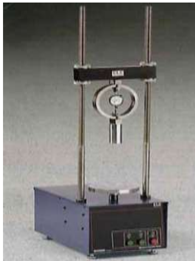
Figura 3. Máquina de Estabilidad con Anillo de Carga. (The Asphalt Institute MS-22, 1982).
