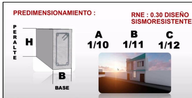
Figura 9: Predimensionamiento de viga Fuente: (Garcia , 2016)
