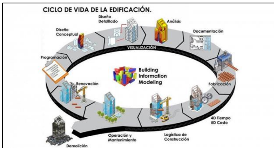
Figura 1: Ciclo de vida de una edificación con BIM Fuente: (Kaizen Arquitectura e Ingeniería, 2020)
