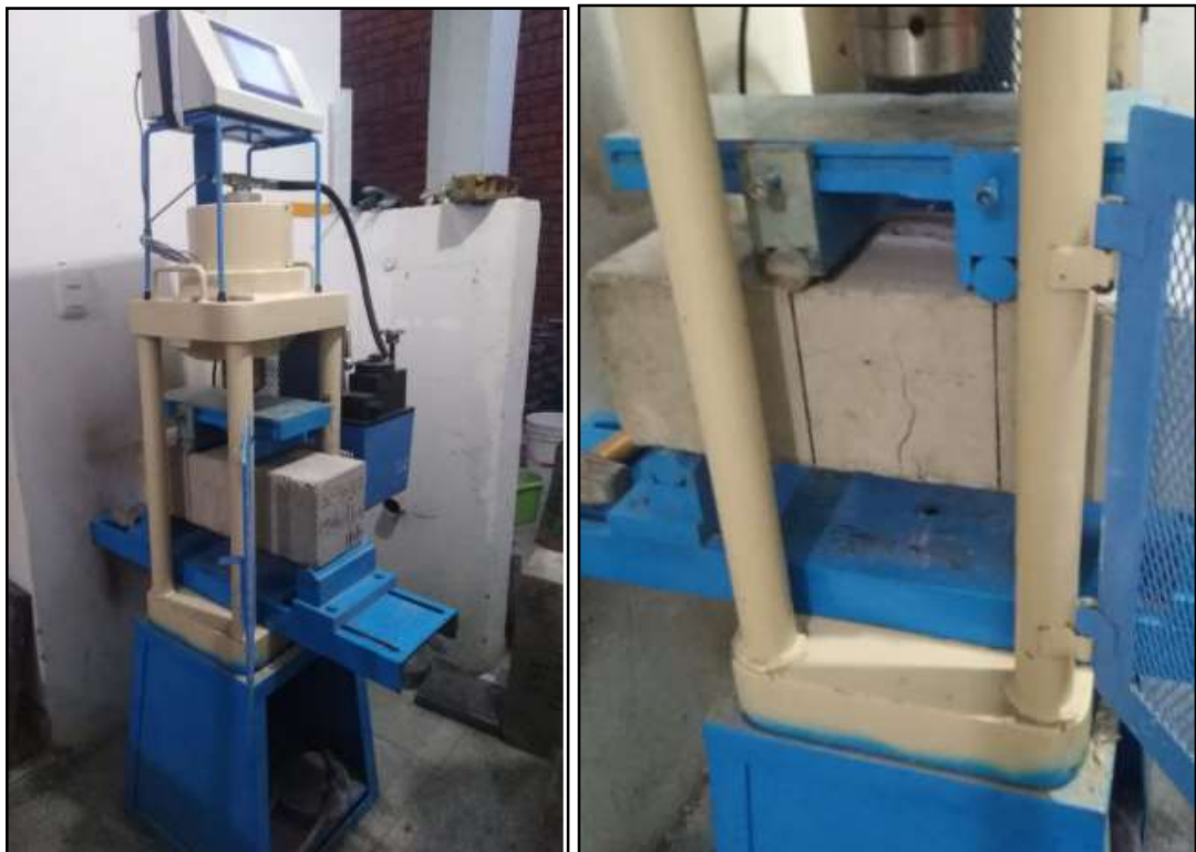
Figura 37. Rotura de Vigas
