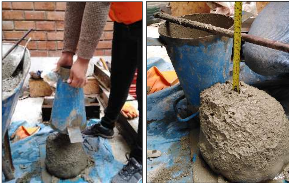
Figura 25. Procedimiento de prueba de consistencia
