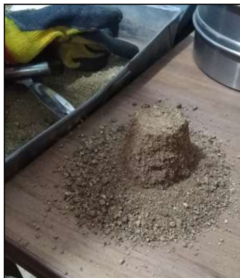
Figura 13. Agregado en condición S.S.S
