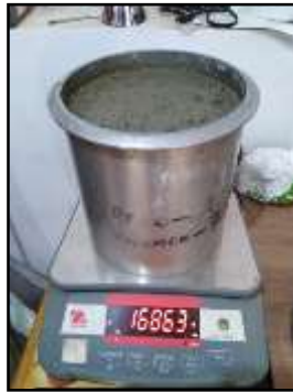
Figura 28. Pesado de la prueba de exudación
