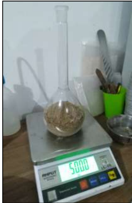
Figura 14. Llenado de Fiola con 500 gr de agregado fino
