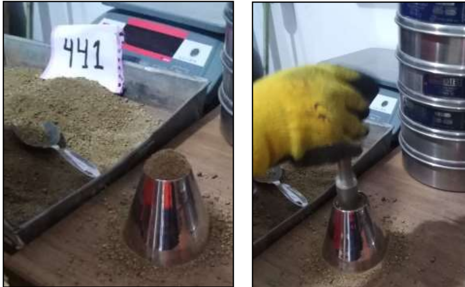
Figura 12. Llenado del cono metálico y apisonado
