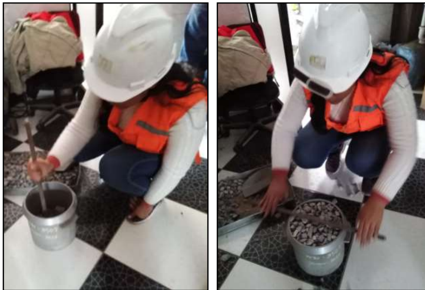
Figura 24. . Peso unitario compactado, llenado y enrasado del A. Grueso
