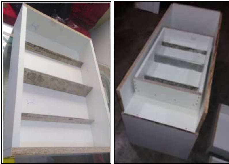
Figura 32. Elaboración del molde de contracción plástica
