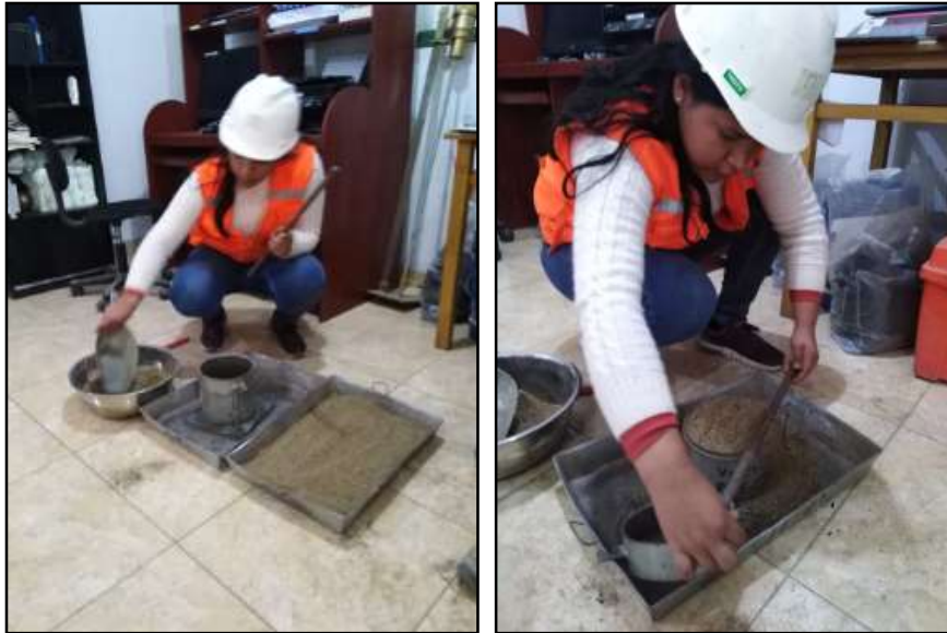
Figura 21. Peso unitario suelto, llenado y enrasado del A. Fino
