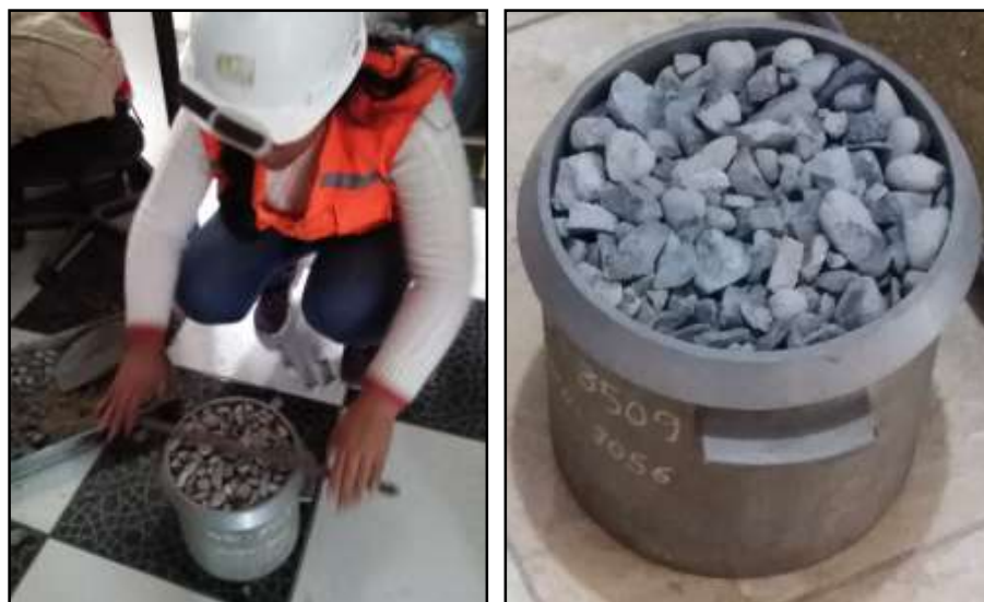
Figura 22. Peso unitario suelto, llenado y enrasado del A. Grueso
