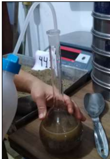
Figura 15. Adición de agua en la fiola con contenido de agregado fino
