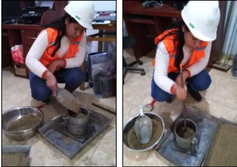
Figura 23. Peso unitario compactado, llenado y enrasado del A. Fino
