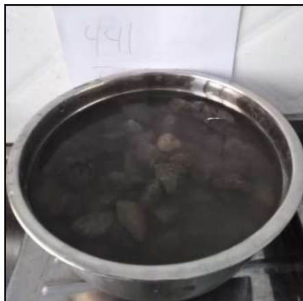
Figura 17. A. Grueso Saturado durante 24 horas
