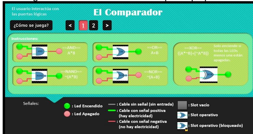
Esta pantalla del prototipo mostraría la información sobre el funcionamiento de cada puerta lógica.
