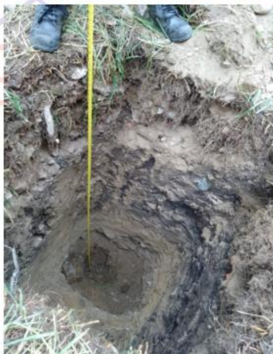
Fotografía N° 06. Perfil Estratigráfico de la calicata C – 1.
