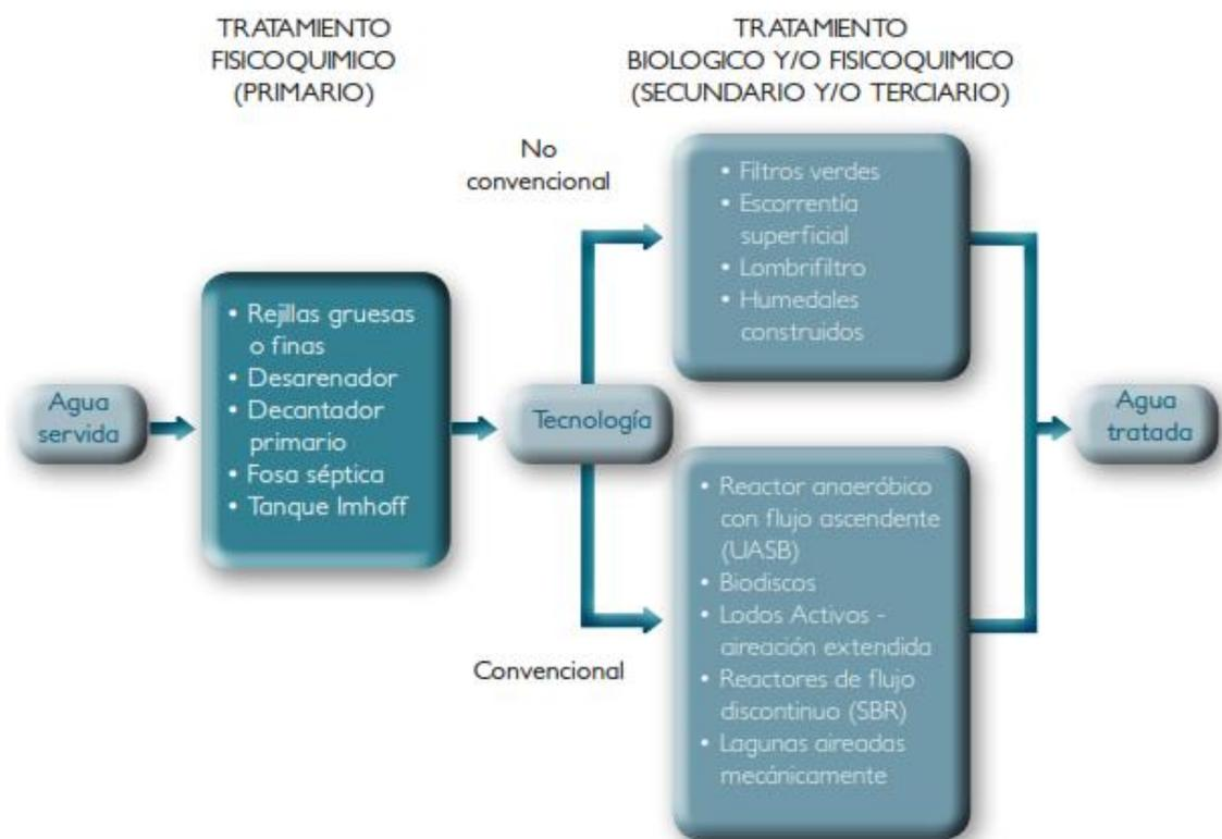
Nota. Los niveles de tratamiento de aguas servidas en el Perú para zonas urbanas y rurales, se dividen en: primario, secundario y terciario. La figura muestra las diferentes tecnologías en el tratamiento de aguas servidas. Tomado de *Las aguas servidas y su depuración en zonas rurales* (p. 61), por Vidal y Araya, 2014, Universidad de Concepción.
