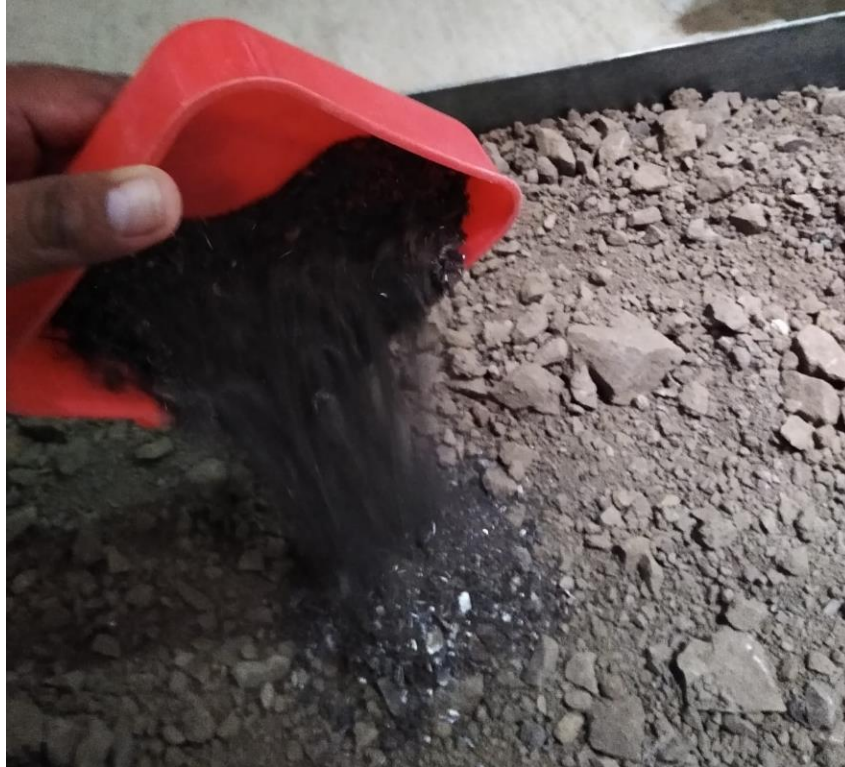
Fotografía 5. Mezcla del suelo con escoria de acero. Fuente: Elaboración propia.
