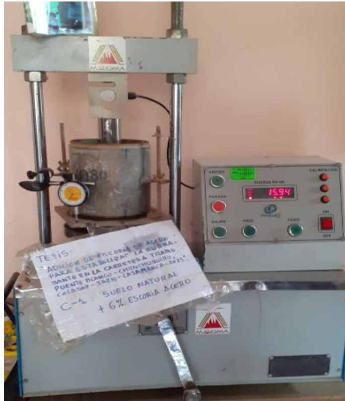
Fotografía 11. Ensayo a las muestras de suelo con adición de escoria. Fuente: Elaboración propia.
