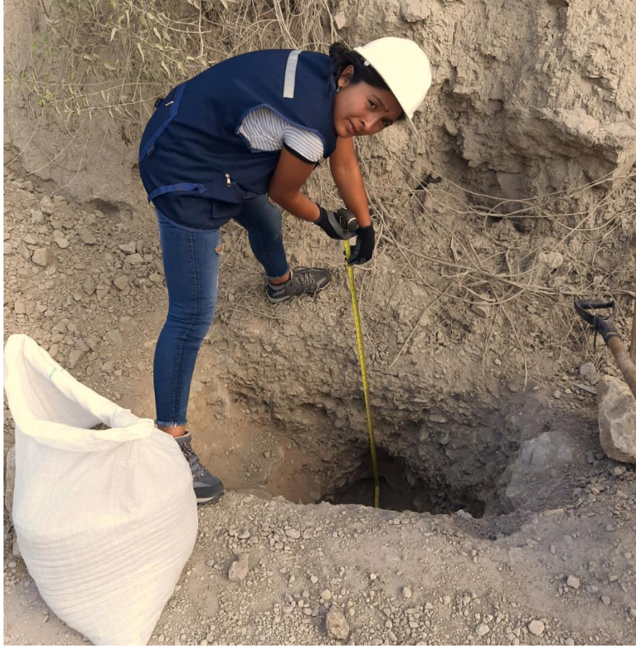
Fotografía 3. Medición de la profundidad de las calicatas. Fuente: Elaboración propia.
