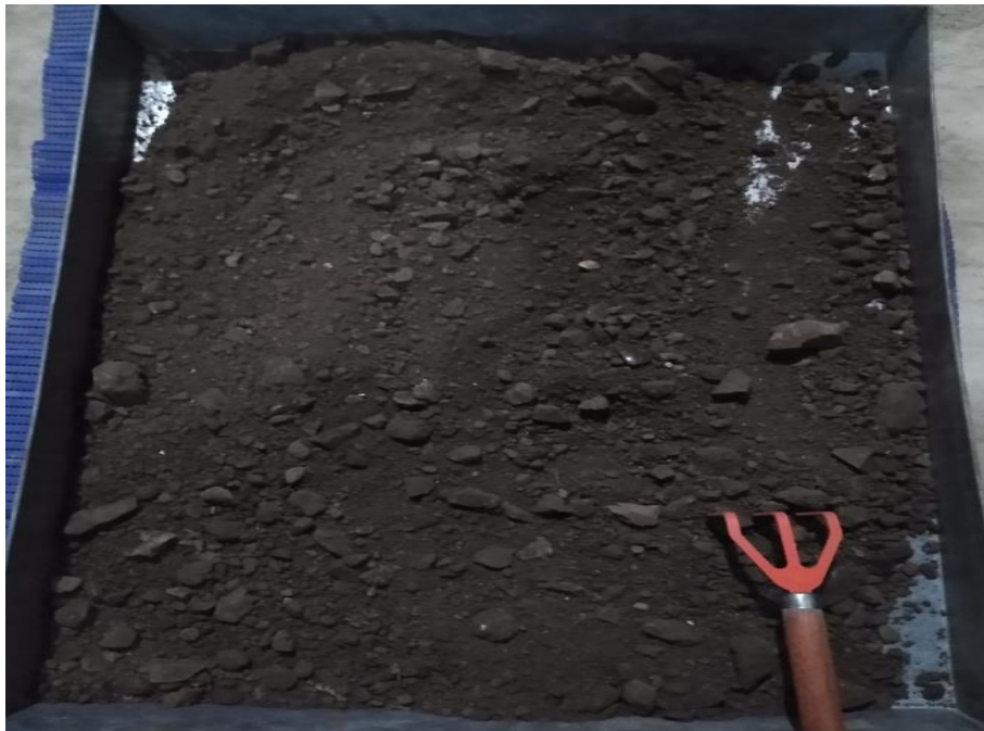
Fotografía 4. Muestra de suelo con adición de escoria de acero. Fuente: Elaboración propia.
