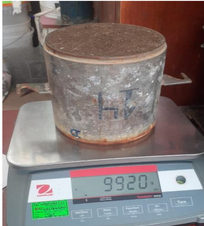
Fotografía 9. Pesaje de suelo compactado en probeta. Fuente: Elaboración propia.
