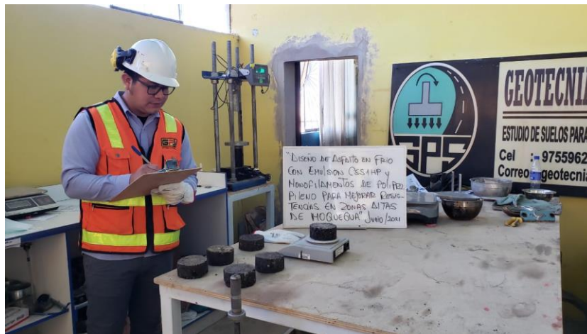
Imagen 31: pesaje de pastillas de asfalto mejorado con fibra.
