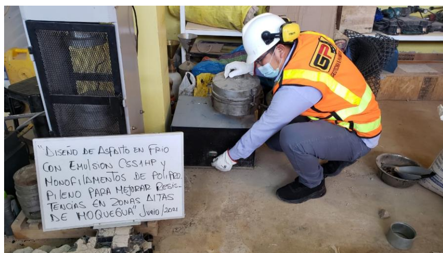
Figura 29. Lavado asfáltico en centrifuga.
