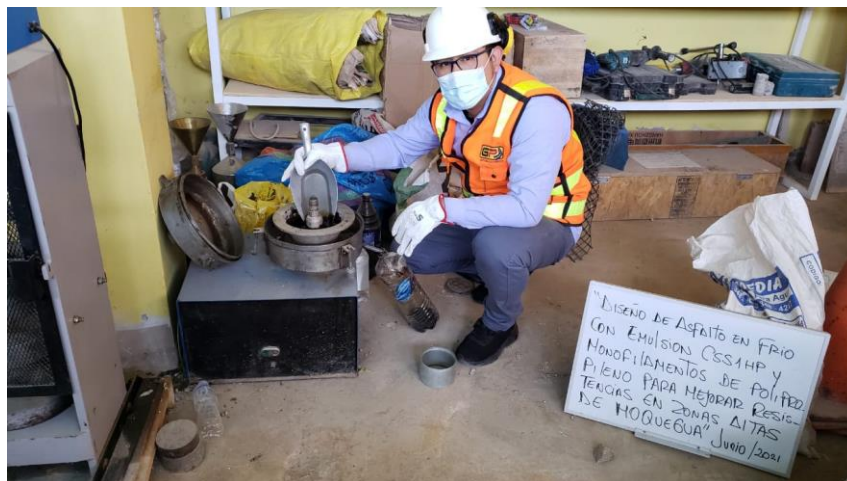
Figura 28. Preparación de material para lavado asfáltico en centrifuga.
