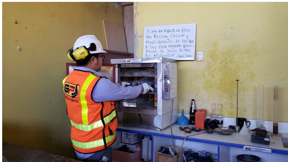
Figura 18. Secado de agregados en horno.
