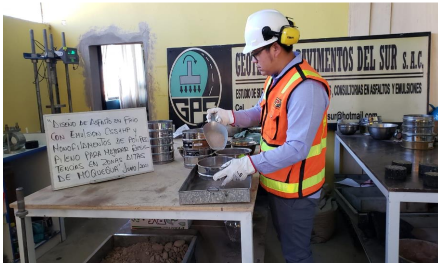
Figura 20. Ensayo granulométrico agregado fino.
