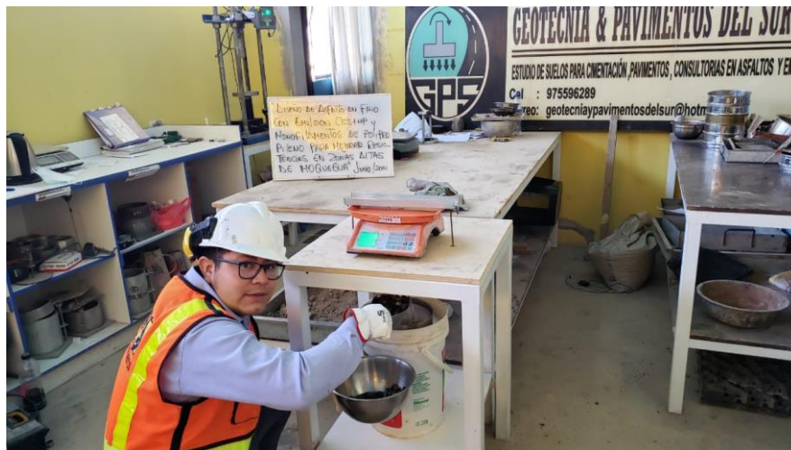
Figura 25. Ensayo de peso específico agregado grueso
