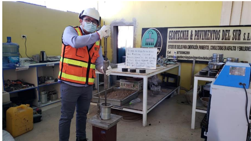
Figura 30. Compactación de pastillas mejorado con fibras.
