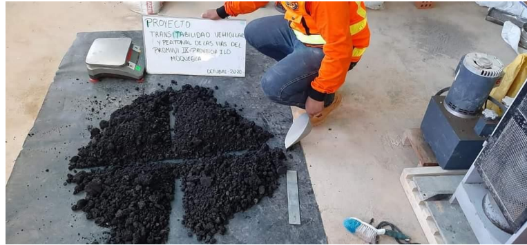
Figura 27. Cuarteo de mezcla asfáltica.
