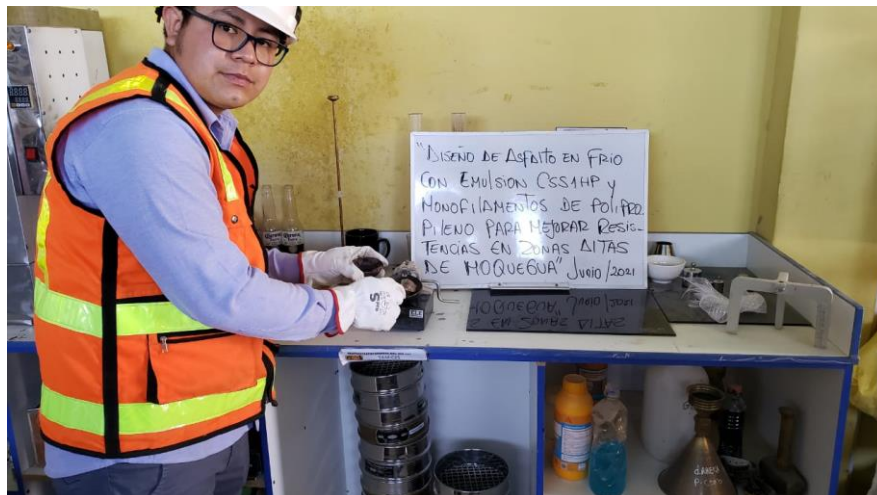
Figura 24. Ensayo de límites de Atterberg.
