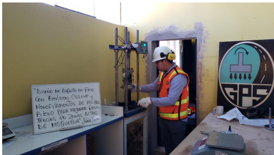
Figura 34. Ensayo a la compresión Marshall de asfalto mejorado con Fibras.
