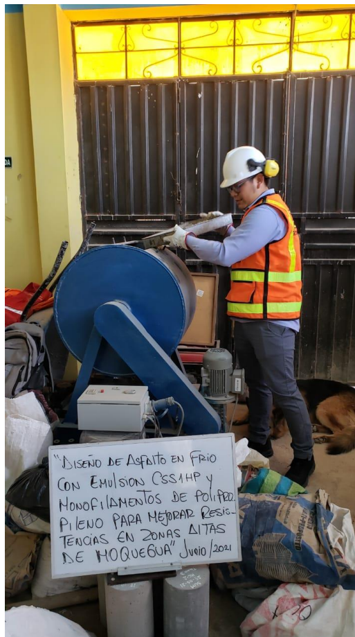
Figura 21. Ensayo de abrasión los ángeles.
