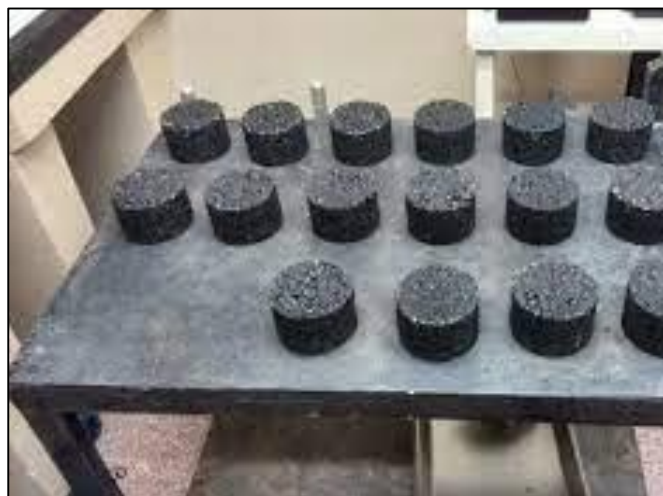
Imagen 32: Muestras de pastillas de asfalto mejorado con fibra.
