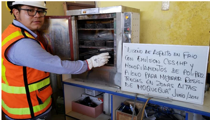
Figura 33. Secado de pastilla de asfalto mejorado con fibras
