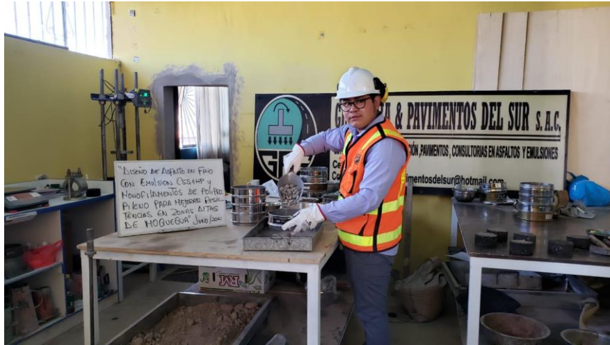
Figura 19. Ensayo granulométrico agregado grueso.
