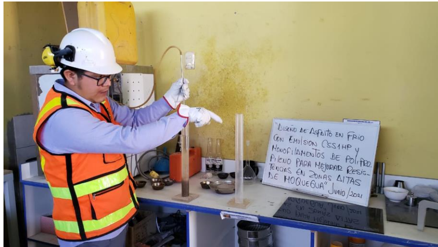
Figura 22. Preparación de muestra para ensayo de equivalente de arena
