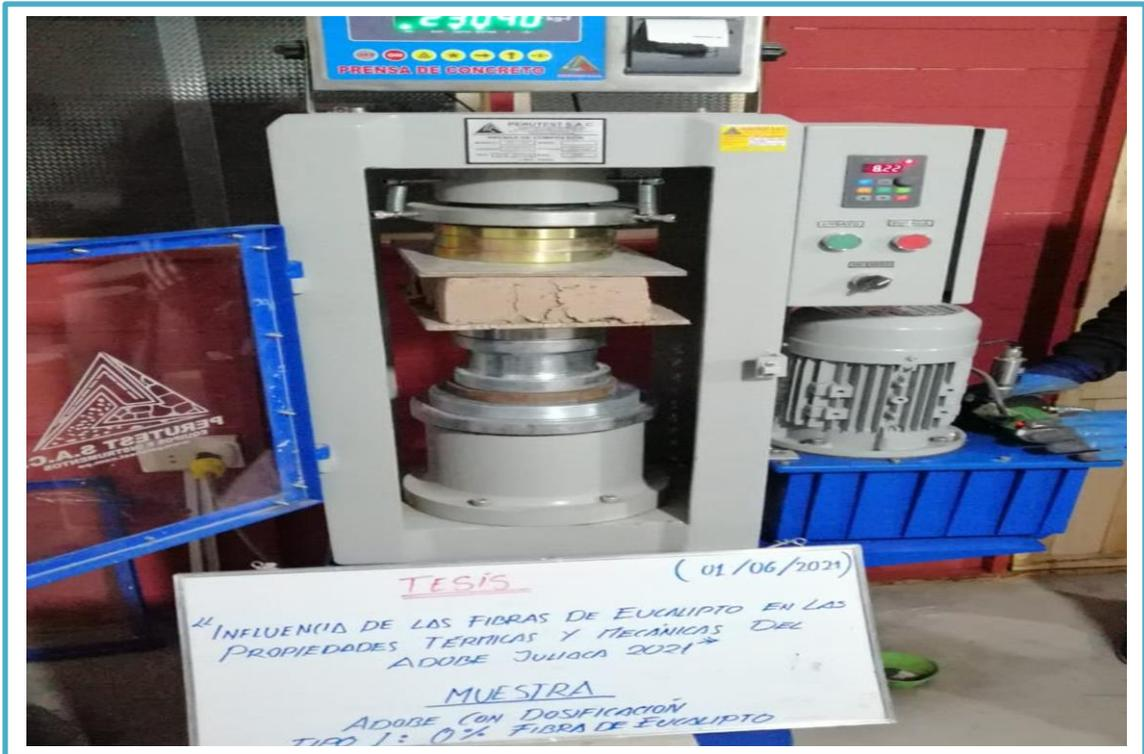
FOTO N° 15: Rotura a compresión con 0% de adición de fibras
