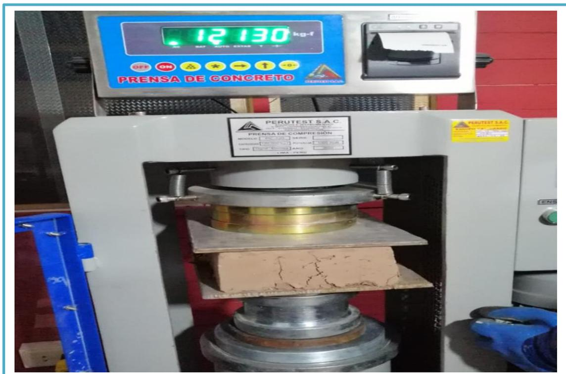
FOTO N° 16: Rotura a compresión con 1% de adición de fibras
