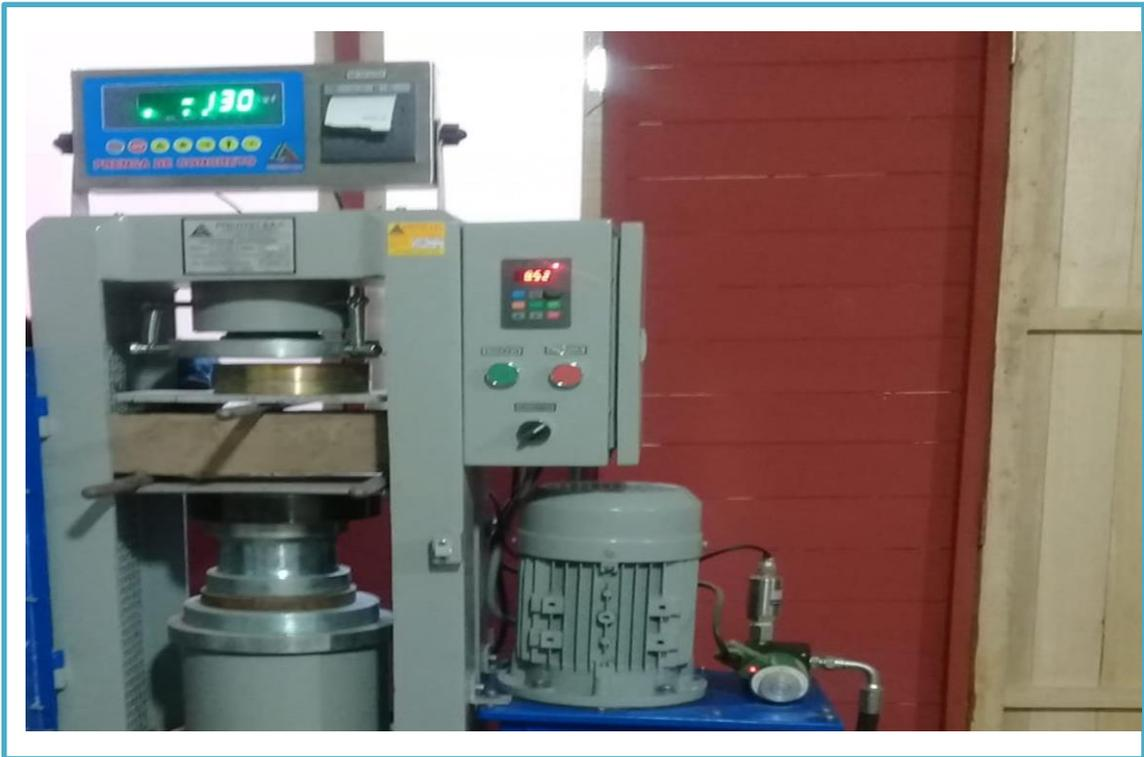
**FOTO N° 21: Rotura a flexion con 2.5% de adiccion de fibras**
