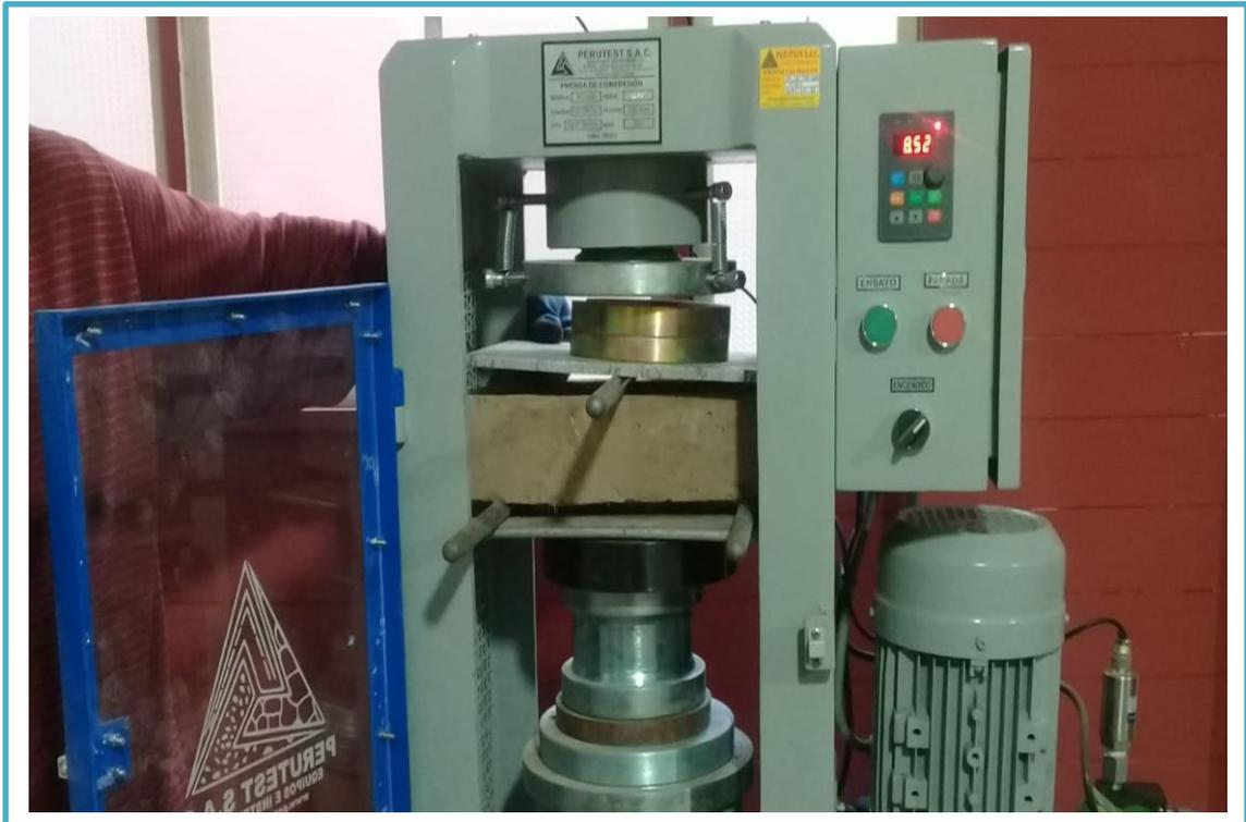
**FOTO N° 19: Rotura a flexion con 0% de adición de fibras**
