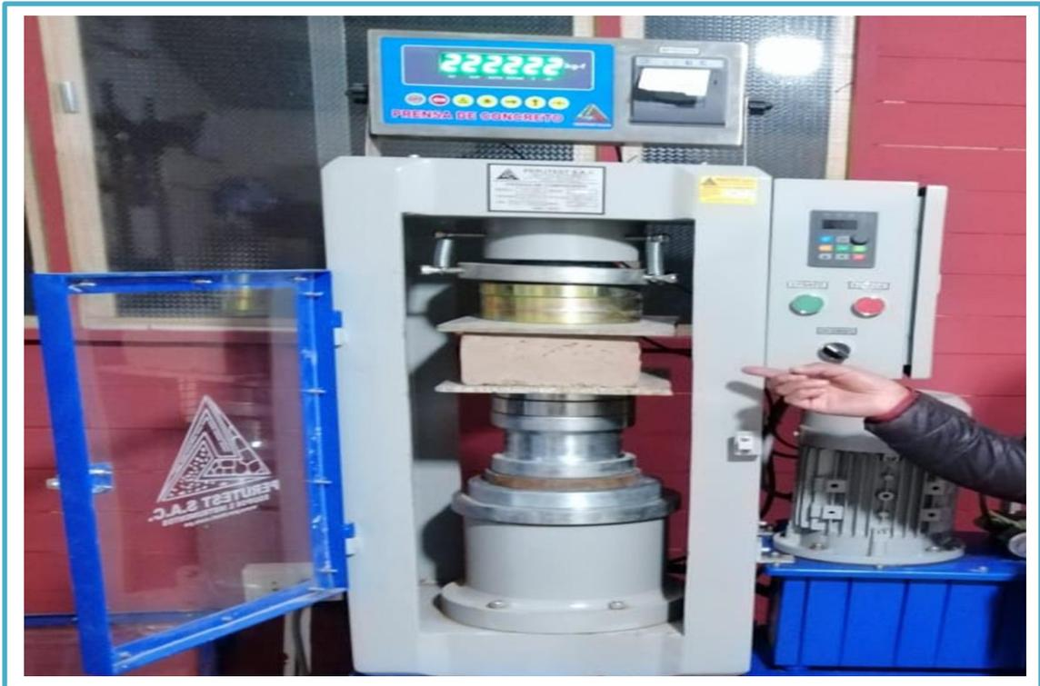
**FOTO N° 17: Rotura a compresión con 2.5% de adición de fibras**
