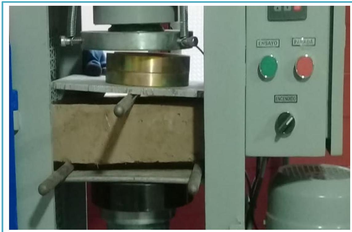
**FOTO N° 22: Rotura a flexion con 4% de adiccion de fibras**
