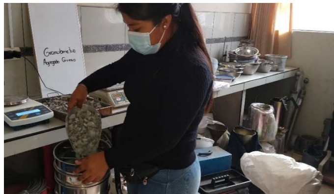
Figura N° 14 Tamizado del agregado grueso
