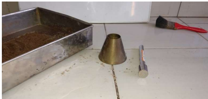
Figura N° 19 Cono de Absorción de arena
