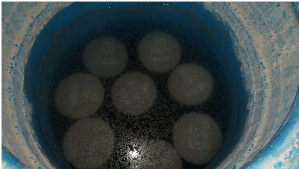
Fotografía N°32: Curado de probetas de concreto
