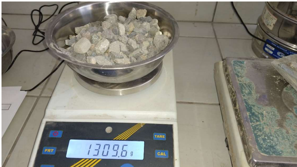
Fotografía N°04: Ensayo de humedad Natural del agregado Grueso, peso de recipiente + la muestra húmeda
