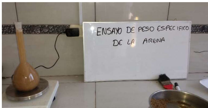
Figura N° 18 Ensayo de peso específico de la arena
