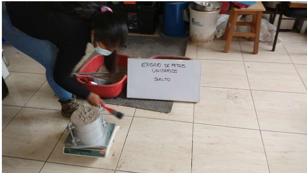
Fotografía N°11: Ensayo de pesos Unitarios Suelto – Agregado fino
