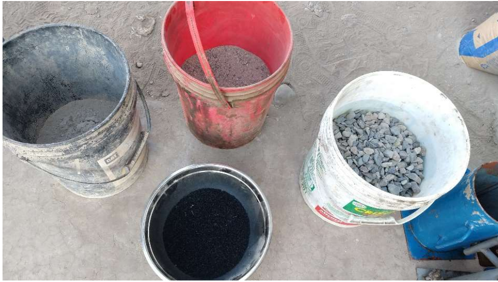
Fotografía N°01: Muestra de los materiales (arena gruesa, piedra chancada. Caucho reciclado
