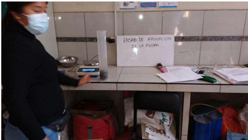
Fotografía N°16: Ensayo de pesos Especificos del agregado grueso
