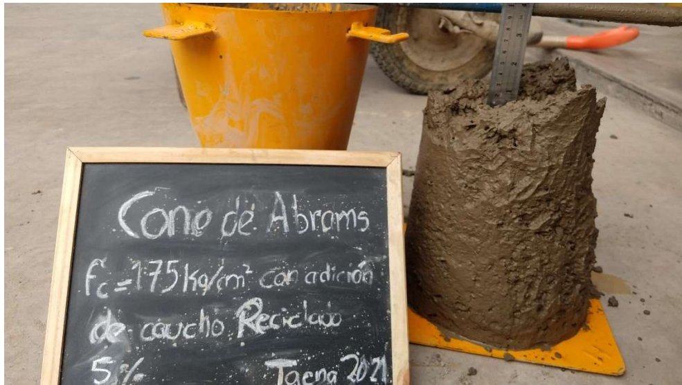
Fotografía N°29: Cono de Abrams f_c = 175 \text{ kg/cm}^2 con 5% de adición de caucho reciclado (Patrón)
