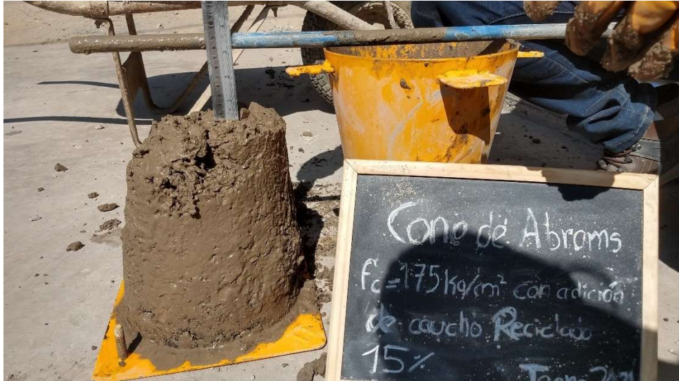
Fotografía N°31: Cono de Abrams f_c = 175 \text{ kg/cm}^2 con 15% de adición de caucho reciclado (Patrón)
