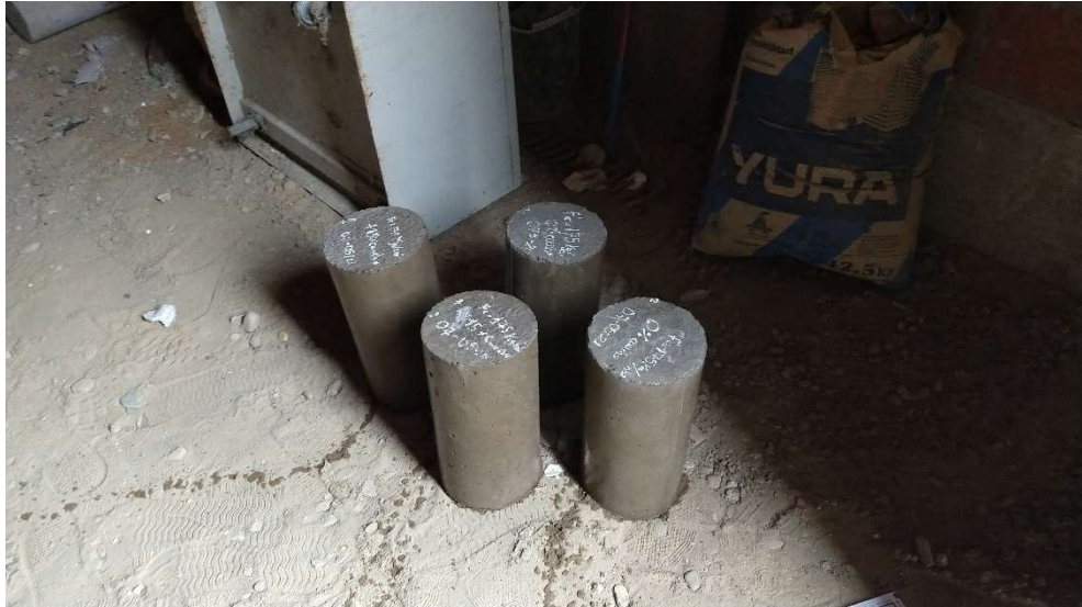
Fotografía N°33: Probetas húmedas para ser ensayadas
