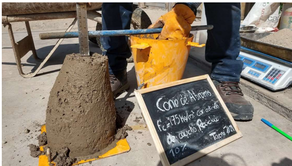
Fotografía N°30: Cono de Abrams f_c = 175 \text{ kg/cm}^2 con 10% de adición de caucho reciclado (Patrón)
