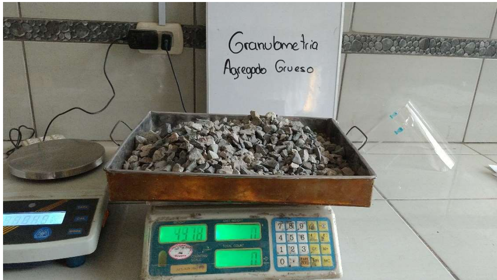
Fotografía N°09: Muestra de Agregado grueso para el análisis de Granulometría
