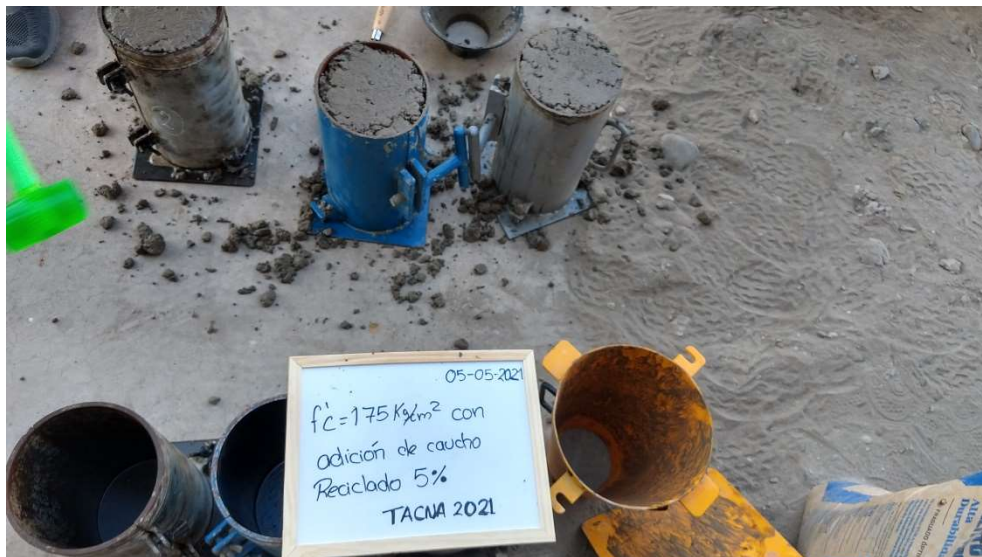
Fotografía N°24: Llenado de probetas
