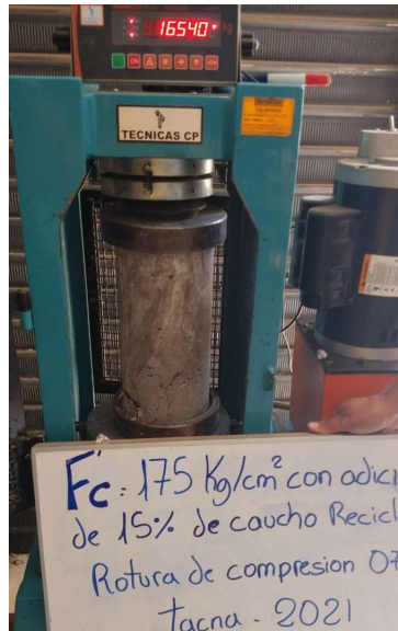
Figura N° 23 Ensayo resistencia a la compresión
