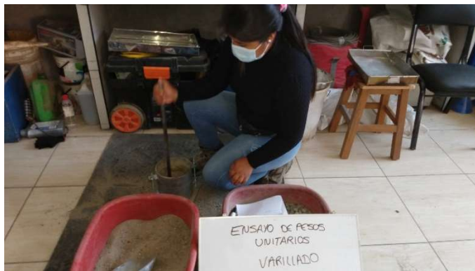
Figura N° 16 Ensayo de Pesos Unitarios Varillado
