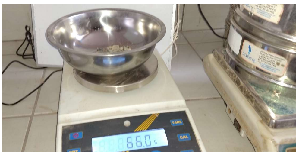
Fotografía N°08: Granulometría del agregado fino, retenido en la malla N°04
