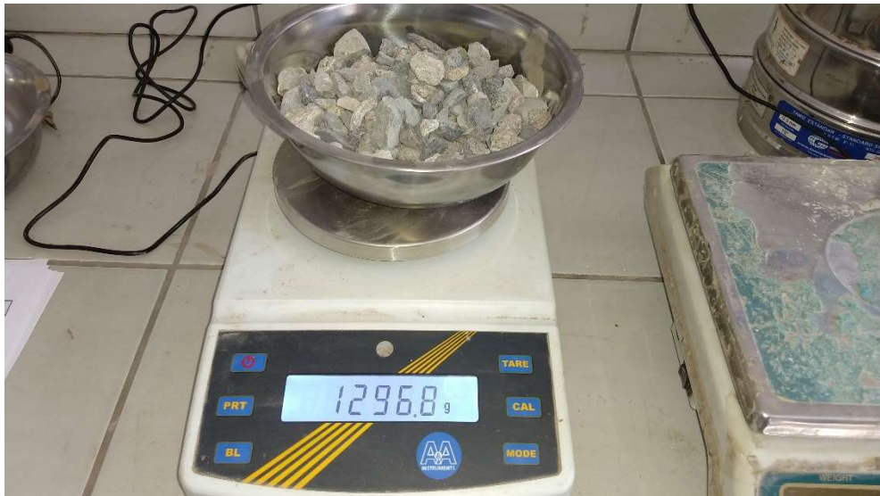
Fotografía N°05: Ensayo de humedad Natural del agregado Grueso, peso del recipiente + la muestra seca
