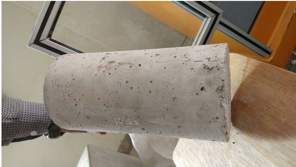
Fotografía N°44: Ensayos a la Compresión
