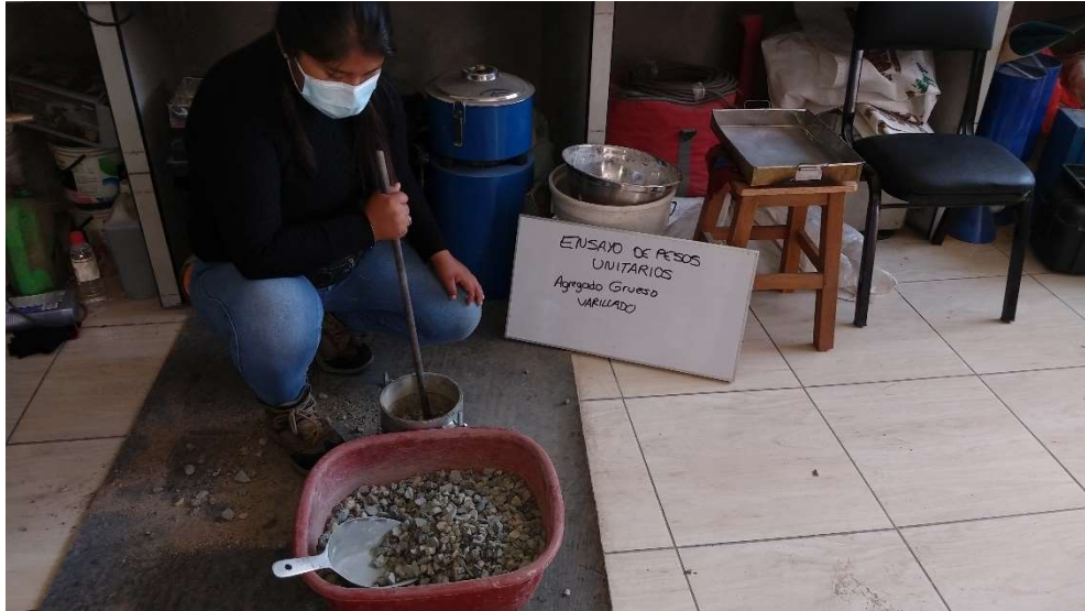
Fotografía N°15: Ensayo de pesos Unitarios Varillado – Agregado Grueso
