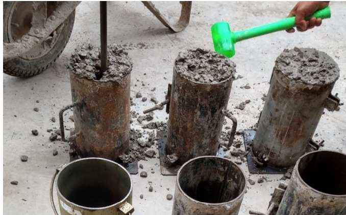
Figura N° 21 Elaboración de Probetas de concreto
