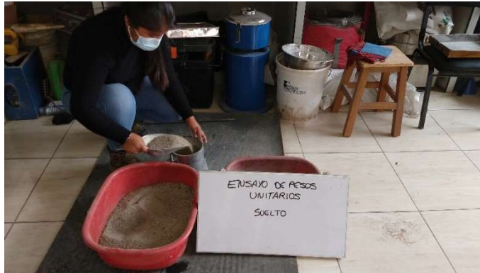
Figura N° 15 Ensayo de Pesos Unitarios Suelto
