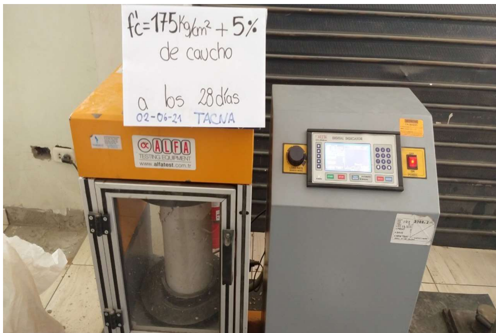
Fotografía N°42: Ensayos a la Compresión
