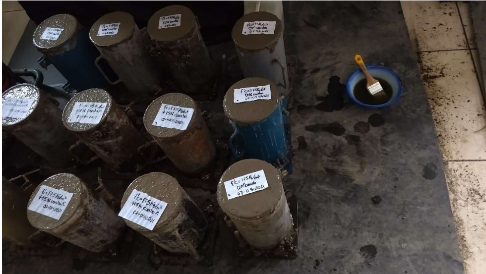
Fotografía N°27: Elaboración de probetas de concreto con 5% y 10% de caucho reciclado
