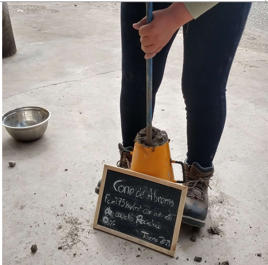
Fotografía N°28: Cono de Abrams f'_c = 175 \text{ kg/cm}^2 con 0% de adición de caucho reciclado (Patrón)
