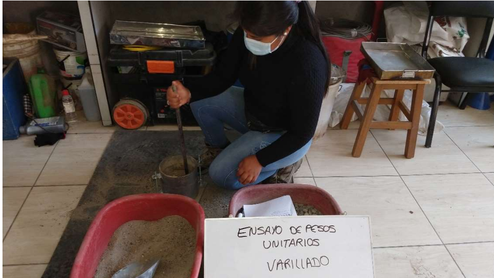
Fotografía N°13: Ensayo de pesos Unitarios Varillado – Agregado fino
