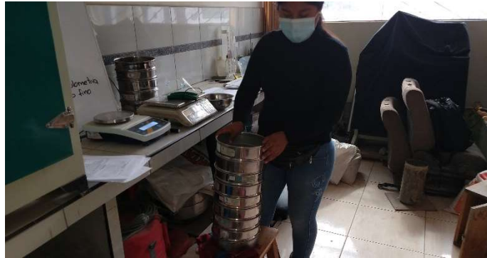
Figura N° 13 Tamizado del agregado fino
