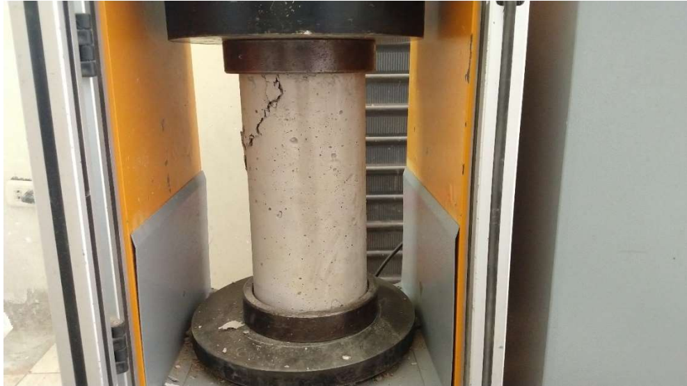
Fotografía N°43: Ensayos a la Compresión
