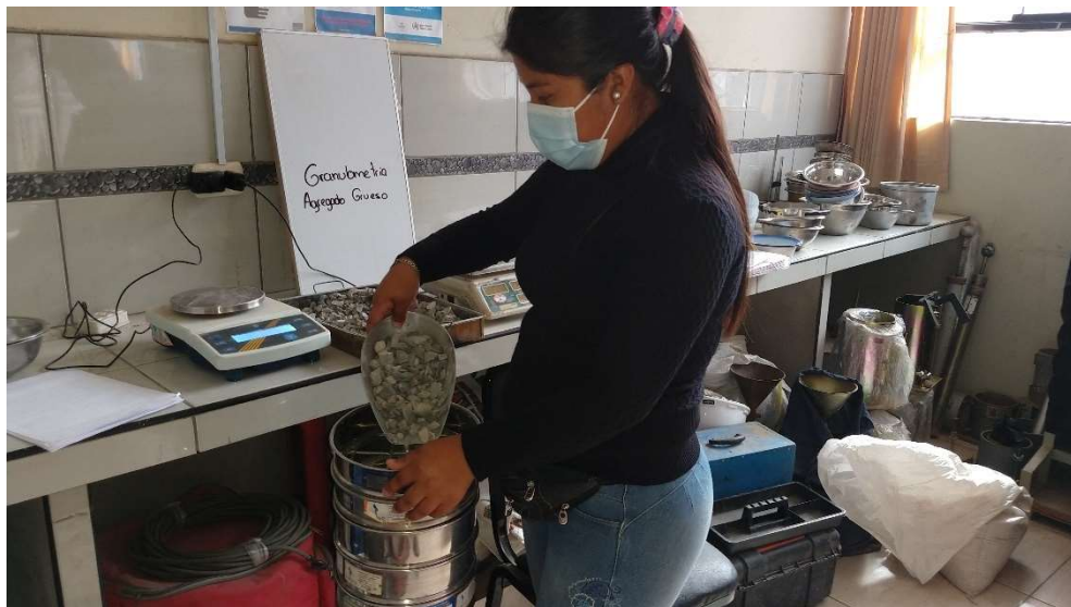
Fotografía N°10: Granulometría del agregado grueso (piedra chancada)
