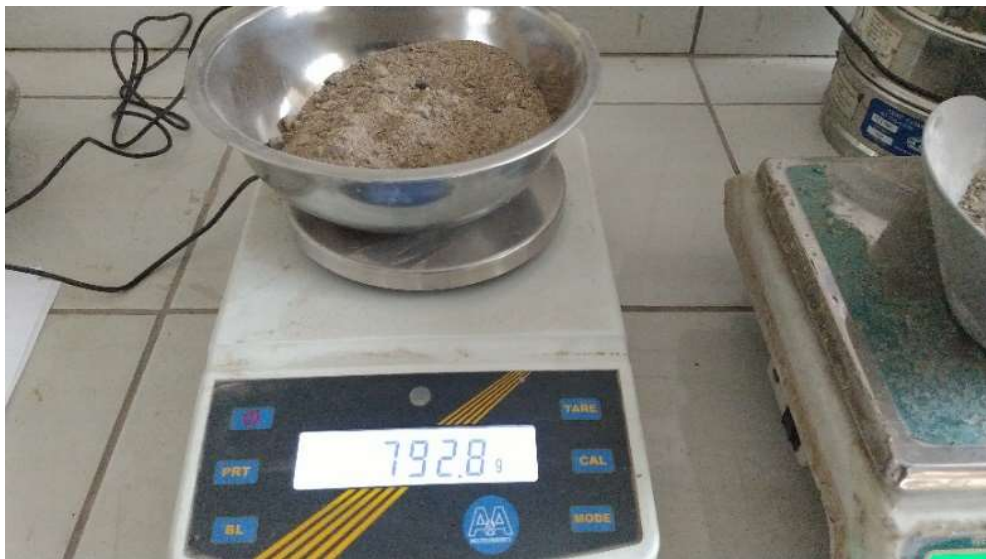
Fotografía N°02: Ensayo de humedad Natural del agregado fino, peso de recipiente + la muestra húmeda
