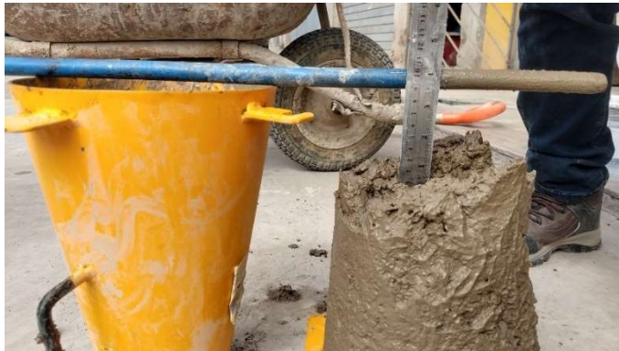
Figura N° 20 Cono de Abrams
