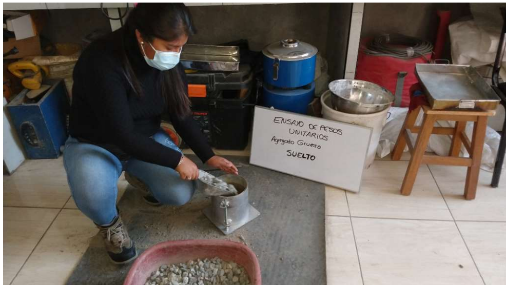
Fotografía N°14: Ensayo de pesos Unitarios Suelto – Agregado Grueso
