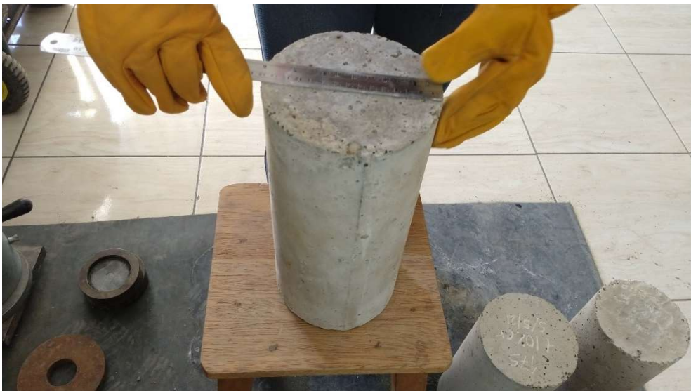
Fotografía N°36: Registro del diámetro de las probetas de concreto
