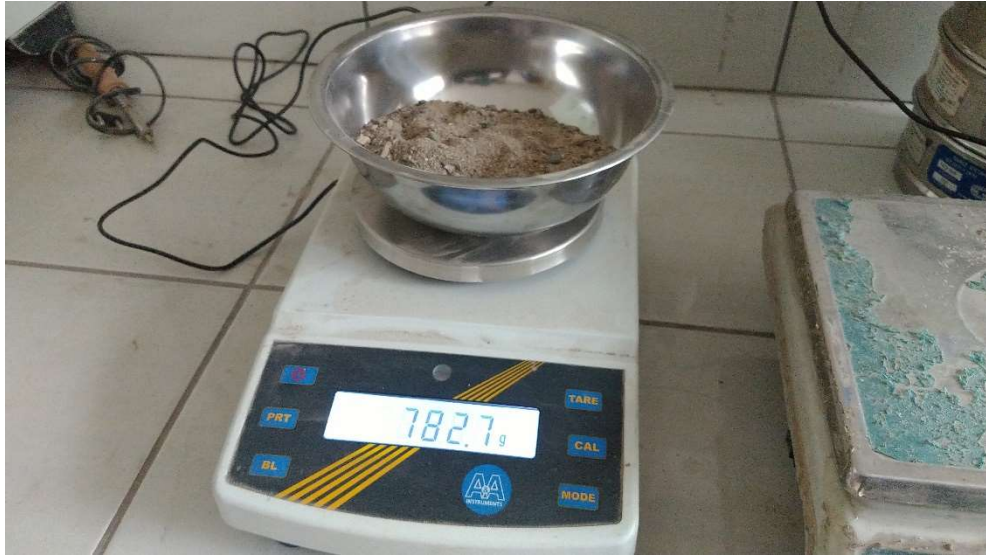
Fotografía N°03: Ensayo de humeda Natural del agregado fino, peso del recipiente + la muestra seca
