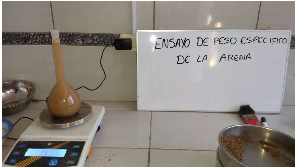
Fotografía N°17: Peso de fiola + muestra+ agua, para el ensayo de peso específico de la arena
