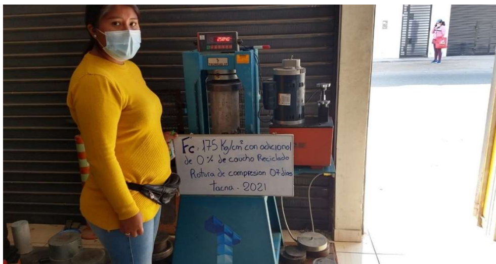
Fotografía N°40: Ensayos a la Compresión
