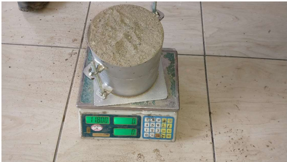
Fotografía N°12: Ensayo de pesos Unitarios Suelto – Agregado fino, peso del molde + la muestra seca
