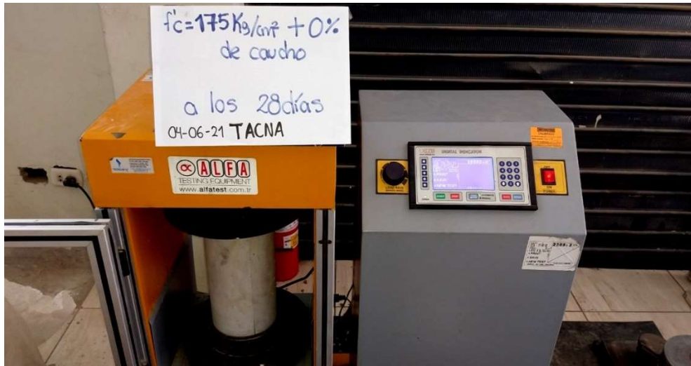
Fotografía N°41: Ensayos a la Compresión
