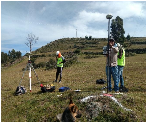
Figura 4: Trabajos en campo mediante (GNSS) Gps diferencial Trimble modelo R6 en el tramo de estudio Cachiñan Cruz de la paz L=1.6 Km.
