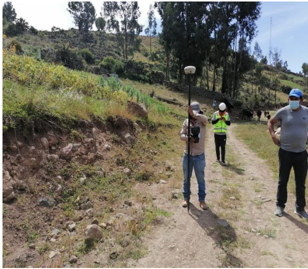
Figura 5: Levantamiento topográfico empleando el modo (RTK) Gps diferencial Trimble modelo R6
