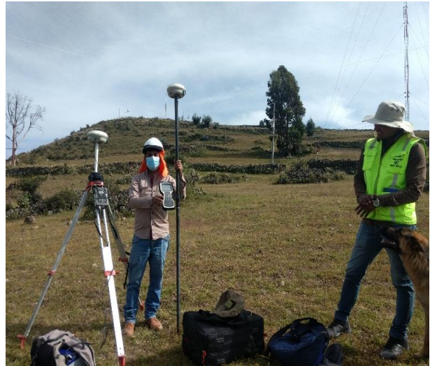
Figura 4: Trabajos en campo mediante (GNSS) Gps diferencial Trimble modelo R6 en el tramo de estudio Cachiñan Cruz de la paz L=1.6 Km.
