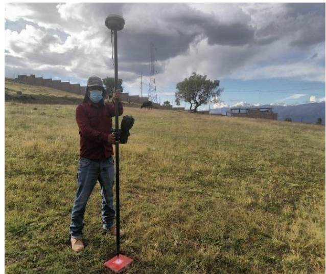
Figura 6: Trabajos en campo mediante drone Dji Phantom 4 pro y (GNSS) para los puntos de foto control en el tramo de estudio Cachiñan Cruz de la paz L=1.6 Km
