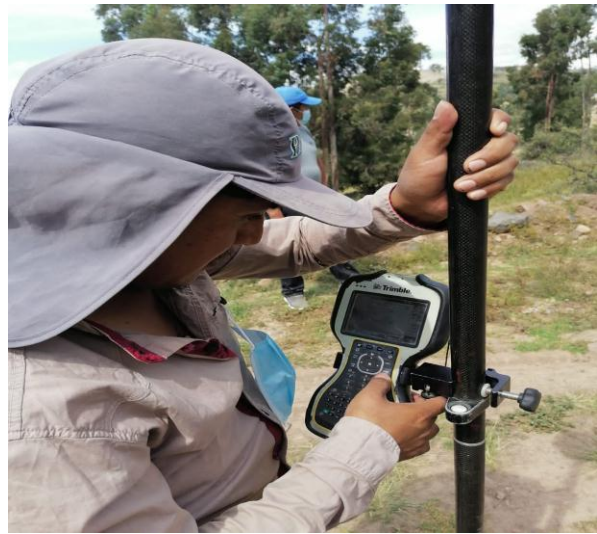
Figura 5: Levantamiento topográfico empleando el modo (RTK) Gps diferencial Trimble modelo R6
