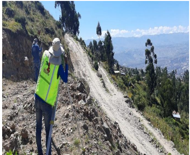
Figura 3: Levantamiento topográfico mediante estación total Leica Ts 06 plus en el tramo de estudio
