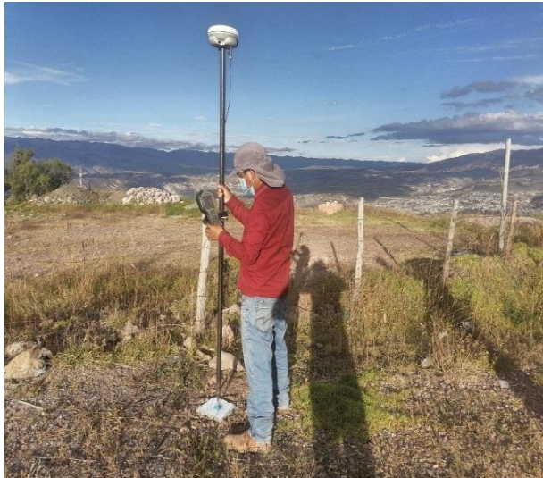
Figura 6: Trabajos en campo mediante drone Dji Phantom 4 pro y (GNSS) para los puntos de foto control en el tramo de estudio Cachiñan Cruz de la paz L=1.6 Km
