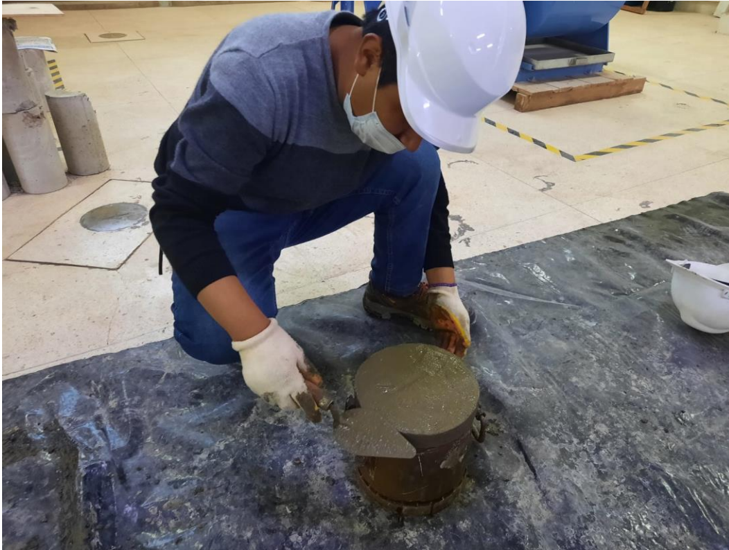
Fotografía 23. Vertido de concreto en molde y enrasado
