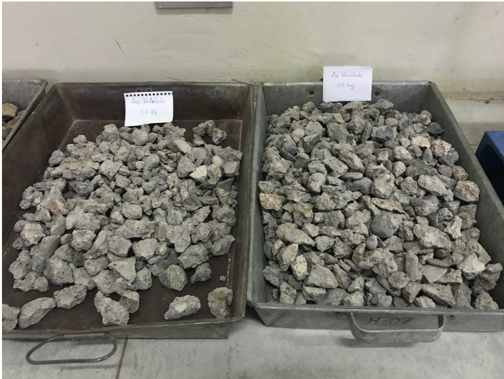
Figura 19. Combinaciones de agregado reciclado con agregado natural.
