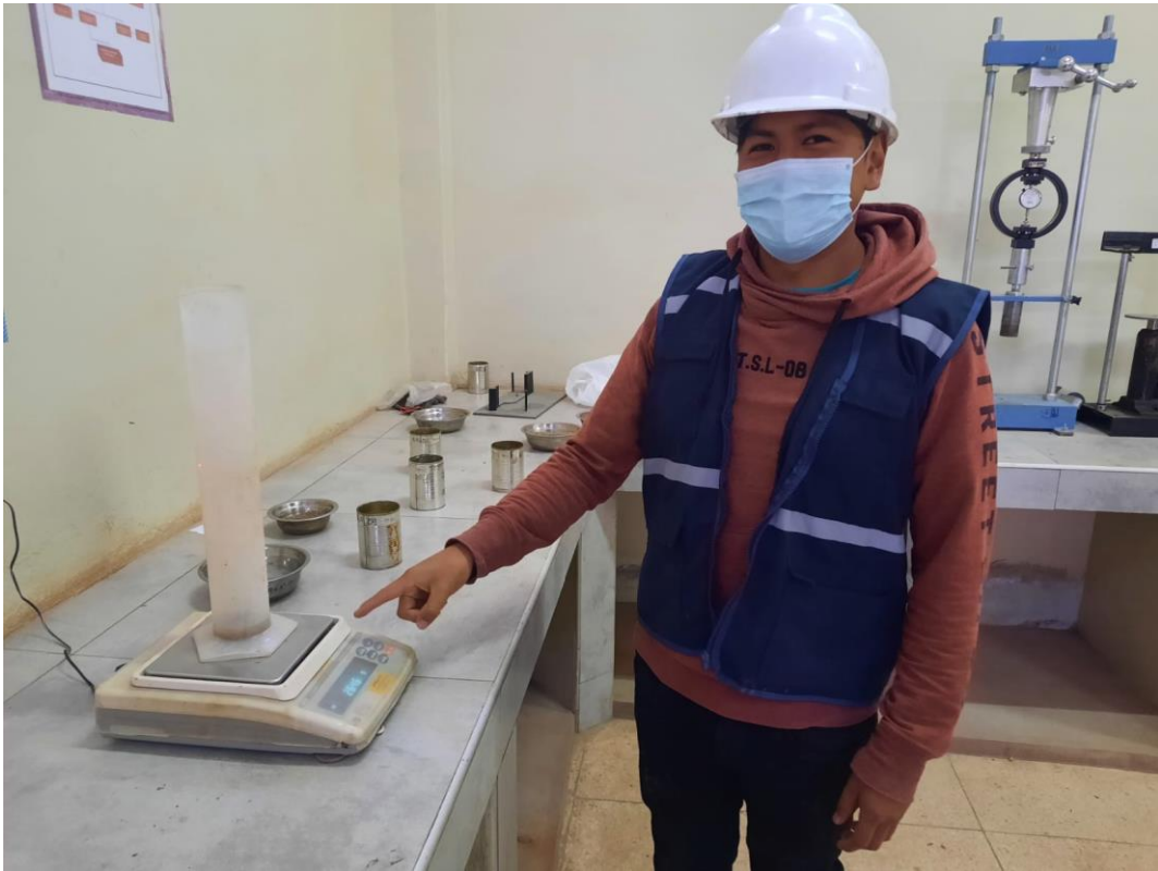
Fotografía 26. Peso del agua exudada y probeta.
