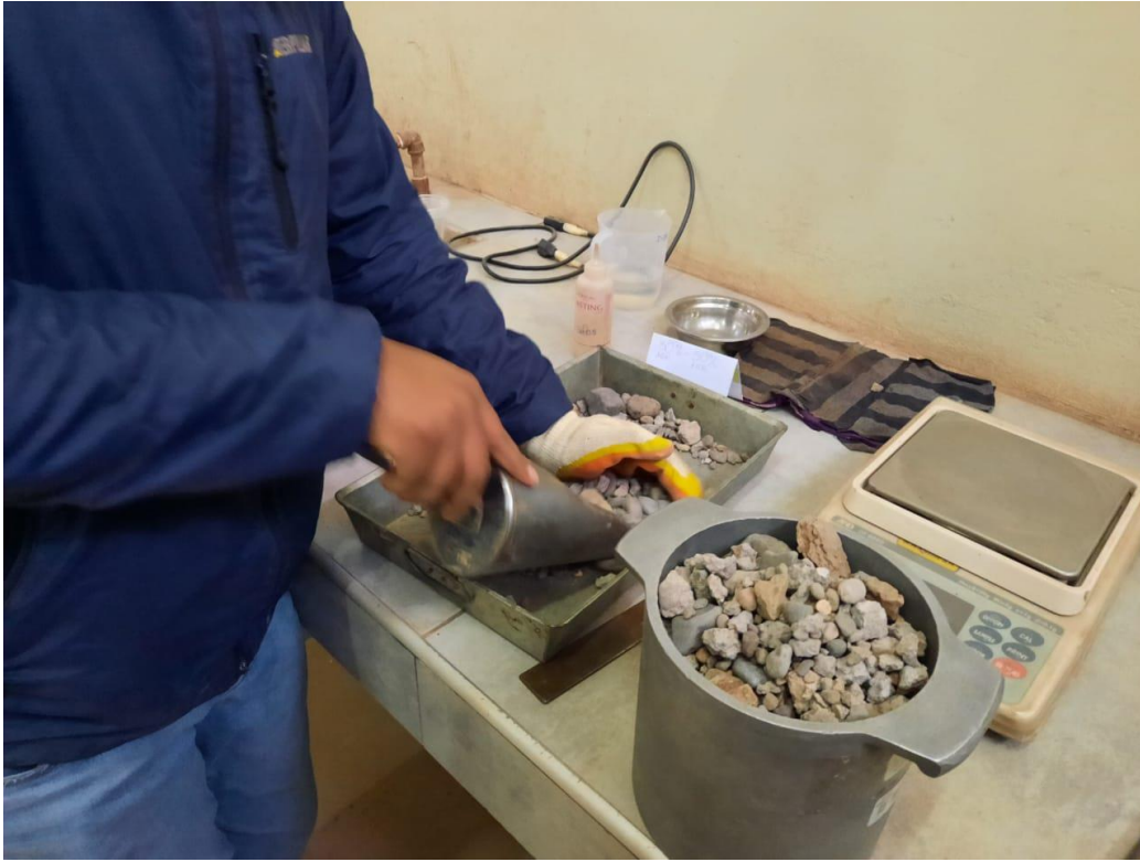
Fotografía 19. Vertido del material para la obtención del peso unitario suelto
