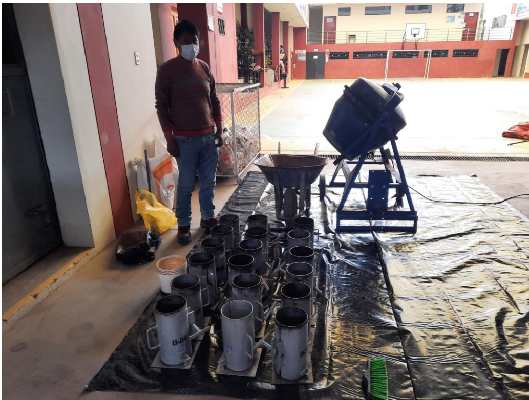
Fotografía 30. Preparación de los equipos para el vertido de concreto en las briquetas.
