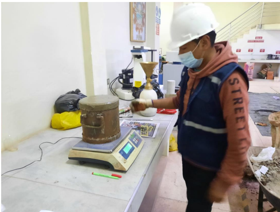
Figura 40. Pesaje del recipiente y la mezcla de concreto.
