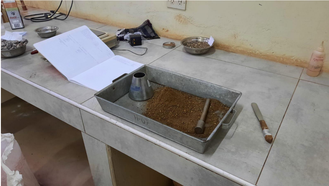
Fotografía 13. Consistencia del agregado fino.
