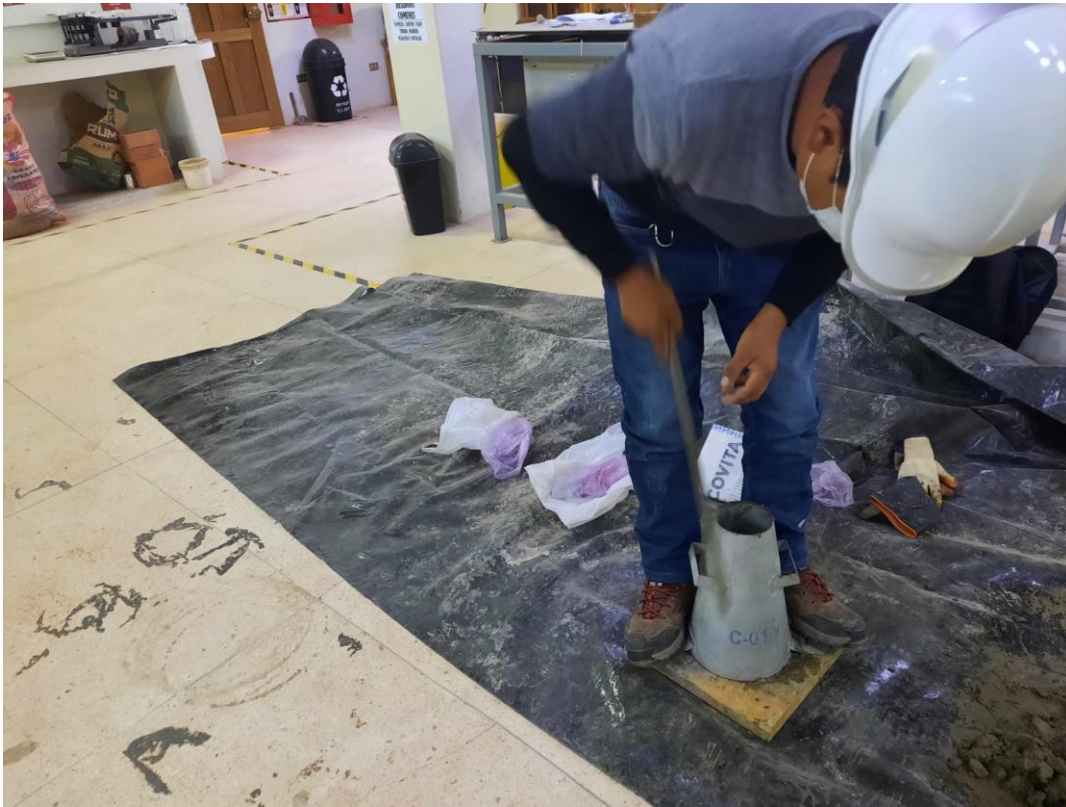
Fotografía 27. Varillado del concreto para la obtención del asentamiento
