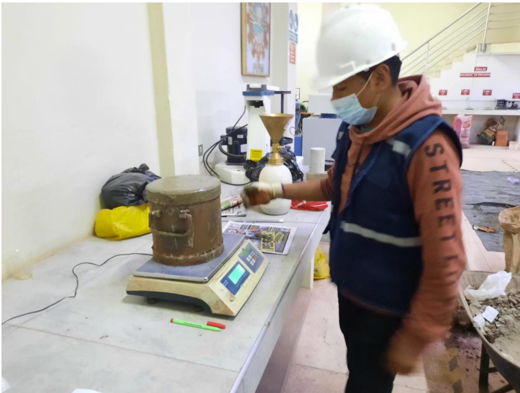
Fotografía 24. Pesado de concreto con el molde para la determinación del peso unitario del concreto.
