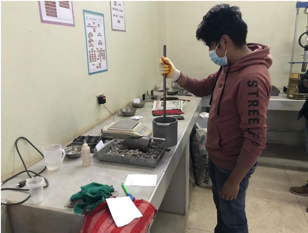
Figura 33. Compactado del agregado.
