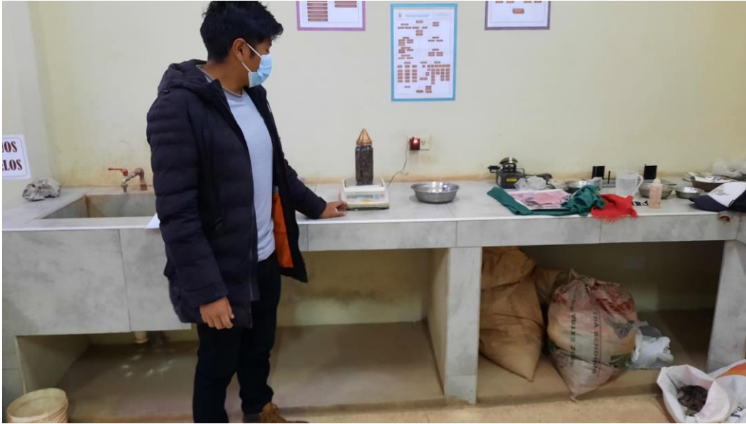
Fotografía 17. Pesado de material para la obtención del peso específico, por el método del picnómetro.
