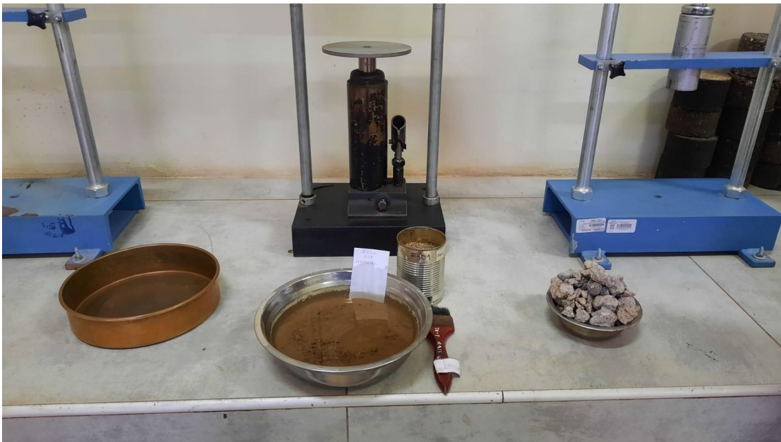
Fotografía 14. Saturación de agregado fino
