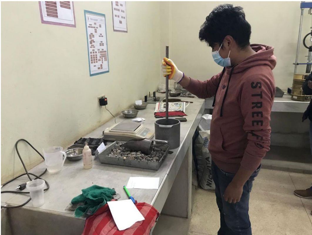
Fotografía 18. Apisonado del material para la obtención del peso unitario varillado.
