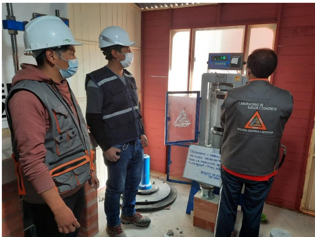
Figura 47. Rotura de briquetas a compresión.
