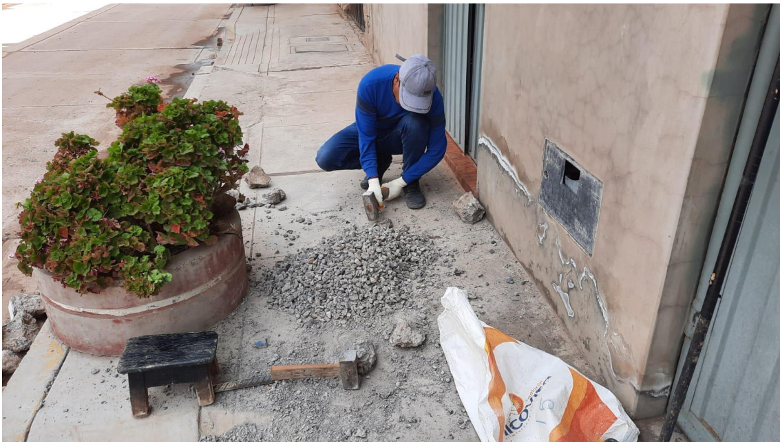
Fotografía 6. Trituración final, tamaño máximo \frac{3}{4} "
