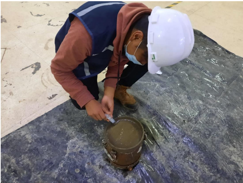
Figura 45. Extracción del agua por exudación del concreto.
