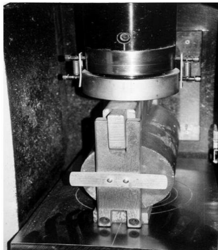
Figura 10. Probeta lista para el ensayo de tracción indirecta
