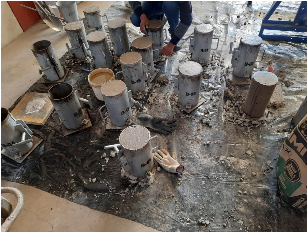
Fotografía 33. Desmolde de probetas de concreto
