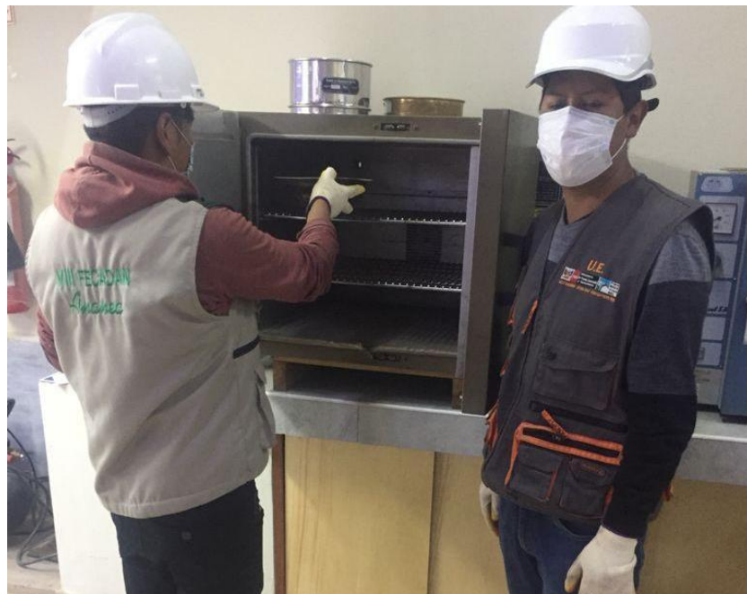
Figura 29. Secado de la muestra en el horno.
