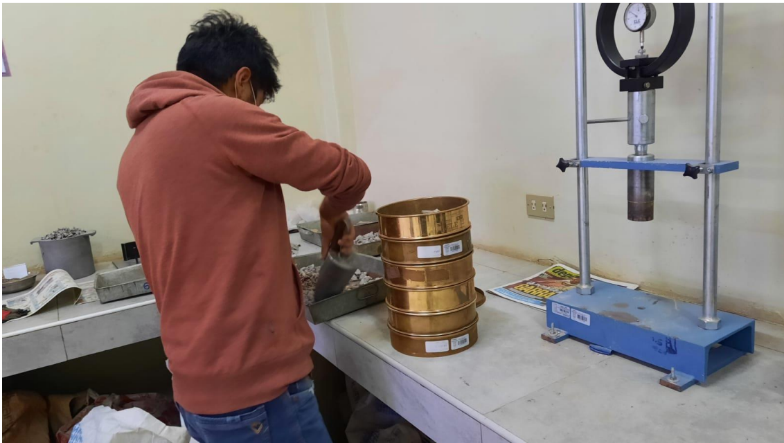
Fotografía 10. Análisis granulométrico por tamizado.
