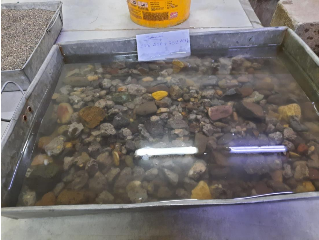
Fotografía 15. Saturación de agregado reciclado en combinación con agregado natural
