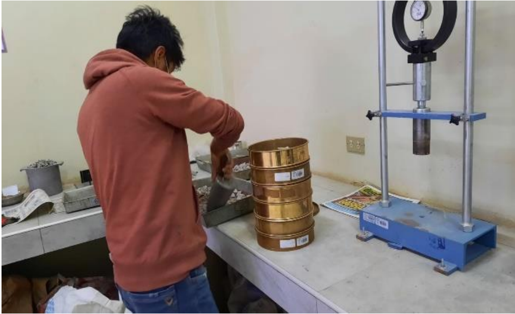
Figura 20. Tamizado del agregado grueso combinado.
