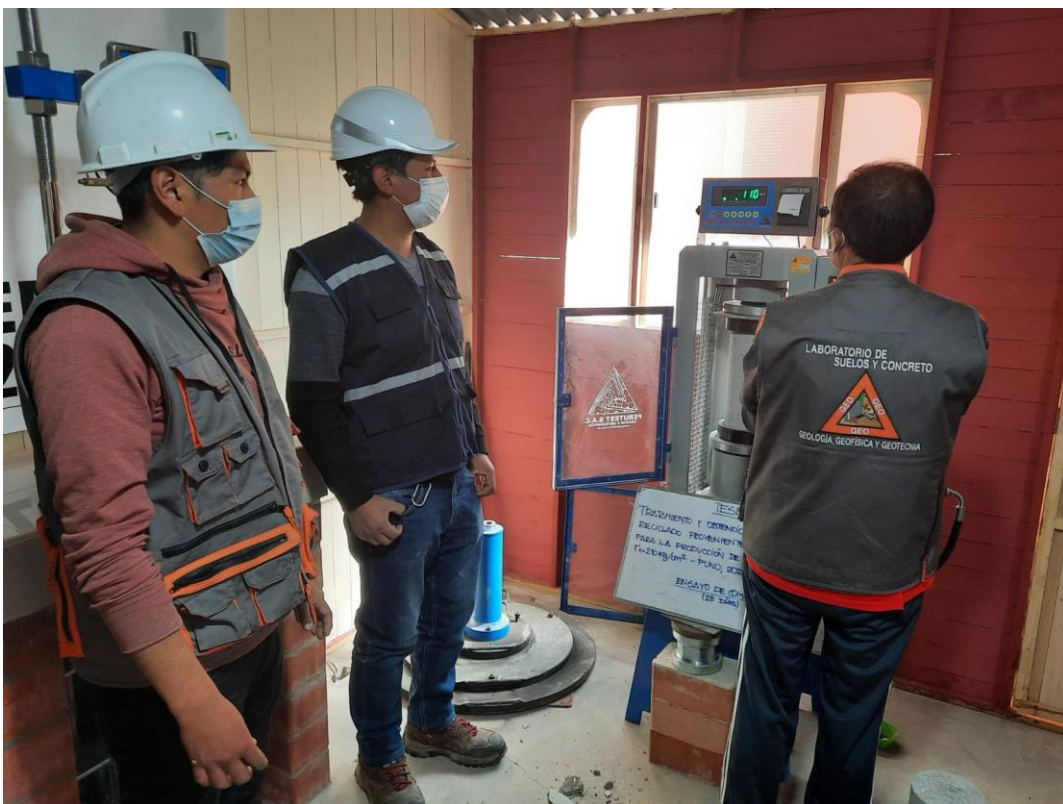
Fotografía 36. Ensayo de resistencia a la compresión
