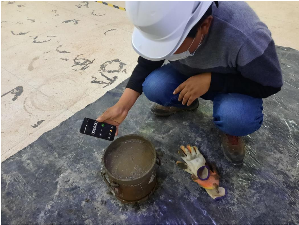
Figura 45. Extracción del agua por exudación del concreto.
