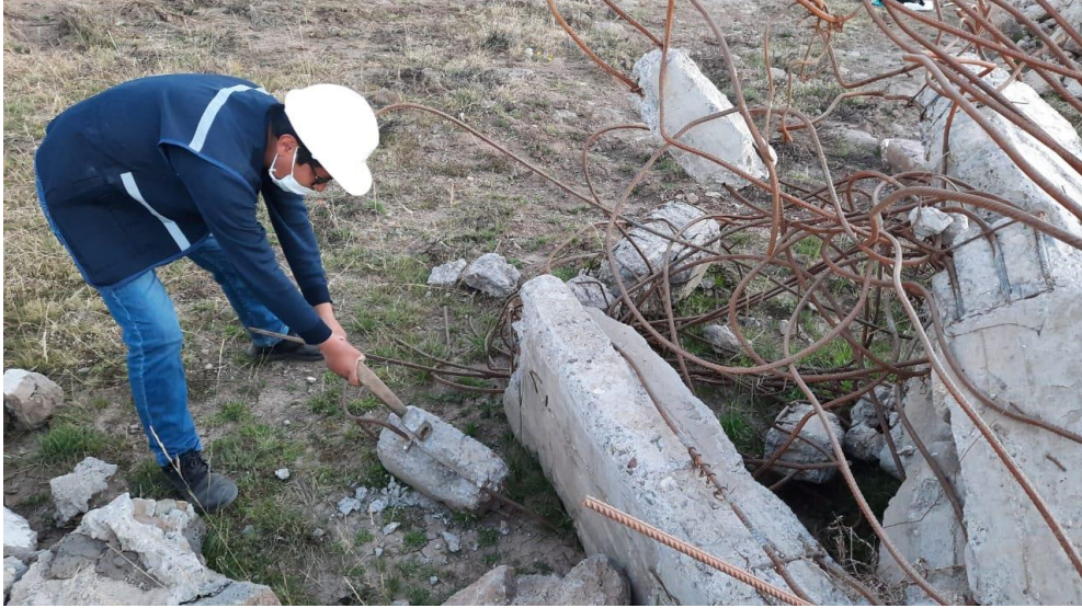
Figura 15. Trituración de forma manual hasta obtener muestras de 4 a 5 pulgadas.
