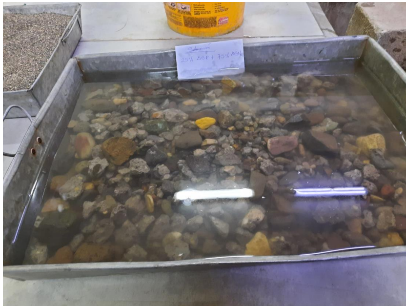
Figura 28. Saturado del agregado grueso por 24 horas.
