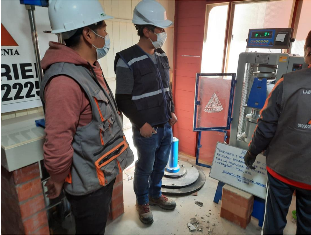
Fotografía 37. Ensayo de resistencia a la tracción indirecta.
