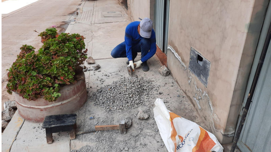
Figura 17. Trituración manual hasta obtener que la muestra sea menos a 1”.
