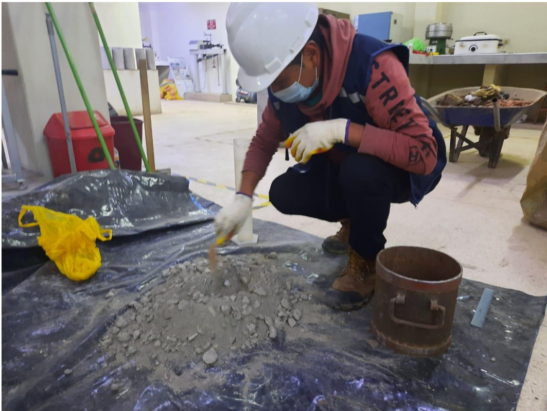
Fotografía 22. Preparación de la mezcla para la determinación del peso unitario
