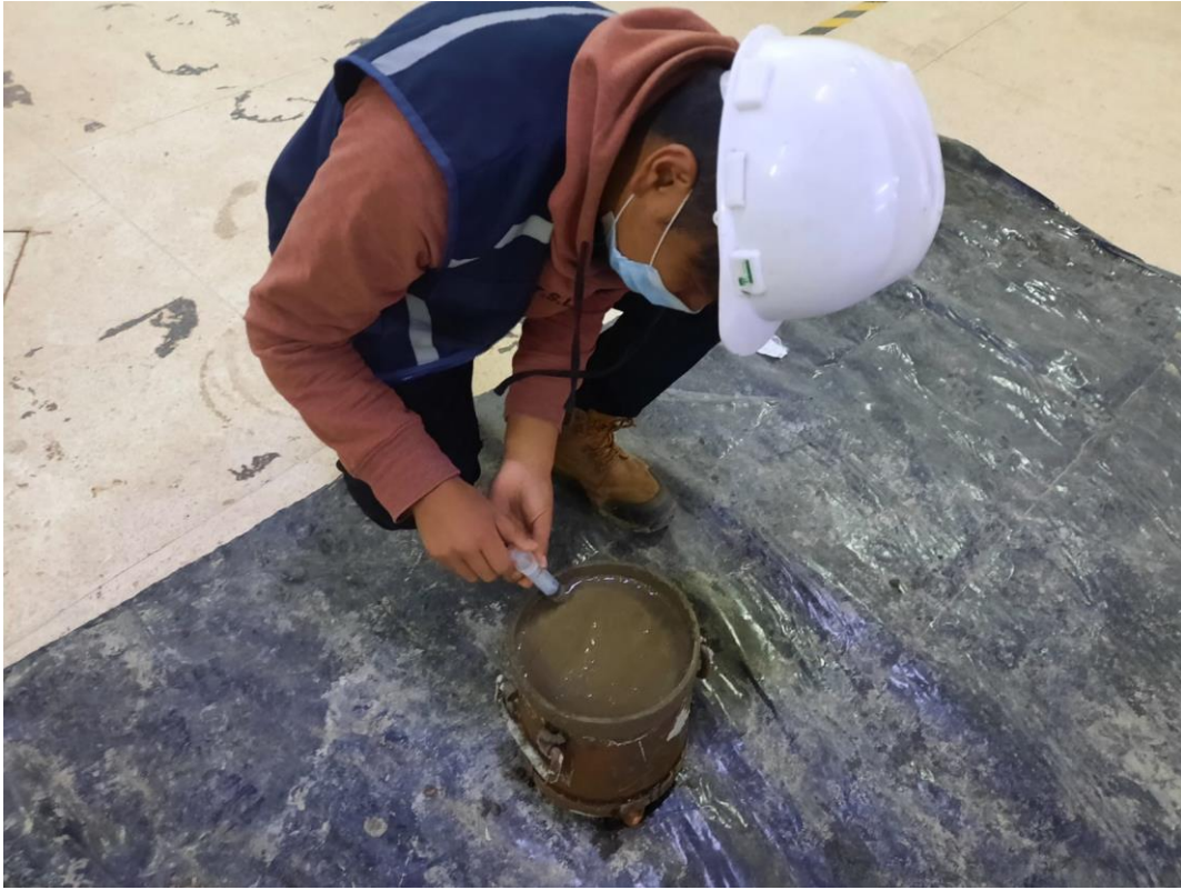
Fotografía 25. Extracción de agua exudada.
