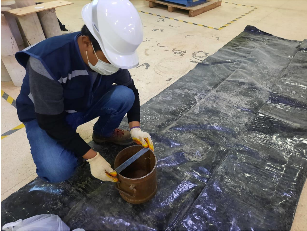
Fotografía 21. Dimensión del molde para el ensayo de peso unitario del concreto
