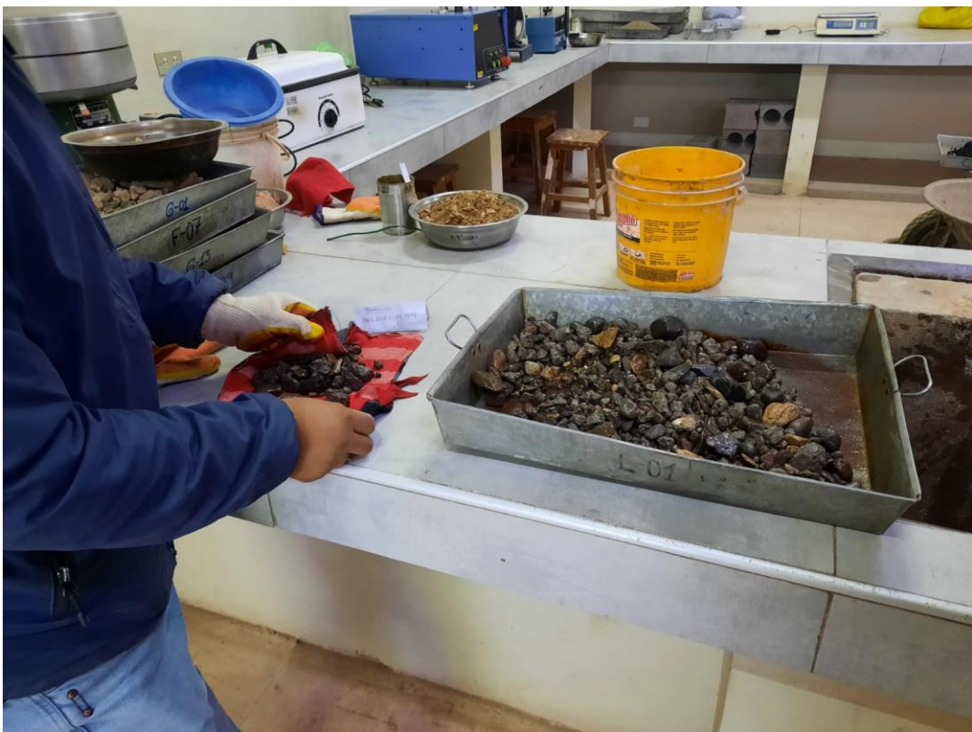
Fotografía 15. Saturación de agregado reciclado en combinación con agregado natural
