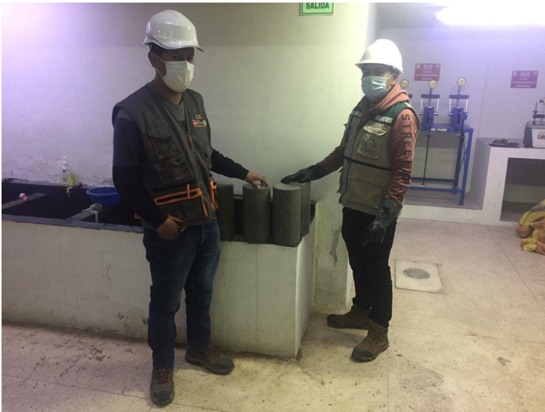
Fotografía 35. Extracción de las probetas para realizar su rotura.
