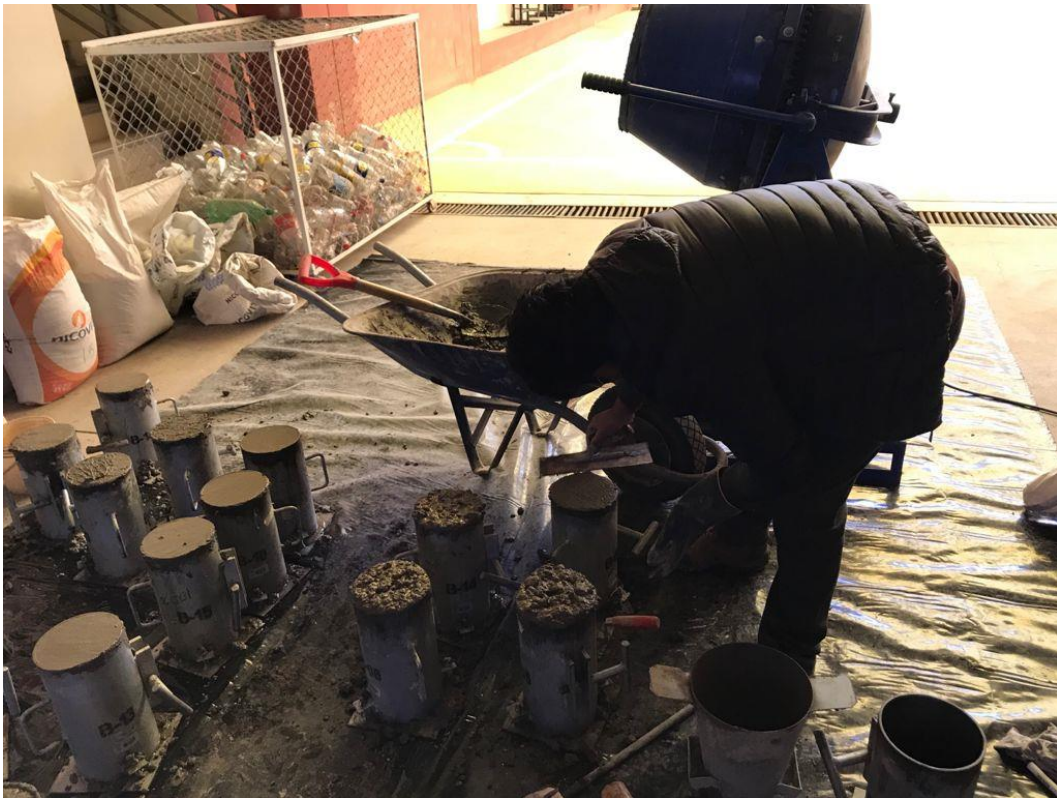
Fotografía 32. Vertido de concreto en briquetetas.
