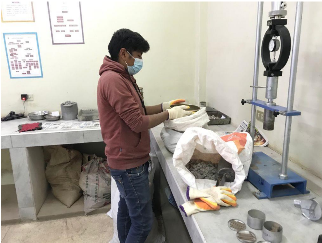
Fotografía 8. Separación del agregado grueso reciclado del material fino, con malla N°4.
