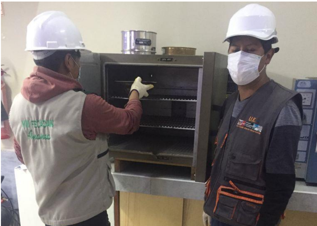
Fotografía 20. Secado de la muestra en horno para la obtención del contenido de humedad.
