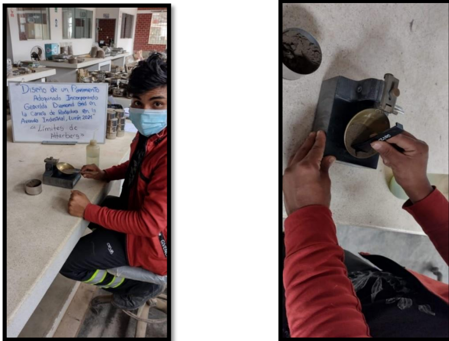
Figura 62. Elaboración del ensayo Límites de consistencia.
