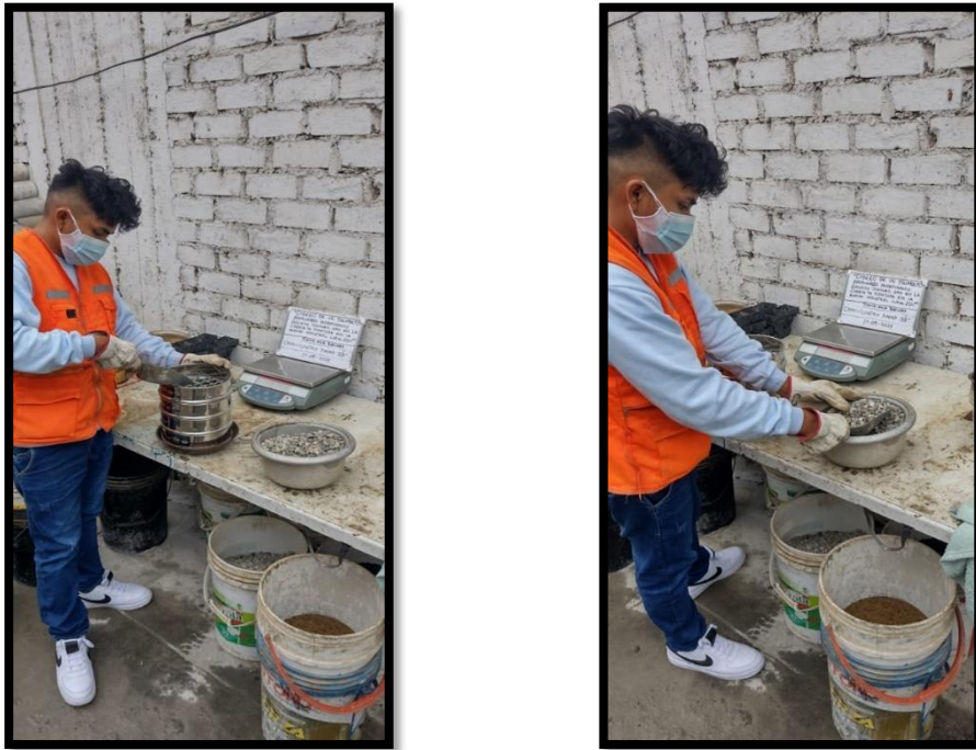
Figura 67. Elaboración del análisis granulométrico del agregado fino.
