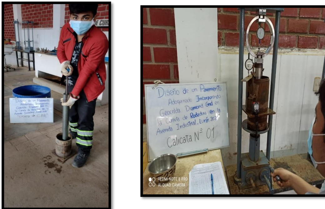
Figura 65. Elaboración del ensayo CBR.
