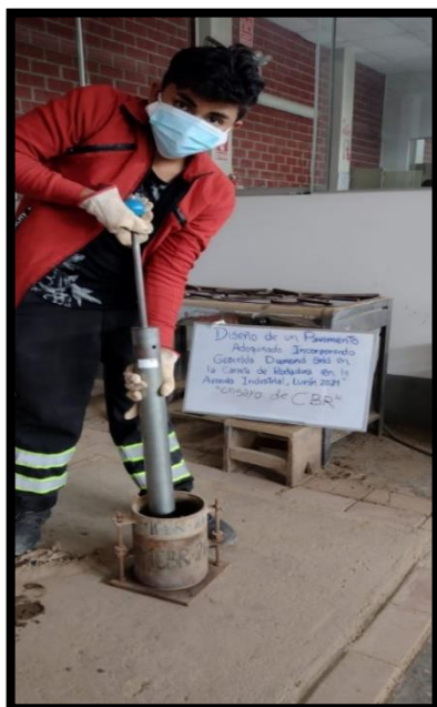
Figura 19. Desarrollo del ensayo de CBR.( Elaboración propia).
