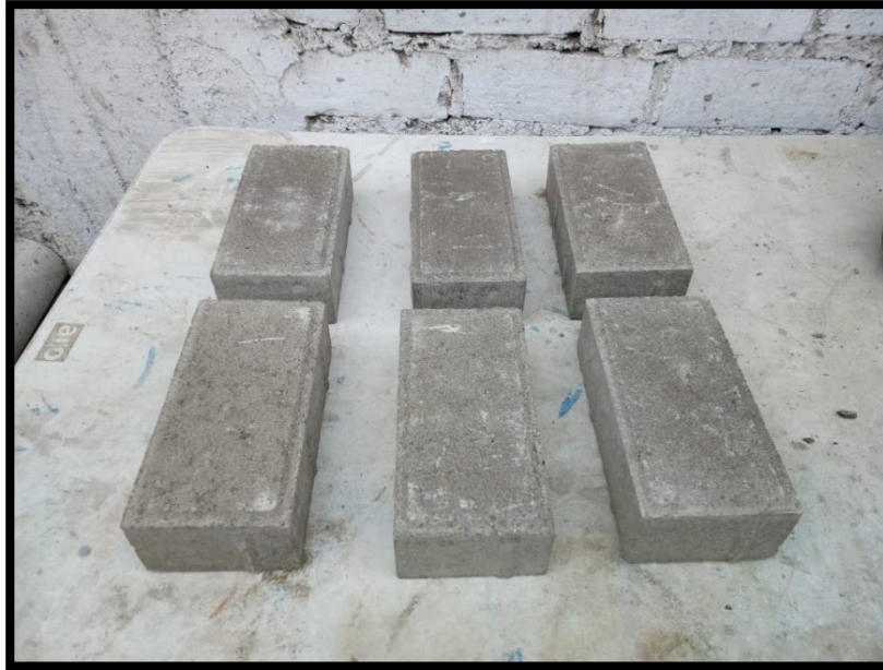
Figura 39. Probetas de adoquín tipo I (Laboratorio quality control express s.a.c)
