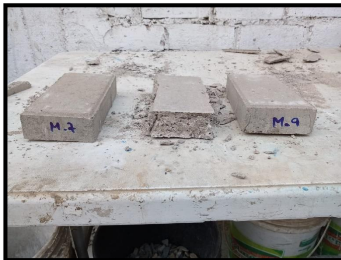
Figura 71. Resistencia a la compresión. – Adoquín Tipo I ( 3, 7 y 28 días.)
