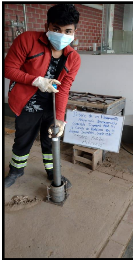
Figura 17. Elaboración del ensayo de Proctor Modificado.(Elaboración propia).
