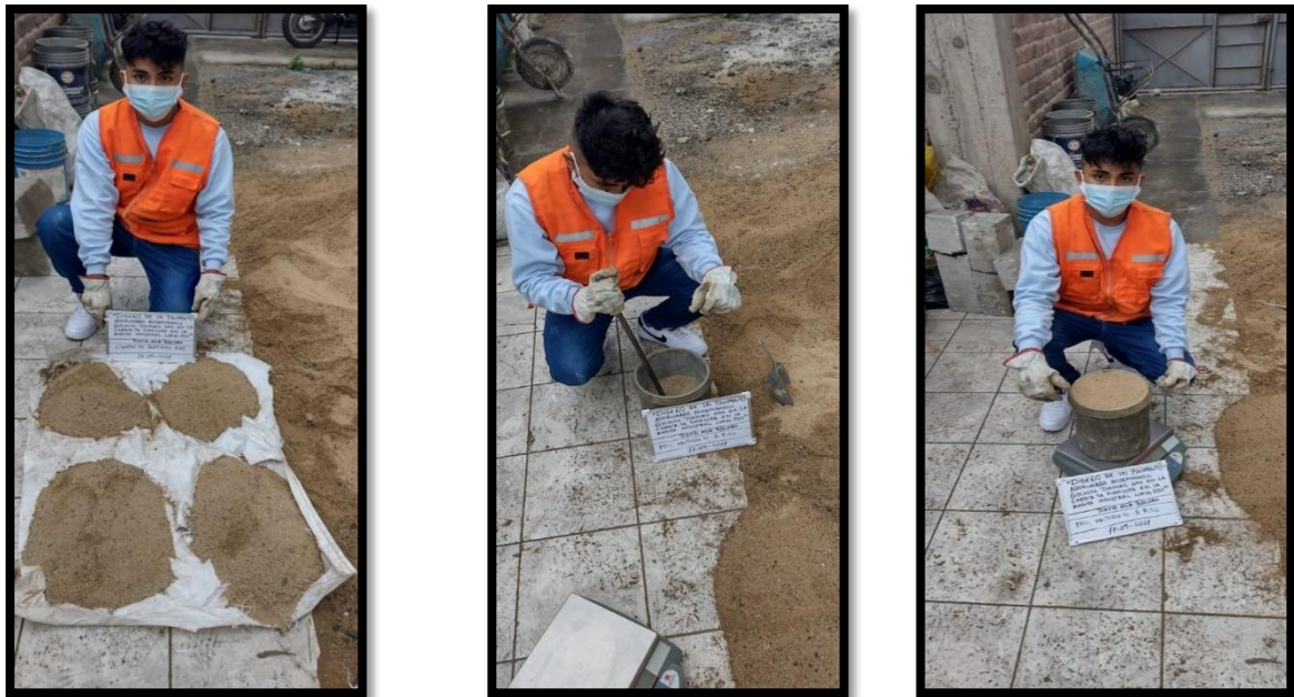
Figura 69. Elaboración del ensayo peso unitario del agregado fino.
