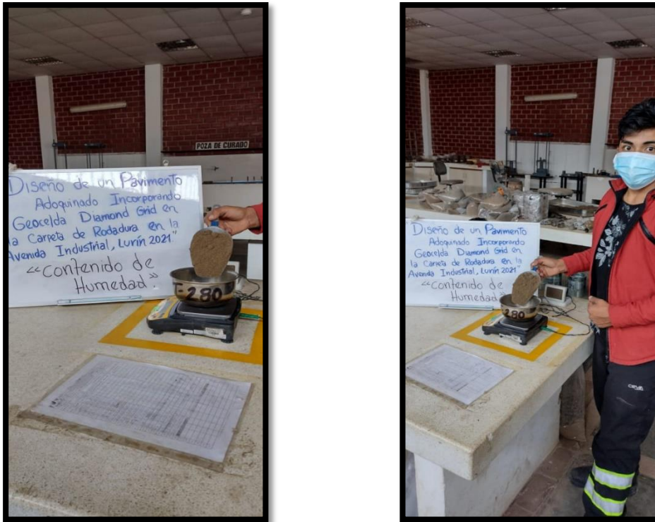
Figura 61. Elaboración del ensayo Contenido de humedad.
