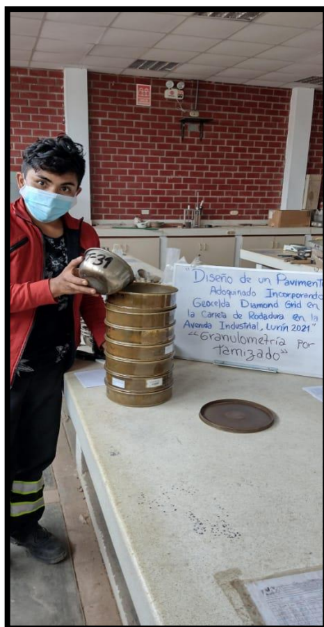
Figura 12. Elaboración del análisis granulométrico.(Elaboración propia).
