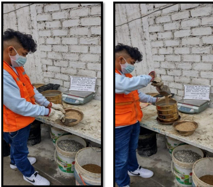
Figura 66. Elaboración del análisis granulométrico del agregado fino
