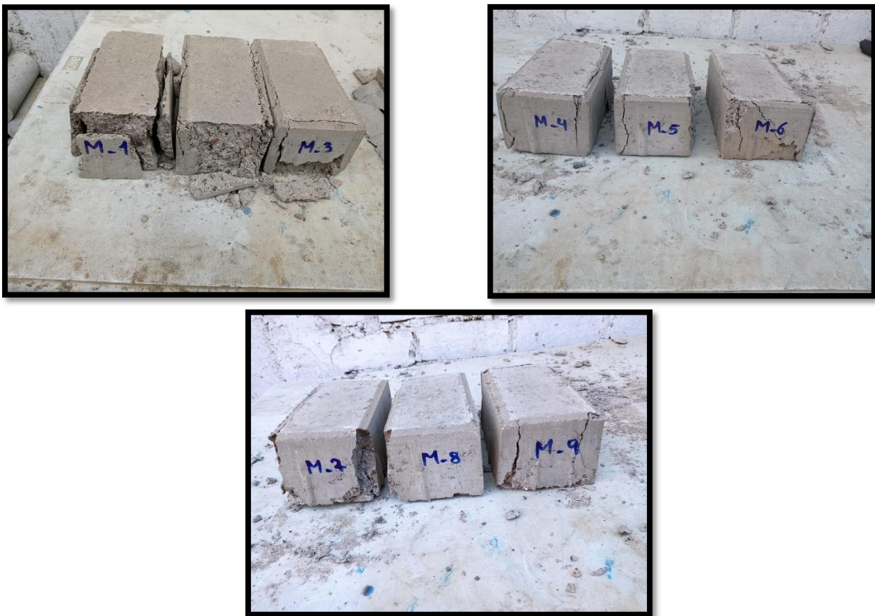
Figura 70. Resistencia a la compresión. – Adoquín Tipo III ( 3, 7 y 28 días.)
