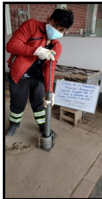
Figura 64. Elaboración del ensayo Proctor modificado.
