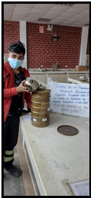
Figura 63. Elaboración del ensayo Granulométrico por tamizado.
