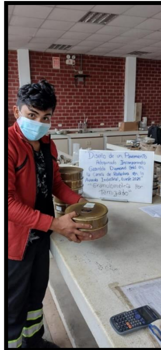
Figura 63. Elaboración del ensayo Granulométrico por tamizado.
