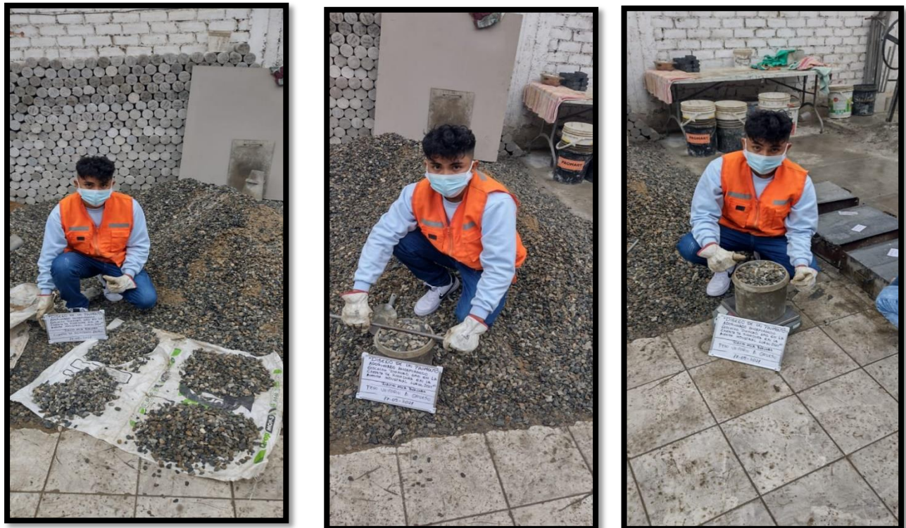
Figura 67. Elaboración del análisis granulométrico del agregado fino.
