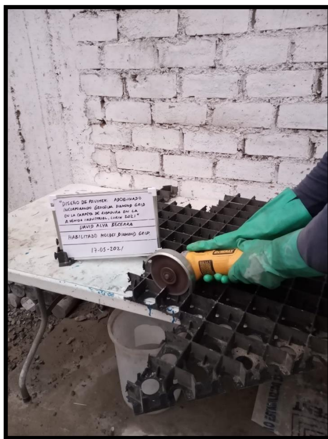
Figura 41. Habilitación de moldes de Diamond Grid (Laboratorio quality control express s.a.c) Una vez habilitado los moldes de Diamond Grid, se procedió al vaciado del concreto.
