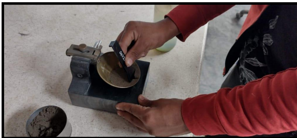
Figura 15. Elaboración del ensayo de Copa de Casagrande.(Elaboración propia).
