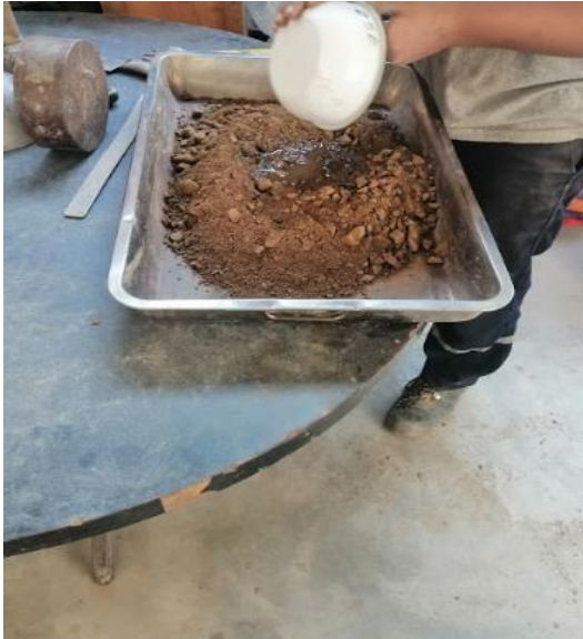
Figura 55 : realizando la mezcla CBR
