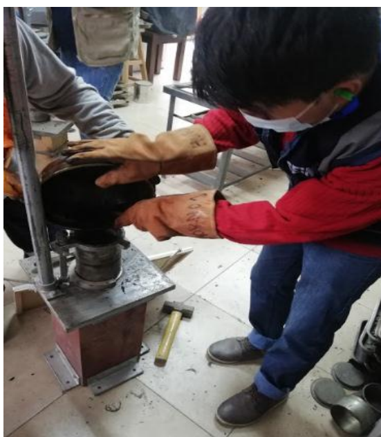
Figura 23 : Elaboración Marshall para la mezcla asfáltica
