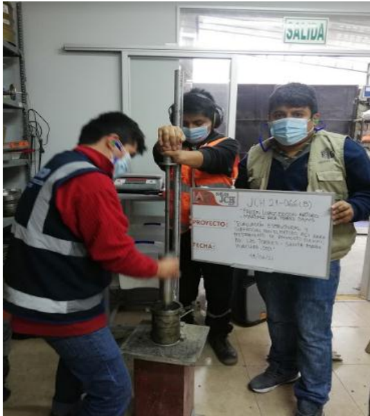
Figura63: Realizando la Compactación
