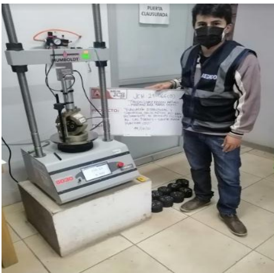
Figura 27: Rotura de las Briquetas
