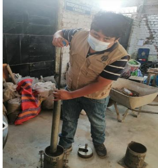
Figura 56: Realizando la compactación
