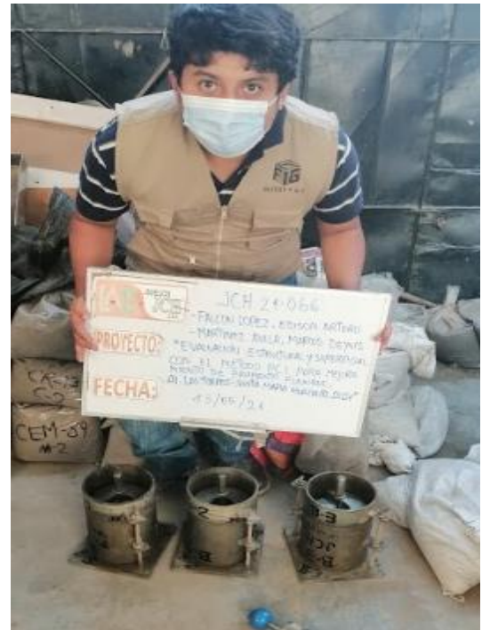
Figura 58 : CBR Y Proctor
