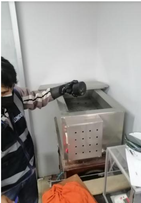
Figura 65 : Llevando a baño María la briqueta por 30 min
