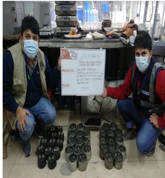
Figura 64 : Realizado las Briquetas convencional y con el caucho de 3% y 7%
