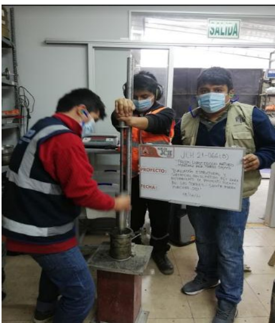
Figura 24 : Elaboración Marshall para la mezcla asfáltica
