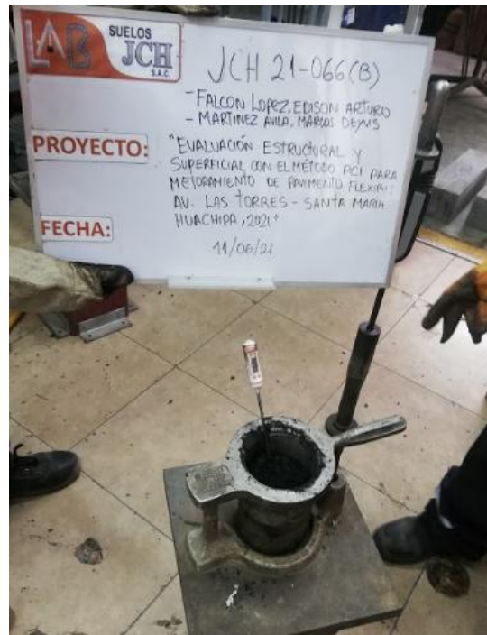
Figura 62: Midiendo la temperatura antes de la compactación
