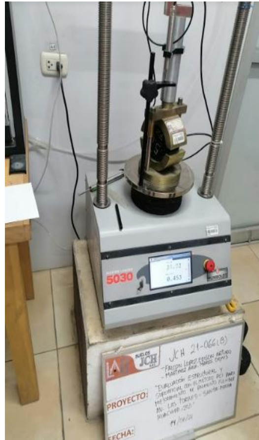
Figura68 : Rotura de las briquetas
