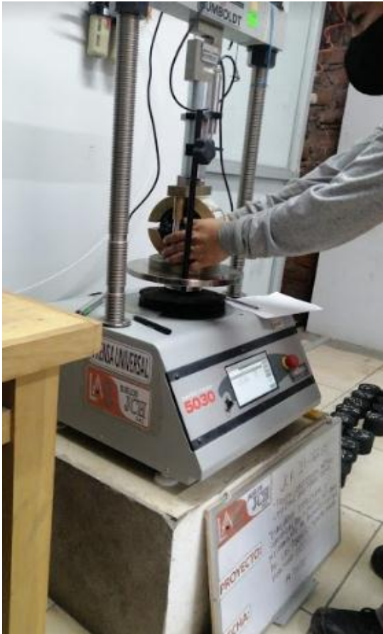
Figura 67 : Rotura de las briquetas
