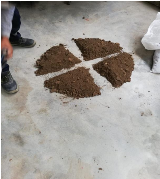
Figura 51: Realizando el cuarteo
