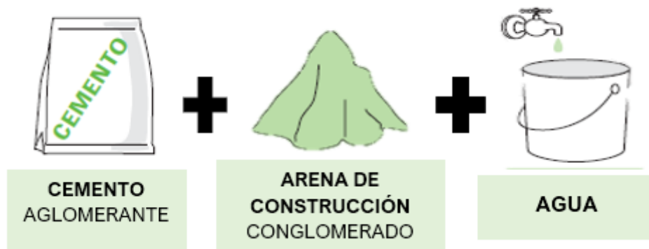
Figura 1. Composición del mortero
