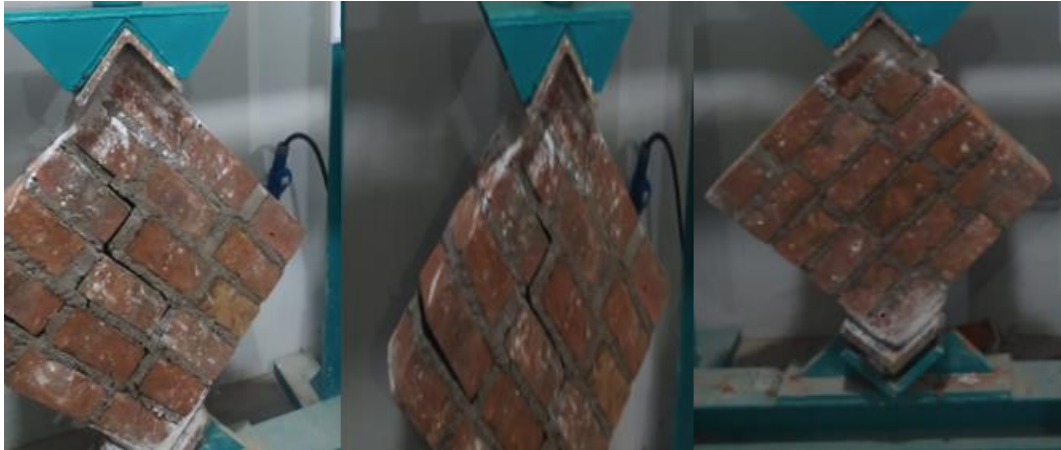
Figura 68 Ensayo a compresión diagonal murete patrón a 14 días.
