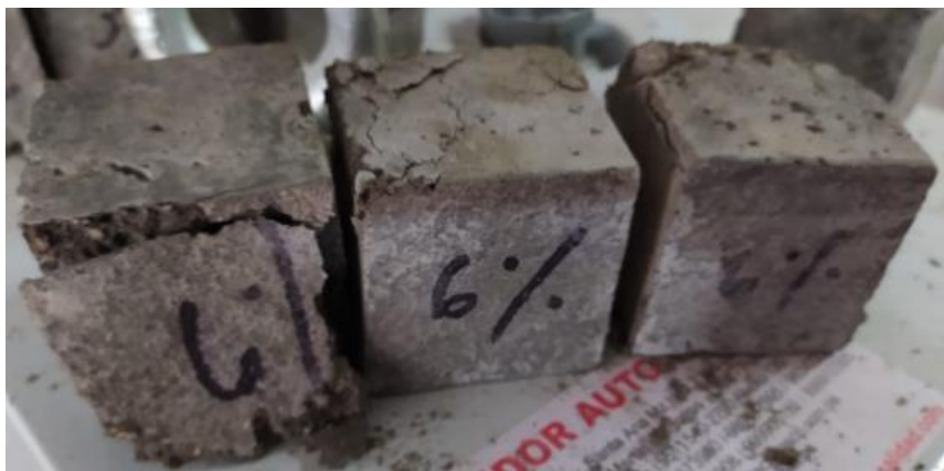
Figura 40 Rotura en la muestra experimental con 6% de ceniza en el periodo de 7 días.
