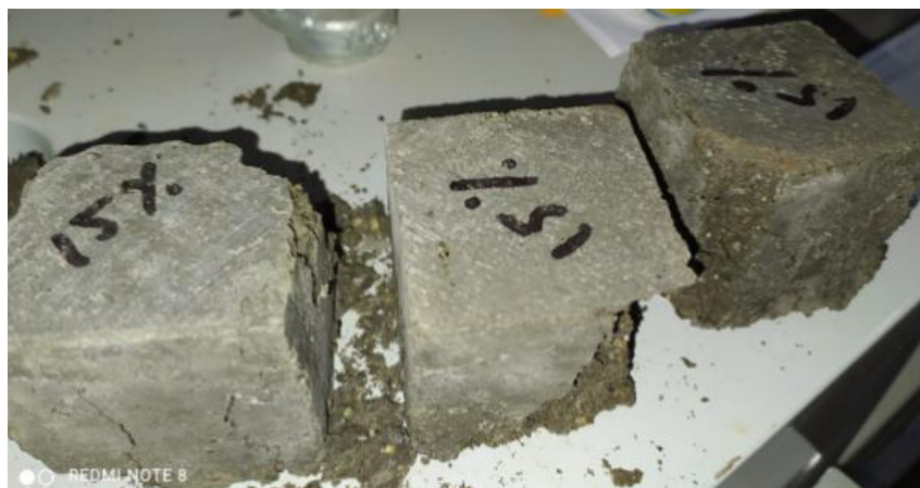
Figura 42 Rotura en la muestra experimental con 15% de ceniza en el periodo de 7 días.
