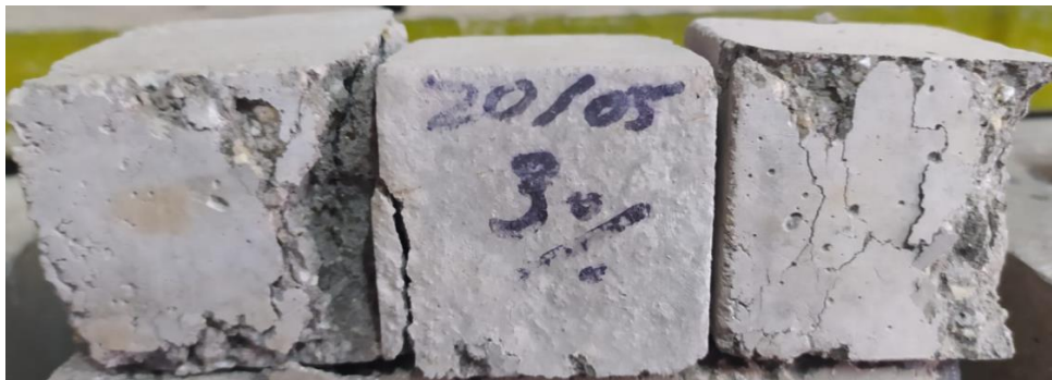
Figura 61 Rotura de la muestra experimental adicionando 3% de ceniza de caña a los 28 días.
