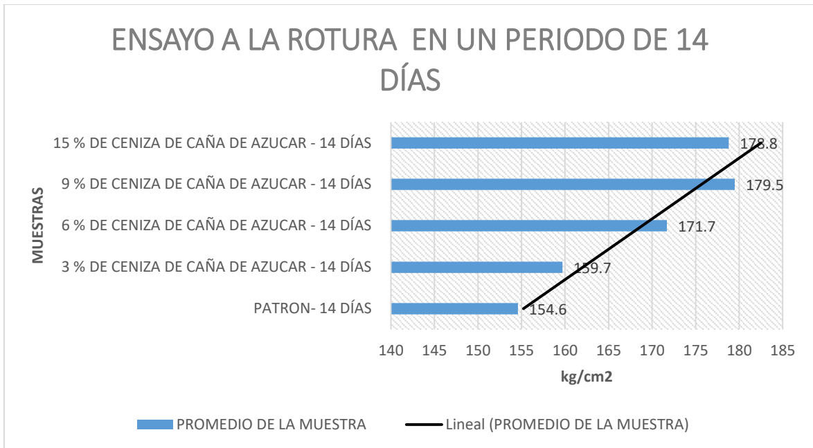
Figura 48 Resultado de las resistencias a compresión a los 14 días del mortero patrón y del mortero experimental.
