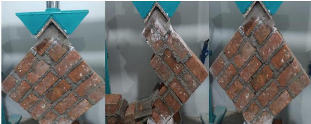
Figura 69 Ensayo a compresión diagonal murete patrón adicionando 6% de ceniza de caña a la edad de 14 días.
