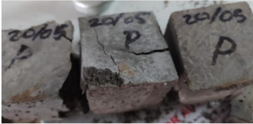
Figura 38 Rotura en la muestra patrón en el periodo de 7 días.
