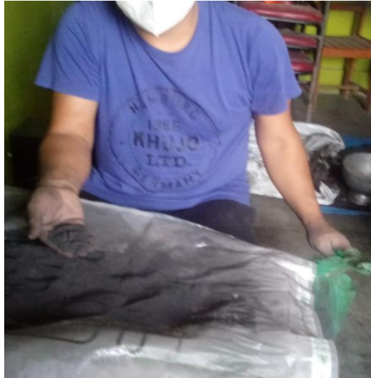
Figura 25. tamizado de ceniza de bagazo.
