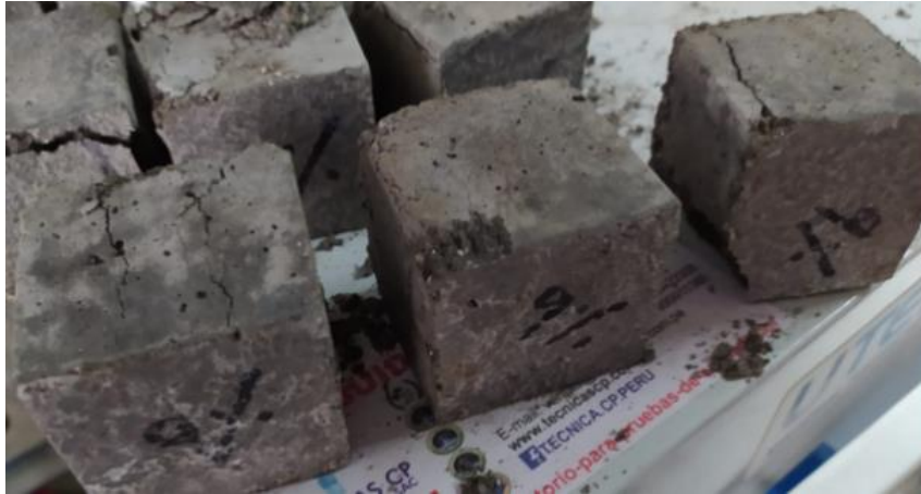
Figura 41 Rotura en la muestra experimental con 9% de ceniza en el periodo de 7 días.
