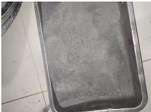
Figura 30. Almacenamiento de bagazo de caña de azúcar recalcinada.
