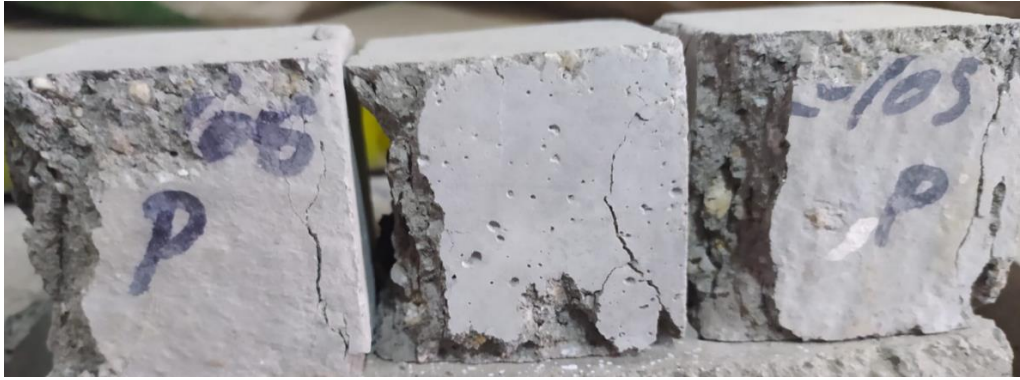
Figura 60 Rotura de la muestra patrón en el periodo de 28 días.
