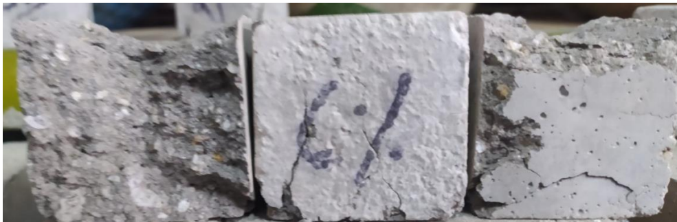
Figure 62 Rotura de la muestra experimental adicionando 6% de ceniza de caña a los 28 días.
