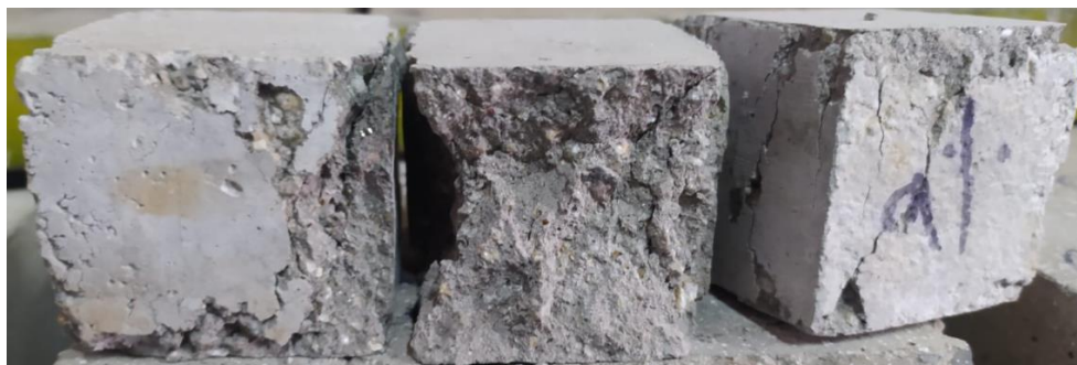
Figura 63 Rotura de la muestra experimental adicionando 9% de ceniza de caña a los 28 días.
