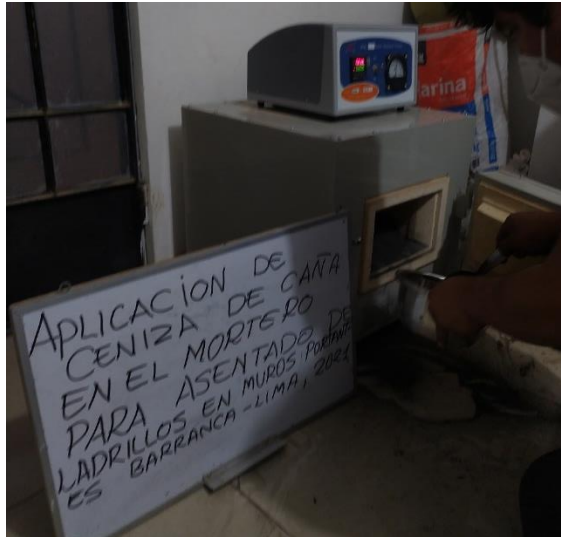
Figura 27 Recalcinación de a ceniza en el horno.
