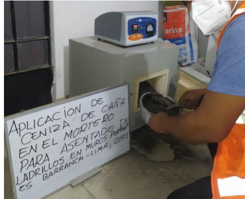
Figura 6 Ignición de las cenizas de bagazo de caña de azúcar
