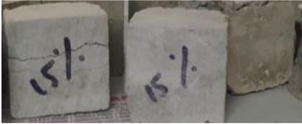
Figura 64 Rotura de la muestra experimental adicionando 15% de ceniza de caña a los 28 días.
