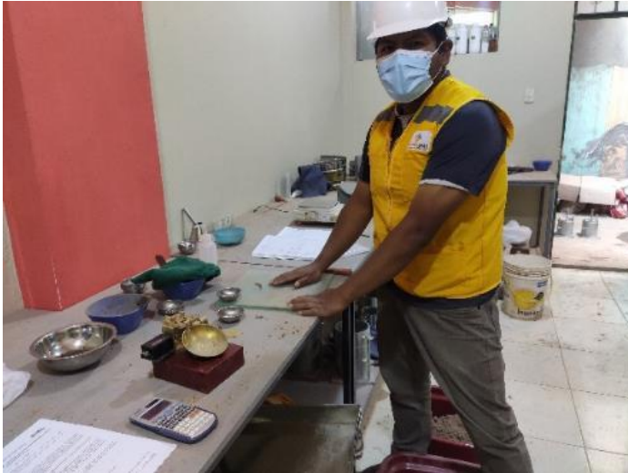
Figura 33. Moldeado de la muestra en forma cilíndrica de 3mm de diámetro
