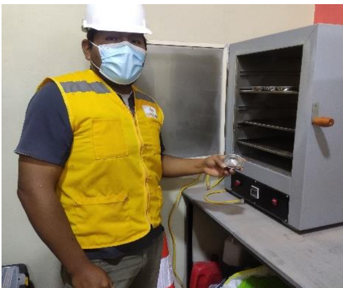
Figura 32. Colocado del material al horno para su secado
