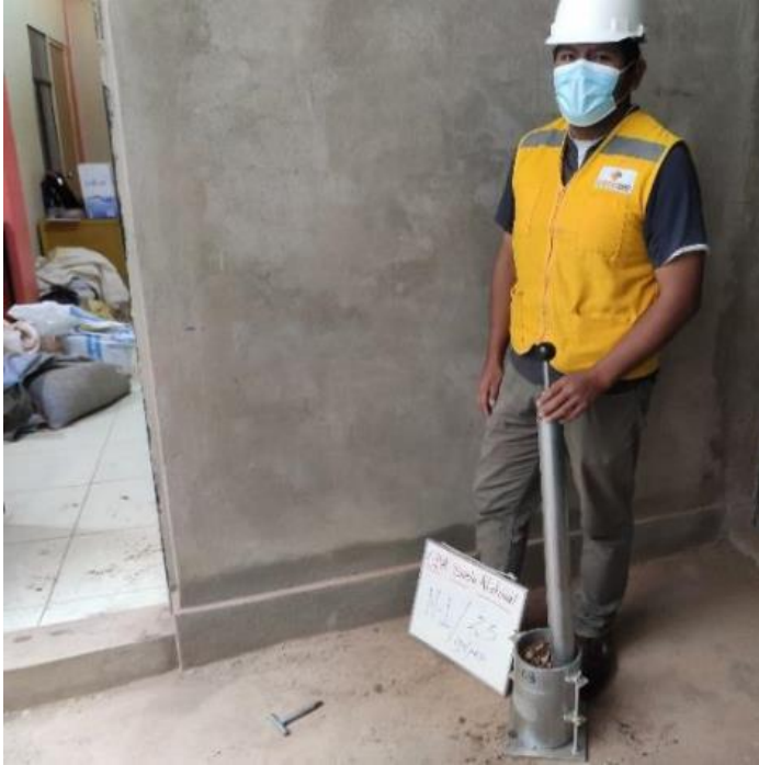
Figura 36. Proceso de compactado de la muestra por capas
