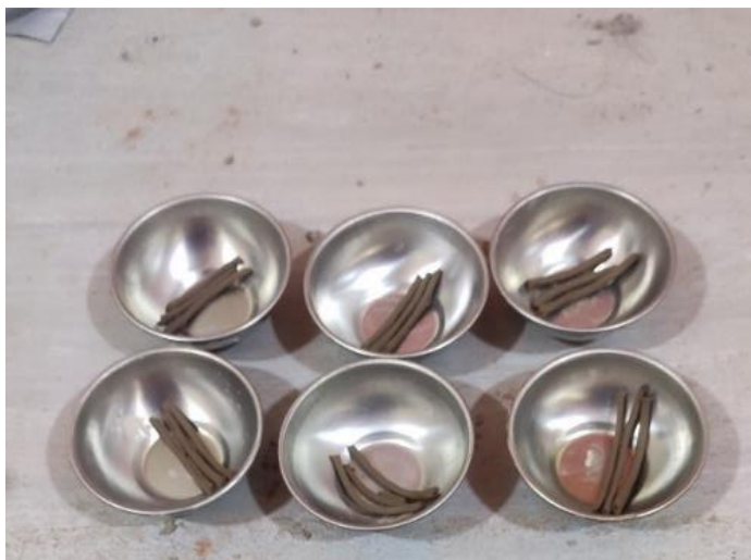
Figura 34. Toma de muestras cilíndricas de 3mm de diámetro
