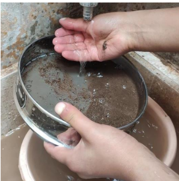
Figura 26. Lavado de la muestra en el tamiz N°200
