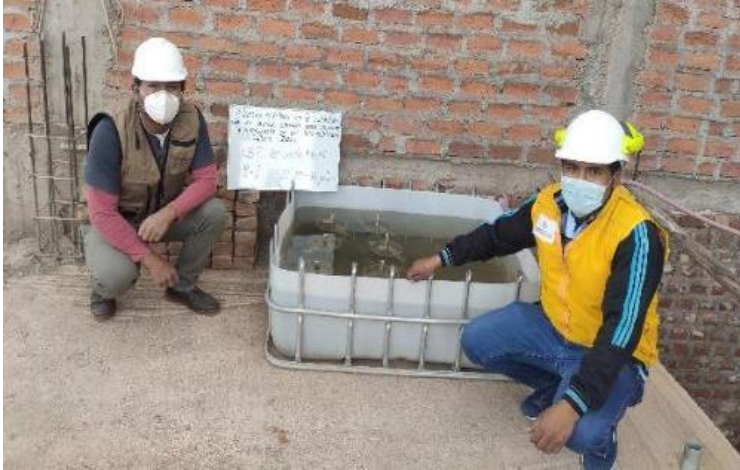
Figura 38. Sumergido de moldes CBR suelo natural M-1 con 12-25-56 golpes
