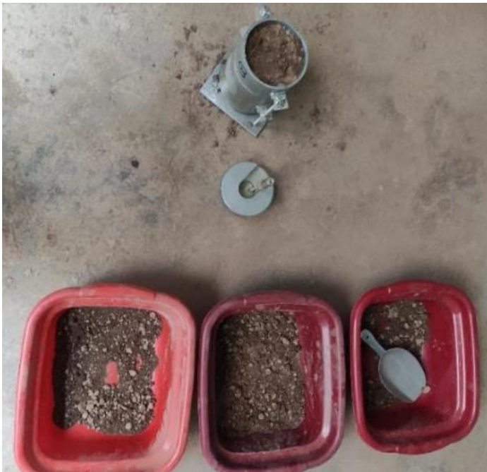
Figura 35. Toma de muestras para el ensayo proctor modificado.
