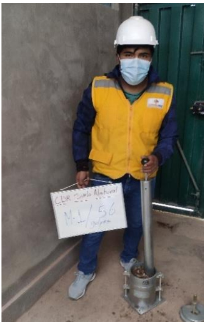
Figura 37. Procedimiento del CBR con 56 golpes
