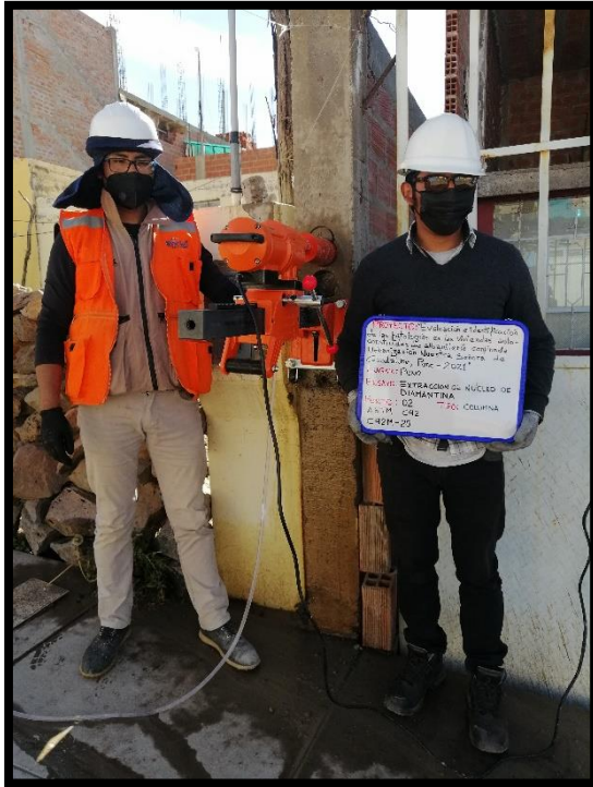
Fotografía 23 y 24: Realizando el ensayo de extracción de núcleos diamantinos en elementos estructurales en columna.
