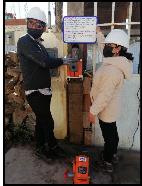
Fotografía 23 y 24: Realizando el ensayo de extracción de núcleos diamantinos en elementos estructurales en columna.
