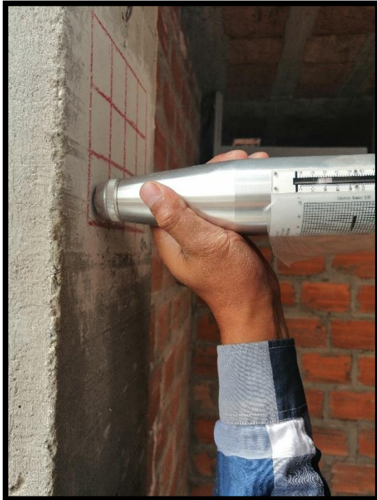
Fotografía 15 y 16: Realizando el ensayo esclerométrico en elementos estructurales en viga y columna.
