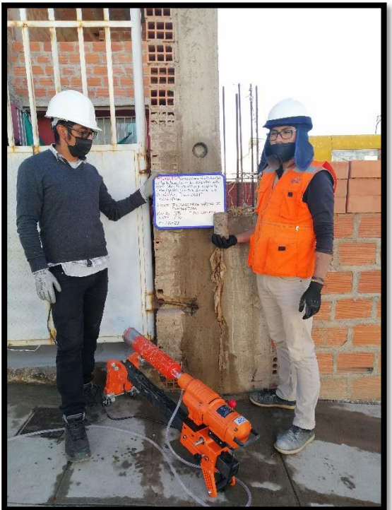
Fotografía 25 y 26: Realizando el ensayo de extracción de núcleos diamantinos en elementos estructurales en columna.
