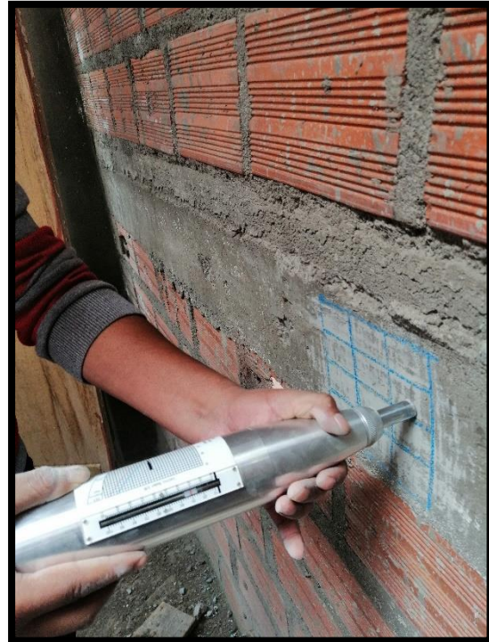
Fotografía 15 y 16: Realizando el ensayo esclerométrico en elementos estructurales en viga y columna.
