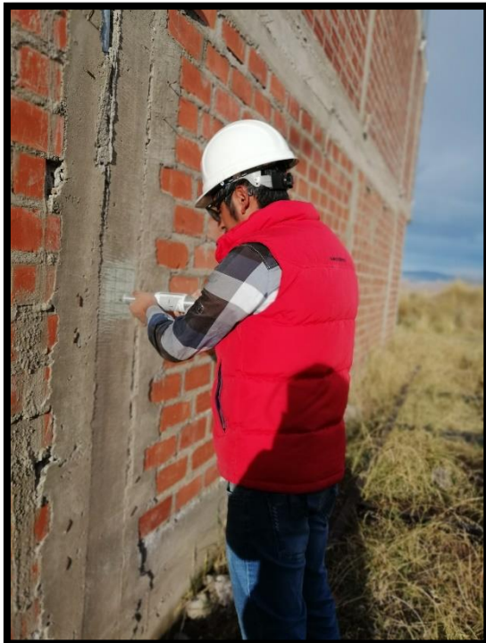
Fotografía 17 y 18: Realizando el ensayo esclerométrico en elementos estructurales en columna.
