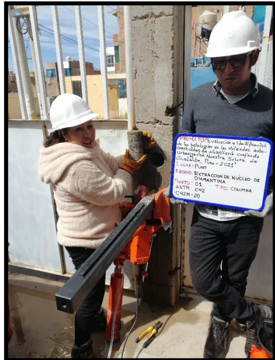
Fotografía 21 y 22: Realizando el ensayo de extracción de núcleos diamantinos en elementos estructurales en columna.
