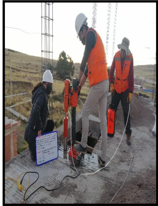
Fotografía 27 y 28: Realizando el ensayo de extracción de núcleos diamantinos en elementos estructurales en columna y viga.
