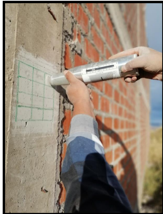
Fotografía 17 y 18: Realizando el ensayo esclerométrico en elementos estructurales en columna.
