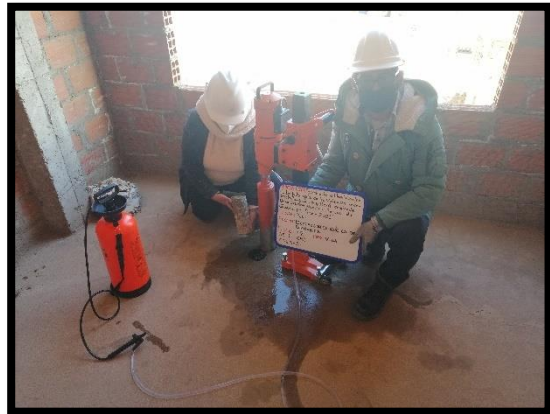
Fotografía 29 y 30: Realizando el ensayo de extracción de núcleos diamantinos en elementos estructurales en columna y viga.
