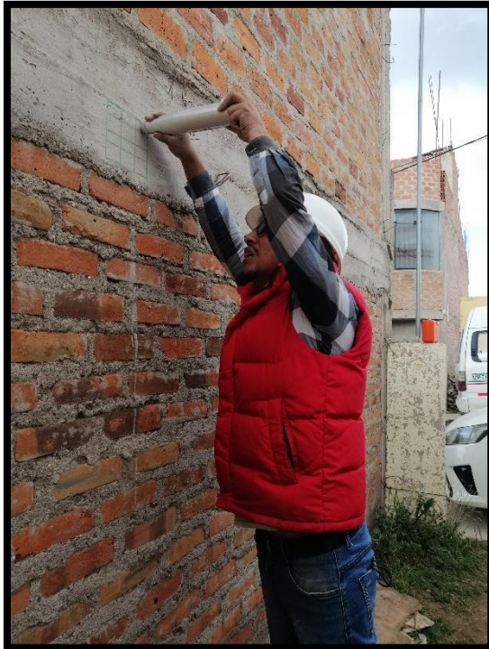
Fotografía 19 y 20: Realizando el ensayo esclerométrico en elementos estructurales en viga y columna.
