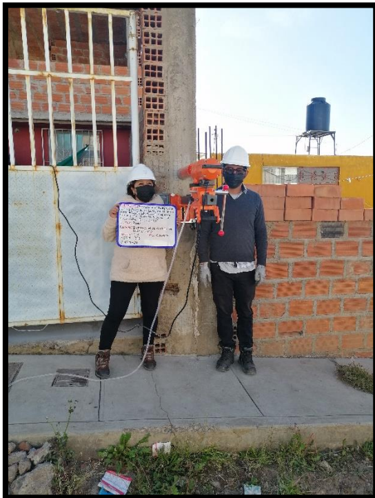
Fotografía 25 y 26: Realizando el ensayo de extracción de núcleos diamantinos en elementos estructurales en columna.
