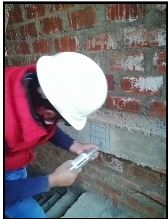
Fotografía 13 y 14: Realizando el ensayo esclerométrico en elementos estructurales en columna y viga.
