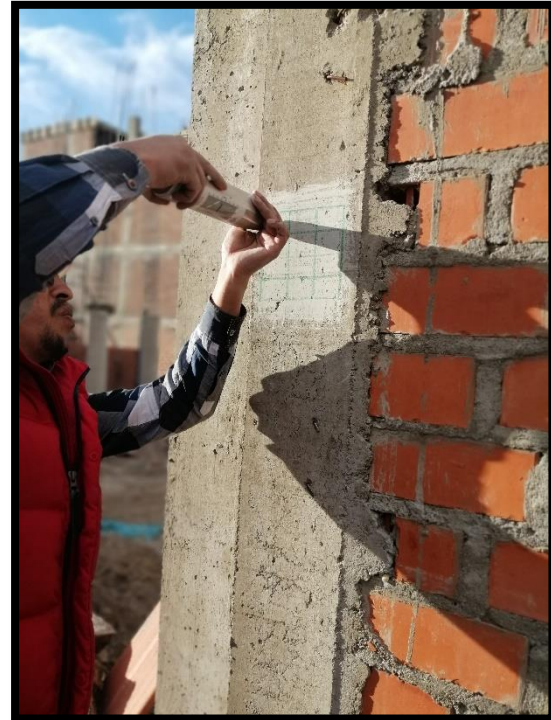
Fotografía 19 y 20: Realizando el ensayo esclerométrico en elementos estructurales en viga y columna.
