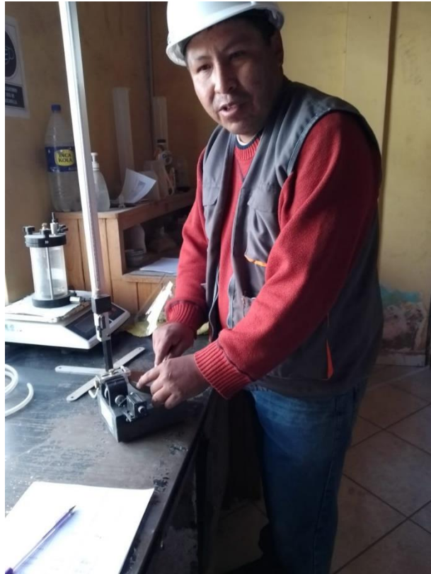
Figura 51. Ensayo de laboratorio limite liquido
