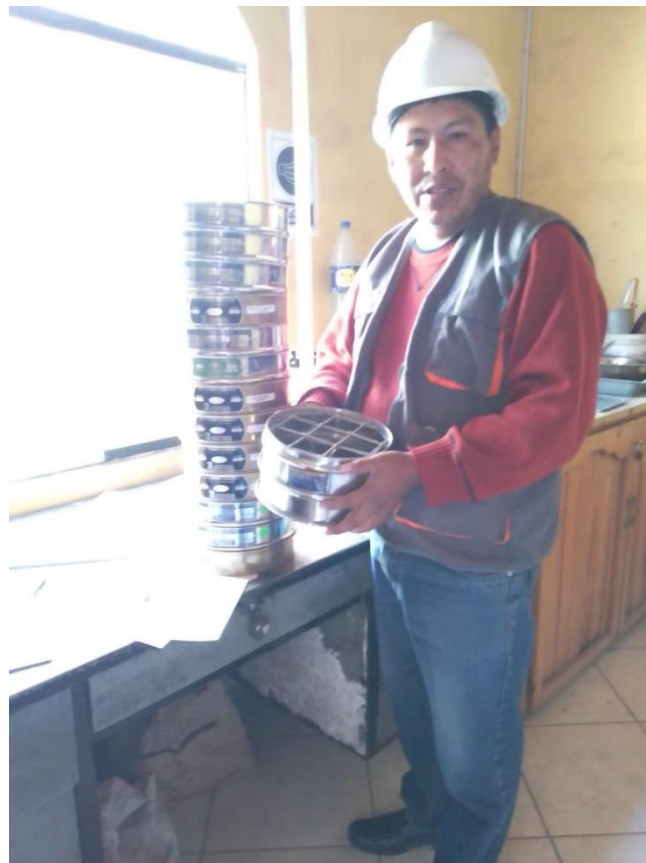
Figura 50. Ensayo de laboratorio análisis de granulometría por tamizado
