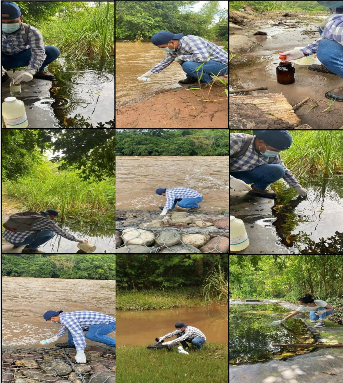
**Descripcion:** En las imágenes se pueden observar la toma de muestras de agua en los envases correspondiente para cada tipo de muestras en los puntos ya identificados.
