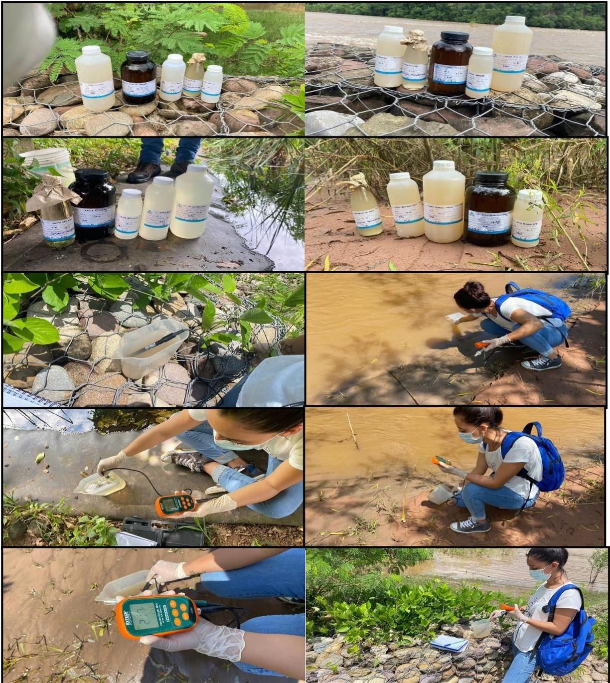
**Descripcion:** En las imágenes se pueden observar la toma de datos de parametro de campo en los puntos ya identificados y los envases con las muestras correspondientes.
