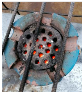
Figura 9. Cocina artesanal con 1 hornilla
