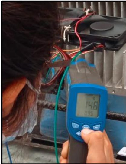
Figura 31. Temperatura del refrigerante
