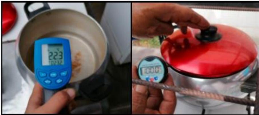
Figura 33. Medición de temperatura por convección
