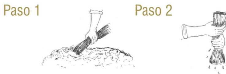
Figura 57. Pasos para la elaboración de paja barro. Fuente. Ministerio de Vivienda Construcción y Saneamiento (2014).
